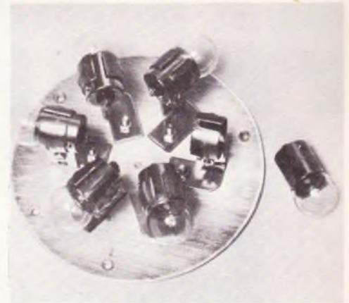
Photo 4. - Utilisation de douilles spéciales pour monter les ampoules.
