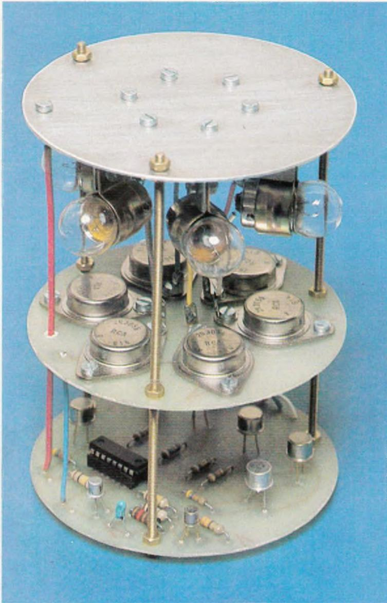
**L'**EFFET obtenu rappelle celui des gyrophares classiques utilisés par tous les services de sécurité : police, pompiers... Ceux-ci sont en général constitués d'une ampoule de forte puissance et d'un réflecteur tournant. Notre réalisation est par contre équipée de six ampoules fixes s'allumant les unes après les autres et donnant une impression identique à celle d'un faisceau tournant.
