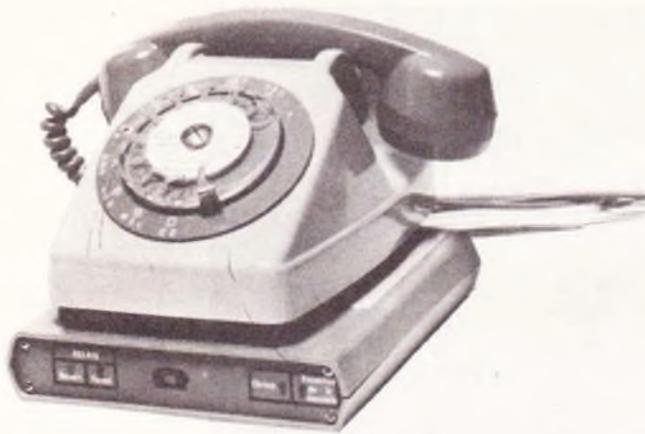
son couvercle, avec une grille d'aération en face du micro, afin de permettre un captage facile du son émis par la sonnerie du téléphone. De plus, son encombrement en hauteur est vraiment réduit à sa plus faible valeur : moins de 40 mm, si bien qu'il a été nécessaire de prévoir une découpe dans le circuit imprimé afin de coller directement le transformateur sur le fond du boî-
