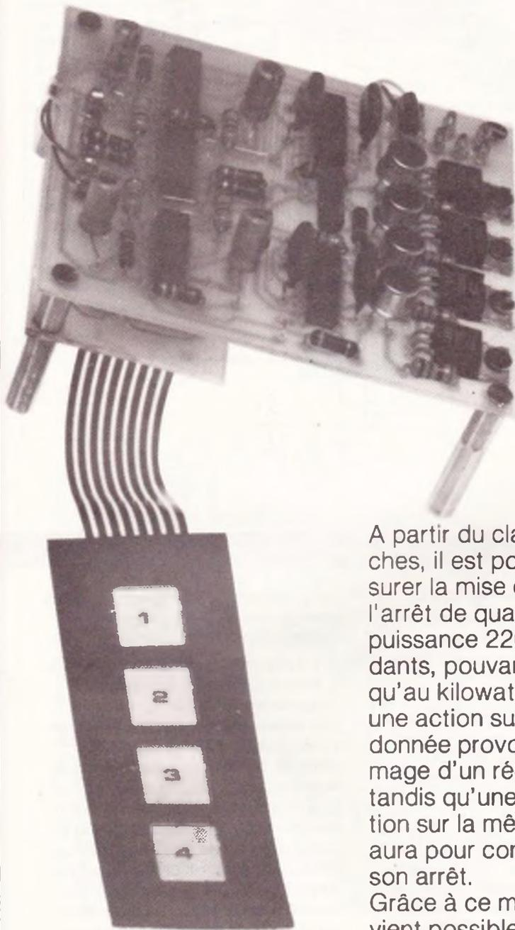
A partir du clavier 4 touches, il est possible d'assurer la mise en marche ou l'arrêt de quatre circuits de puissance 220 V indépendants, pouvant aller jusqu'au kilowatt chacun ; une action sur une touche donnée provoquera l'allumage d'un récepteur tandis qu'une seconde action sur la même touche aura pour conséquence son arrêt.
