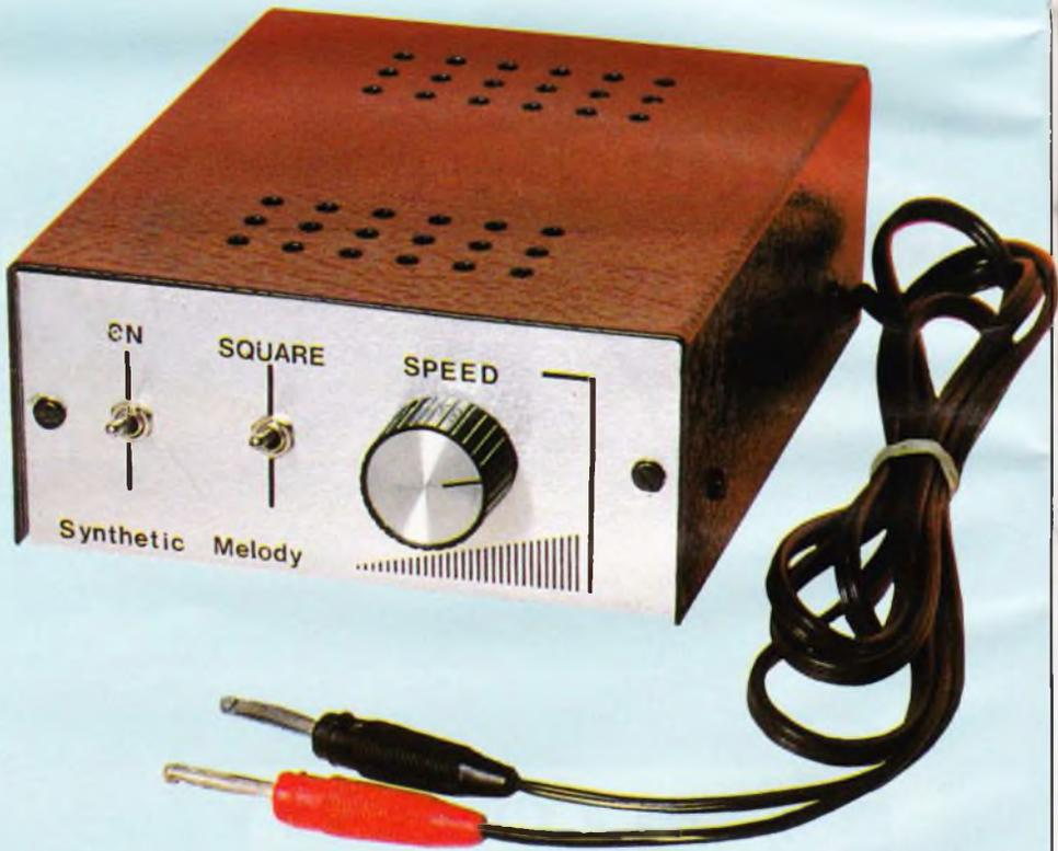
clavier d'instrument, il sera possible d'obtenir une variation de la fréquence de sortie du grave à l'aigu, et inversement. Le circuit intégré XR 2207 réalise précisément cette fonction primordiale pour notre réalisation.
