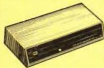
Quand il vous est impossible d'intervenir au niveau même de votre antenne (déjà au maximum d'éléments ou inaccessible, très en hauteur) ou que l'antenne collective de votre immeuble vous fournit un signal bien trop faible pour 1 ou 2 téléviseurs, cet ampli s'installe près du téléviseur, s'alimente en 220 V, gain 26 à 24 dB entre 40 et 890 MHz (tous canaux + FM), impéd. d'entrée et sortie 75 ohms, niveau max. 100 dB/μV. Dim. 224 x 52 x 110 mm. Réf. DX ..... 385 F
