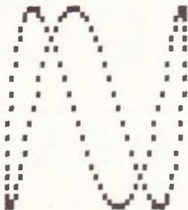
Le nombre des points de tangence correspond précisément au rapport des fréquences. En outre, il est important de noter que le déphasage entre les signaux provoque également une déformation de l'image obtenue.
