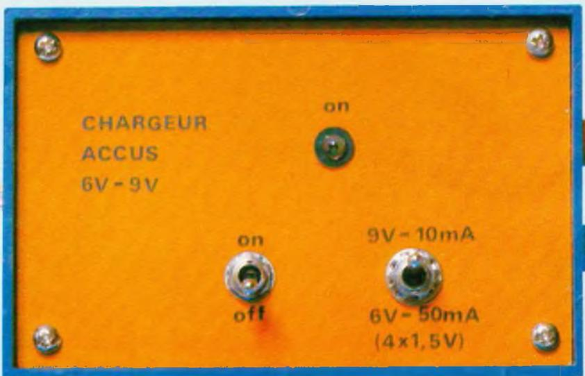
Photo 3. - Détails de la face avant.
