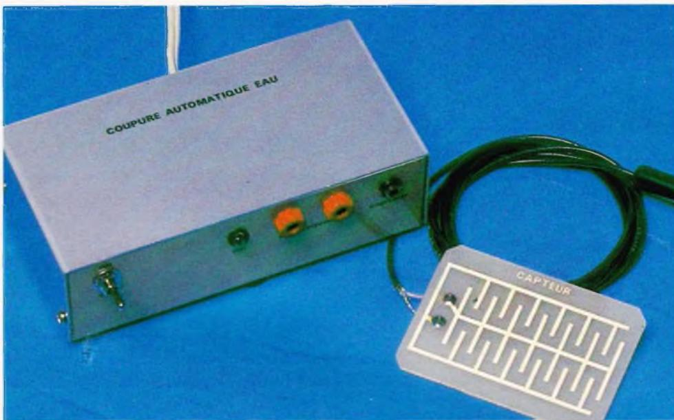
**E**n effet, la machine à laver ou le lave-vaisselle n'ont pas obéi au programmateur ou aux capteurs qui, d'habitude, fonctionnent normalement. Le montage que nous vous proposons détecte la moindre fuite et coupe l'arrivée d'eau par l'intermédiaire d'une électrovanne auxiliaire.
