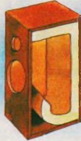
Installez le filtre et le câblage à l'intérieur de l'enceinte. Positionnez les haut-parleurs dans leurs ouvertures respectives et pratiquez des avant-trous pour faciliter la pénétration des vis de fixation.
