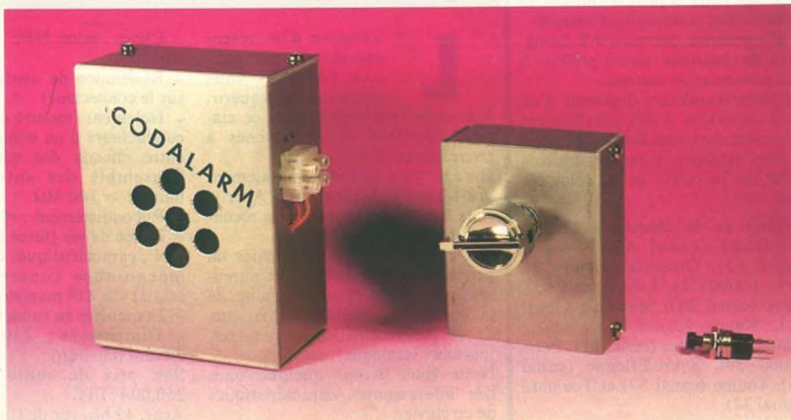
**L**à, il suffit de « brouiller » le code, de 1 à 12, d'un rotacteur dont le bouton se trouve près de la poignée : toute ouverture avec un mauvais code (11 « chances » sur 12...) déclenchera une alarme sonore pendant vingt secondes, même si l'indélicat referme précipitamment cette porte ou tiroir.
