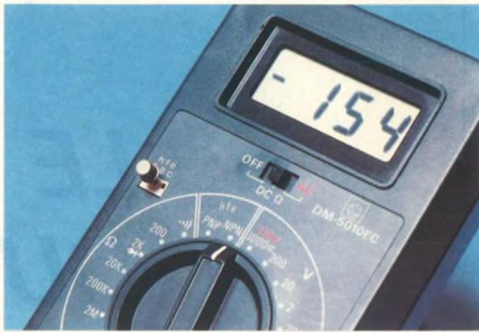
Photo 5. – L'appareil teste ici un transistor, qui offre un gain en courant de 154.
