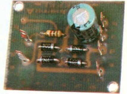
Photo 3. - Le module alimentation comprenant le pont redresseur, à diodes, et la capacité de filtrage.
