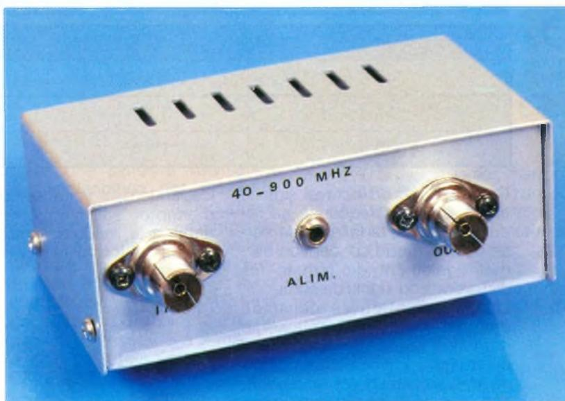
d'amplifier sélectivement un groupe de canaux comme les canaux allant de 21 à 33 en T.V. sur Paris ou de 88 à 108 MHz en F.M. sur la France. Pour ce faire, un filtre d'entrée et un filtre de sortie ont été disposés afin de limiter la bande inférieure et la bande supérieure de sortie, et ce, avec un facteur d'atténuation de 60 dB/décade. Cela signifie en clair que lorsque la fréquence devient dix fois plus faible ou dix fois plus forte que la fréquence
