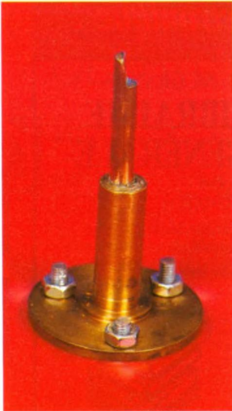
Photo 6. – Détail de l'axe d'entraînement du plateau.
