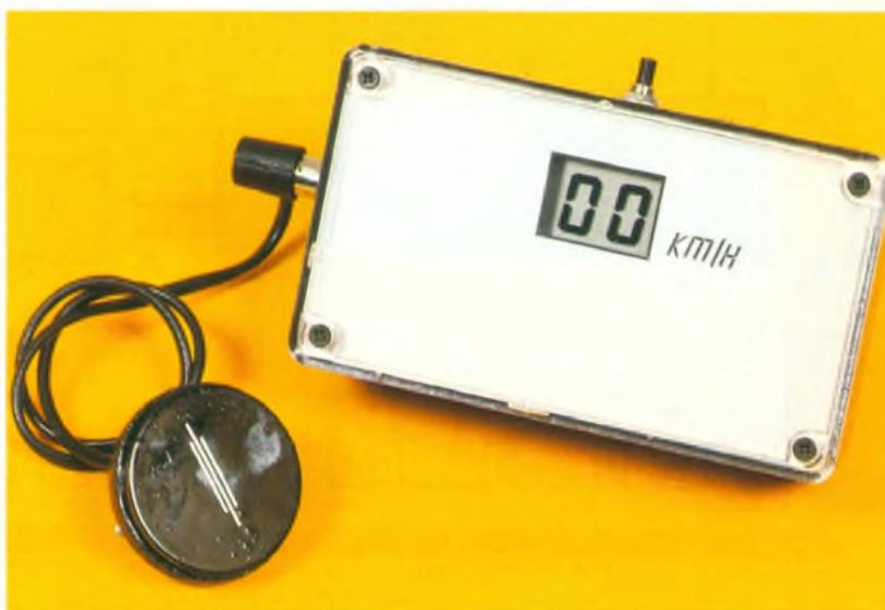
en œuvre d'un capteur magnétique sensible au défilement des rayons de la roue avant ou arrière, sans aucun contact matériel.
