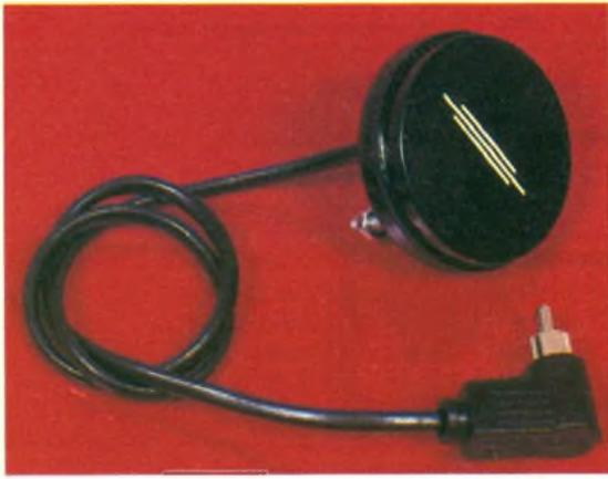
Photo 6 – Le capteur magnétique composé d'une bobine de 400 à 500 spires jointives.
