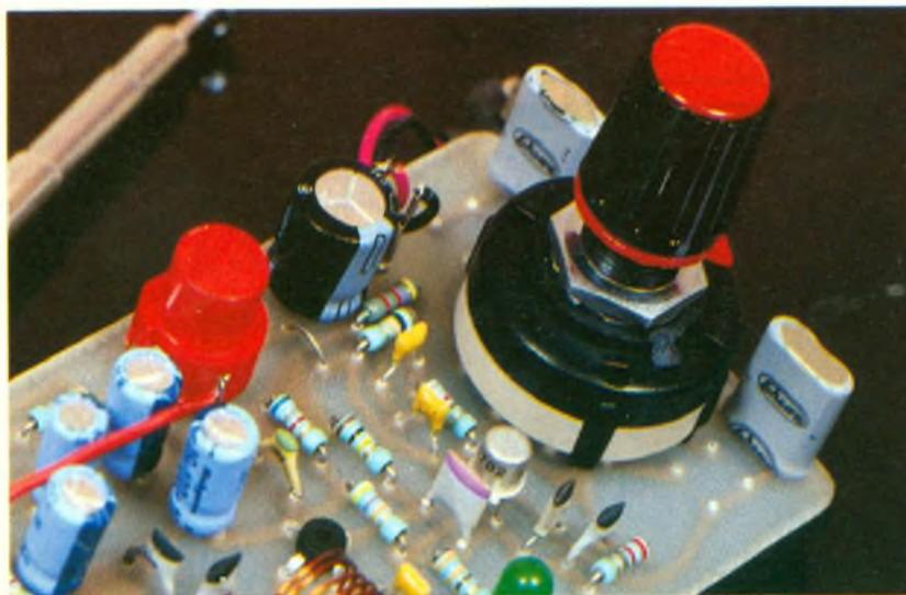
Photo 4 – Le rotacteur au fond permet la sélection de l'un des six canaux.
