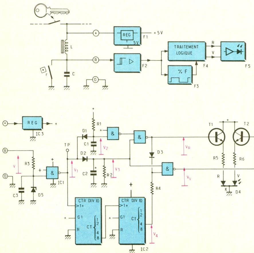
1-2 Schéma fonctionnel/schéma électronique développé : la remise en forme passe par un écrêtage des signaux disponibles aux bornes du rupteur (réseau R3-C3-d5).
