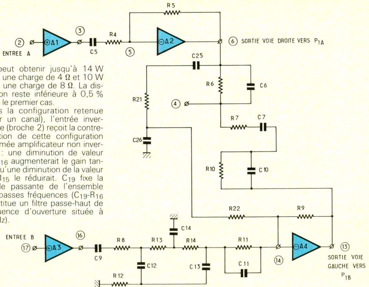
on peut obtenir jusqu'à 14 W avec une charge de 4 Ω et 10 W avec une charge de 8 Ω. La distorsion reste inférieure à 0,5 % dans le premier cas.
