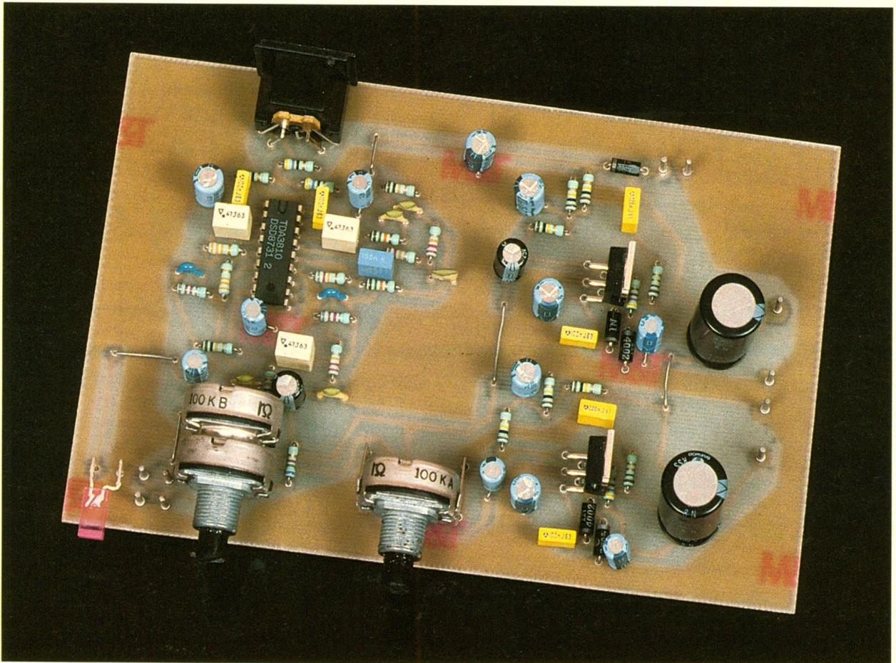
Il s'avère cependant intéressant de disposer d'un confort d'écoute minimal lors de retransmissions télévisées de spectacles et autres. Ainsi avons-nous conçu cette platine qui viendra se connecter sur la prise Péritel. Celle-ci dispose :
