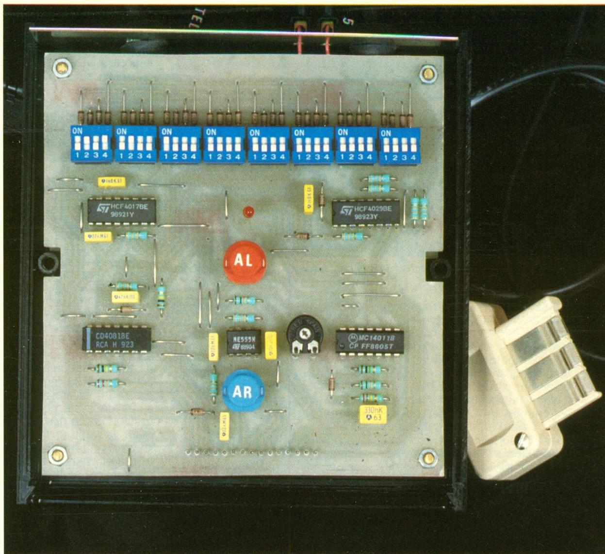
Photo 2. – La platine supérieure de l'alarme.
