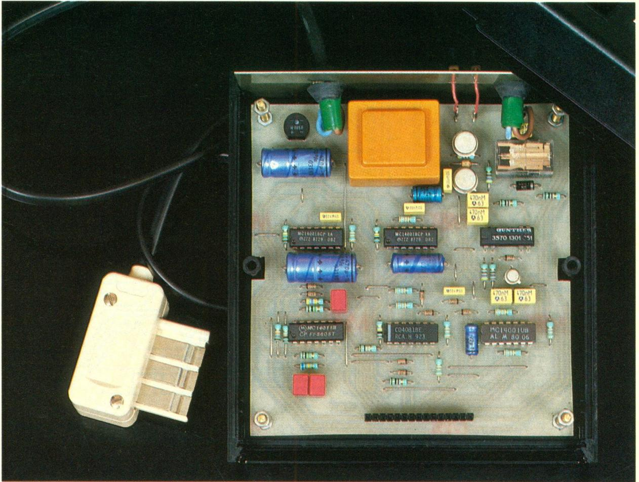
Photo 4. – Le transformateur moulé (en orange) s'insère directement sur la platine parmi les composants.
