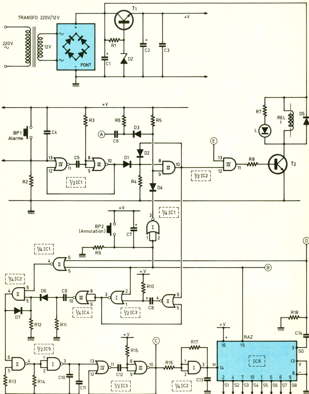
porte AND, même si elle est très brève, a pour effet immédiat la remise à zéro de la sortie de la porte. Ce phénomène se réalise en particulier lorsque le système dérivation constitué par C<sub>6</sub>, les résistances R<sub>5</sub>/R<sub>6</sub> et la diode D<sub>3</sub> décèle un front descendant au point A du montage. Nous ver-
