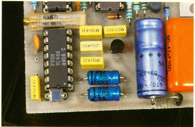
Photo 5. – Au premier plan, sur la gauche, se situent le photorécepteur I.R. et le circuit de traitement SL 486.
