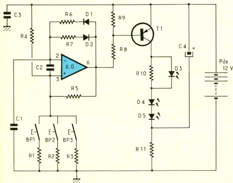
**3** Schéma de principe d'un astable à A.O.P. : e+ est portée tour à tour au potentiel +Vseuil et -Vseuil, selon l'état de la sortie.
