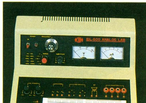
Photo 3. – Aperçu des deux galvanomètres mesurant la tension et le courant (V et μA).
