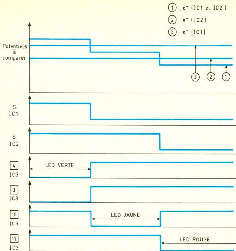
Ces trois sorties sont reliées aux trois bases des transistors PNP T<sub>2</sub> à T<sub>4</sub> par l'intermédiaire des résistances de limitation R<sub>9</sub>, R<sub>10</sub> et R<sub>11</sub>. Les transistors comportent dans leur circuit collecteur les LED L<sub>1</sub>, L<sub>2</sub> et L<sub>3</sub> qui se caractérisent respectivement par une couleur verte, jaune et rouge. Leur courant est limité par la résistance R<sub>12</sub>.
