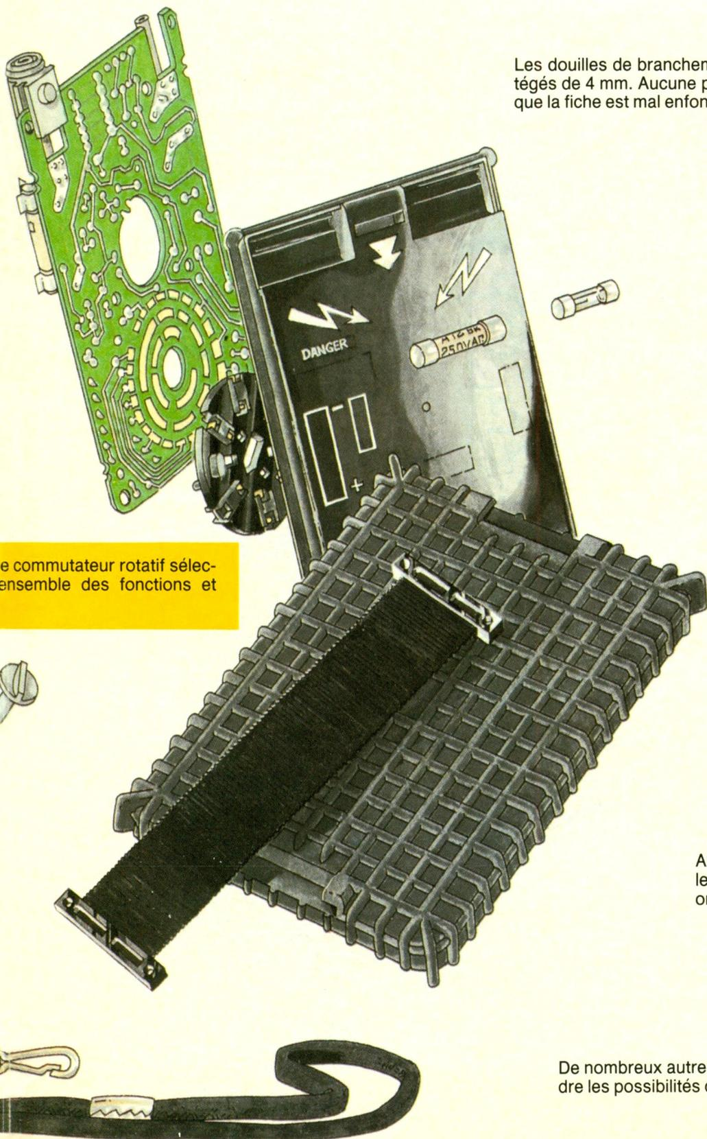
Le commutateur rotatif sélectionne l'ensemble des fonctions et
