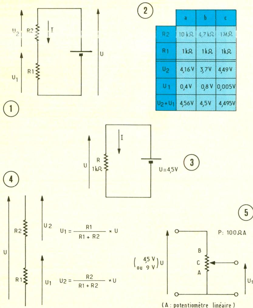
1  $U = U_1 + U_2$ . 2 Mesures de tension. 3 Loi d'Ohm par la pratique. 4 Calcul de  $U_1$  et  $U_2$ , sans calculer  $I$ .
