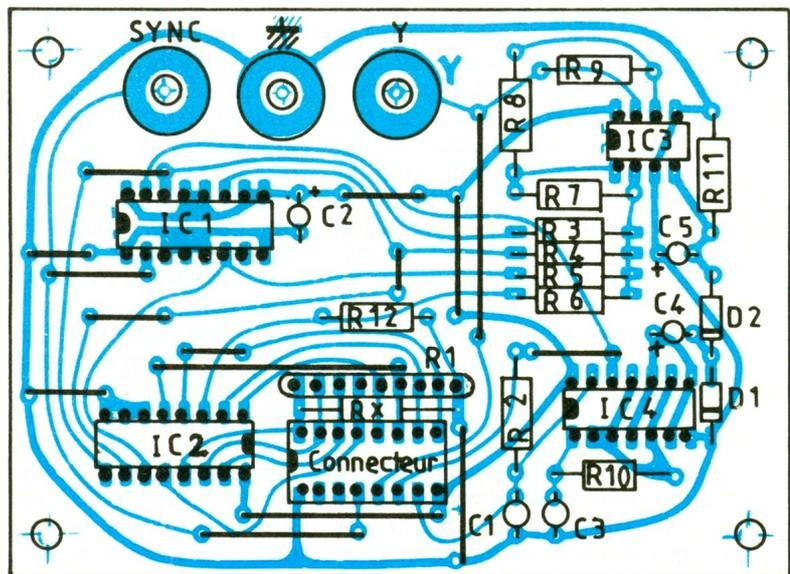
gnal est complété sur les broches 4, 6, 8, 10. Sauf erreur de câblage des diodes, vous mesurez une tension proche de -8 V sur la broche 3 du support de  $IC_3$ , avec une faible ondulation résiduelle. L'alimentation -  $V_{cc}$  est correcte.
