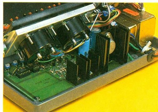
Photo 2. – Les alimentations du pupitre nécessitent la mise en place de radiateurs sur les régulateurs, pour fin de refroidissement.
