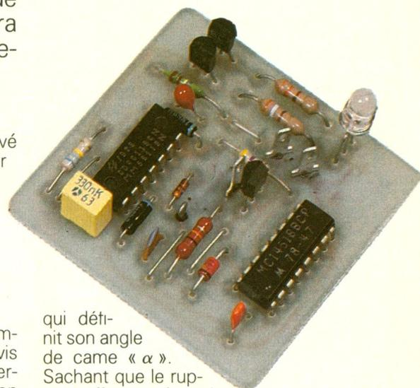
qui définit son angle de came «  $\alpha$  ». Sachant que le rupteur effectue 4 cycles pour un moteur 4 cylindres, l'angle sera défini par une fraction de  $360^\circ/4 = 90^\circ$  ( $60^\circ$  pour un six cylindres...). On peut considérer la commande de r comme un signal logique dont on définit le rapport cyclique, soit  $\alpha/90^\circ$ . Exemple :  $\alpha = 62^\circ$ , rapport cyclique  $62/90 = 0,68$ .
