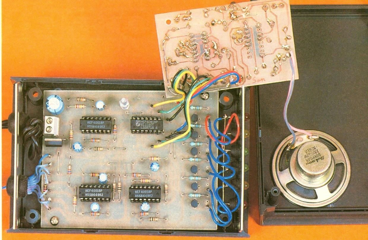
Photo 4. – Aperçu de quatre C.I.-CMOS bon marché et du haut-parleur fixé sur la face supérieure du coffret.
