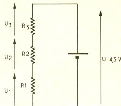
La figure 8 présente le montage alimenté sous une tension  $U = 4,5\ V$ , où 3 résistances sont branchées en série :  $R_1 = 10\ k\Omega$ ,  $R_2 = 1\ k\Omega$ ,  $R_3 = 4,7\ k\Omega$ .
