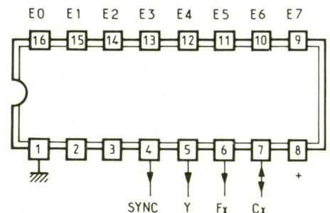
Insérez  $IC_1$  dans le support. Vérifiez un signal carré sur les broches 11, 10 et 9 du support de  $IC_2$ . La fréquence est égale à la fréquence en  $F_x$  divisée par 2, 4, 8 respectivement. Le séquenceur fonctionne.
