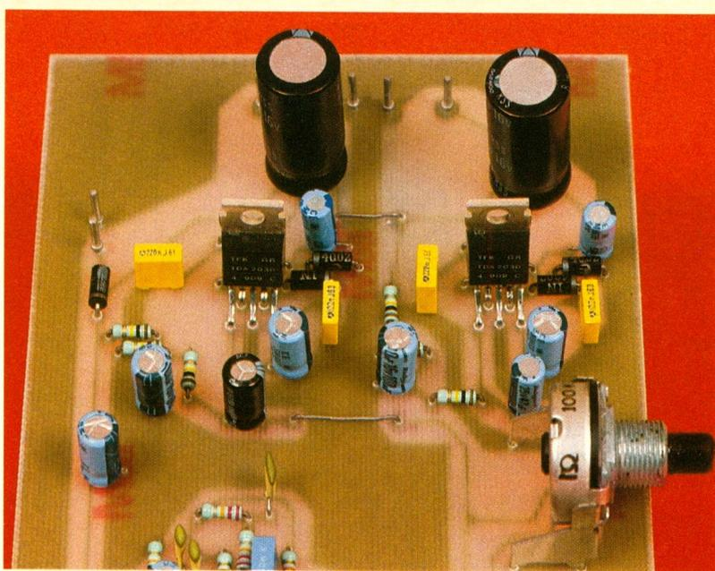
Photo 3. – Vue des deux C.I. amplificateurs et des capacités radiales de sorties.
