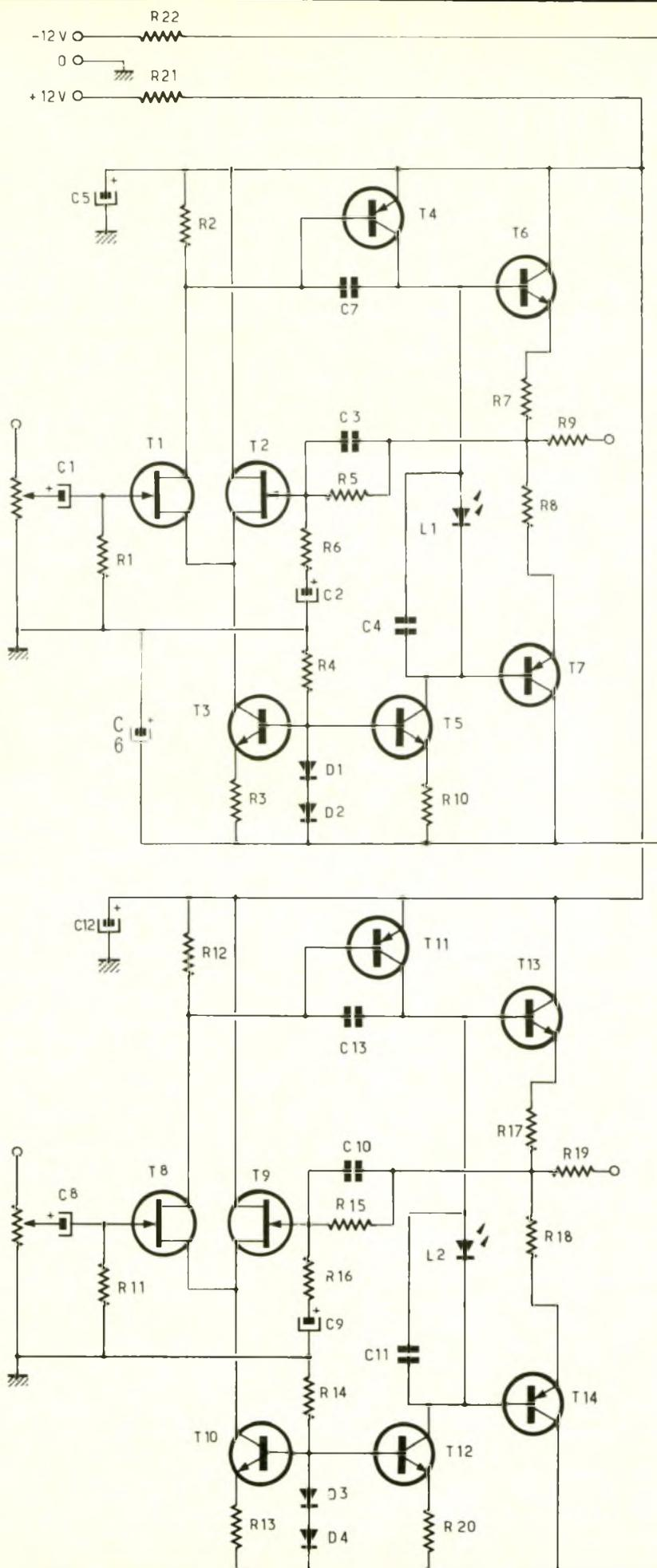
Le gain en tension est déterminé par le rapport  $R_5/R_6$ . Il est lui aussi indépendant de l'alimentation. Nous l'avons fixé à 10, ce qui permet d'amplifier dans de bonnes conditions tous niveaux « ligne » (magnétophone, CD, table de mixage, etc.) Le condensateur  $C_2$ , en constituant une barrière pour le courant continu de sortie, fixe le gain en tension continue à 1. En l'absence de ce condensateur, la tension d'offset d'entrée se retrouverait à la sortie multipliée par 10.
