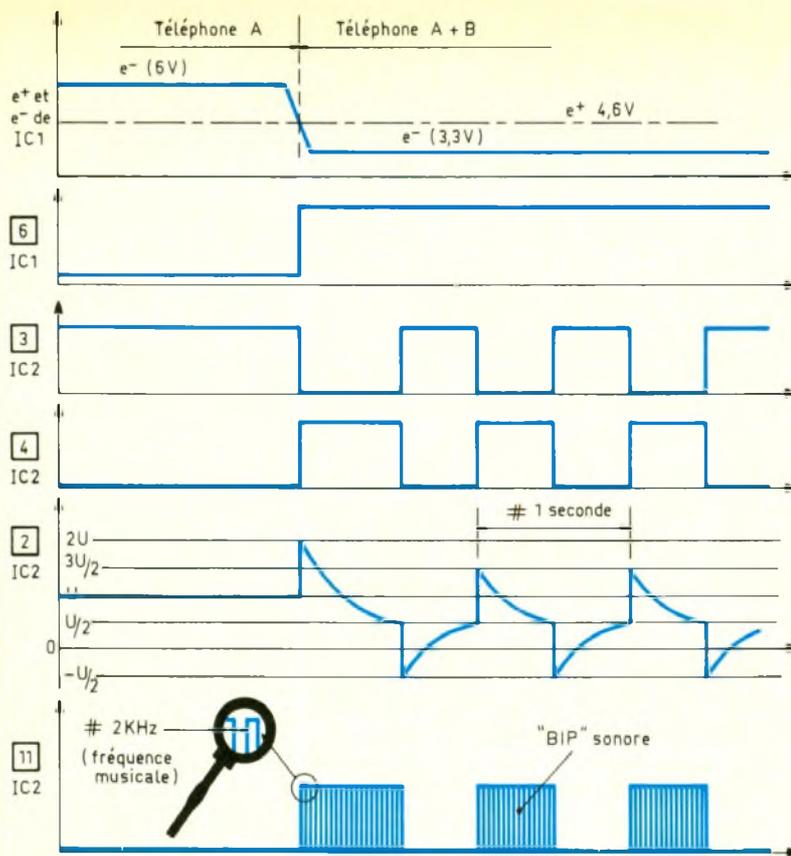
Ainsi, lorsque l'on appuie sur le bouton-poussoir, on injecte dans celles-ci des « bip-bip » au rythme du clignotement de la LED L<sub>2</sub>. La puissance de ces signaux est modulable grâce au curseur de l'ajustable A<sub>2</sub>. La figure 4 illustre les allures des signaux en divers points du montage.
