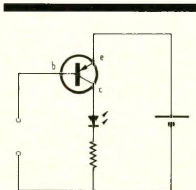
10 Le transistor PNP : expérimentation.
