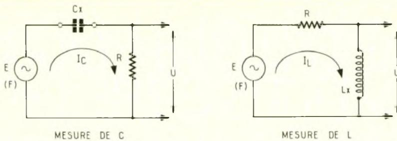
laire d'un self-étalon pour la mesure d'un condensateur. Cette méthode, précise et réaliste, est complexe à mettre en œuvre, surtout avec des éléments de faible valeur ;
