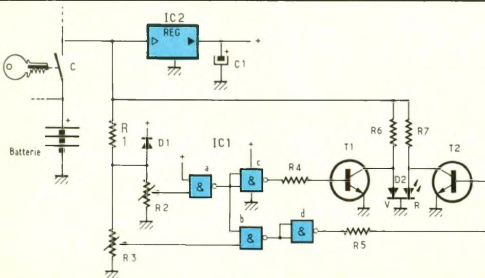
1 Utilisation des seuils de basculement de portes NAND CMOS afin de constituer des comparateurs de tension.
