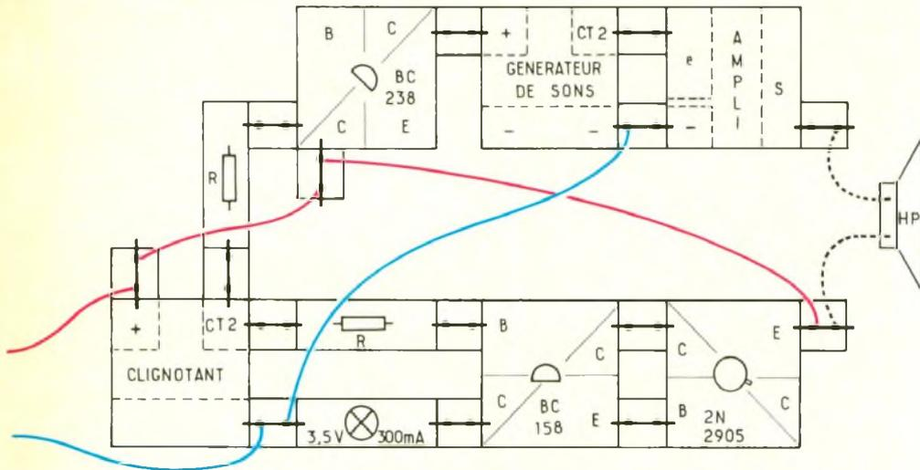
être positive (P) par rapport à l'émetteur (N) pour qu'un transistor NPN devienne passant. Pour un transistor PNP, les polarités s'inversent, il faut donc que sa base puisse devenir négative (N) par rapport à l'émetteur (P).
