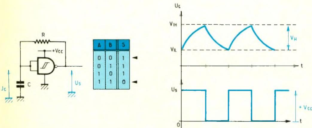
bornes atteint  $V_{IH}$ . A cet instant, le niveau logique est considéré comme égal à 1, sur les deux entrées (puisque celles-ci sont reliées entre elles). La sortie fournit alors un niveau bas ( $U_S = 0\text{ V}$ ). Le condensateur peut donc se décharger à travers R jusqu'à atteindre  $V_C = V_{IL}$ , qui sera considéré comme un niveau logique 0 par les entrées. La porte rebasculera et le cycle se poursuivra ainsi indéfiniment.
