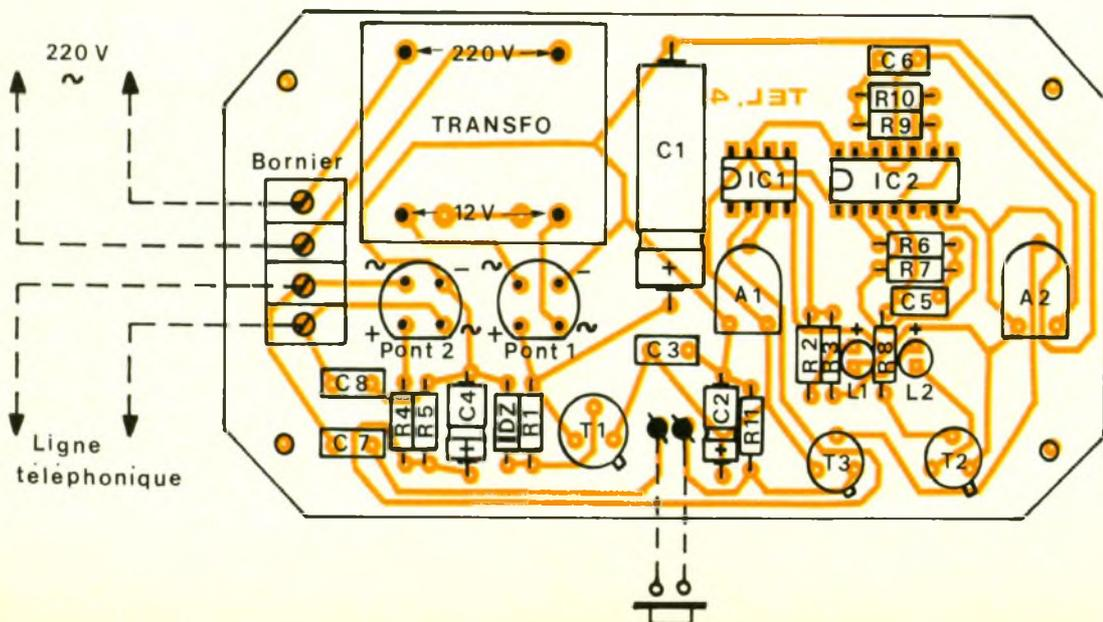
Après gravure dans un bain de perchlorure de fer, le module sera soigneusement rincé. Toutes les pastilles seront alors à percer à l'aide d'un foret de 0,8 mm de diamètre. Certains trous, destinés à des composants plus volumineux tels les borniers, le transformateur ou les grosses capacités, seront à agrandir suivant le diamètre des composants.
