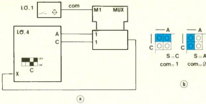
dance  $M_1$  (sans complémentation), il agit de la même manière. La figure 8a présente le symbole équivalent de la fonction, alors que la figure 8b indique la représentation pour un circuit qui intègre quatre fonctions multiplexage, avec un signal de commande commun ; dans ce cas, il est inutile de répéter '1' et '1'.
