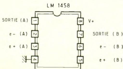
**1a** Brochage du double amplificateur opérationnel utilisé.
