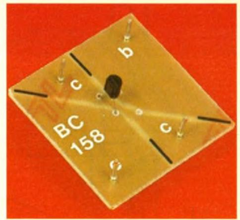
Photo 2 - Vue du circuit imprimé recevant le transistor petits signaux PNP BC 158.
