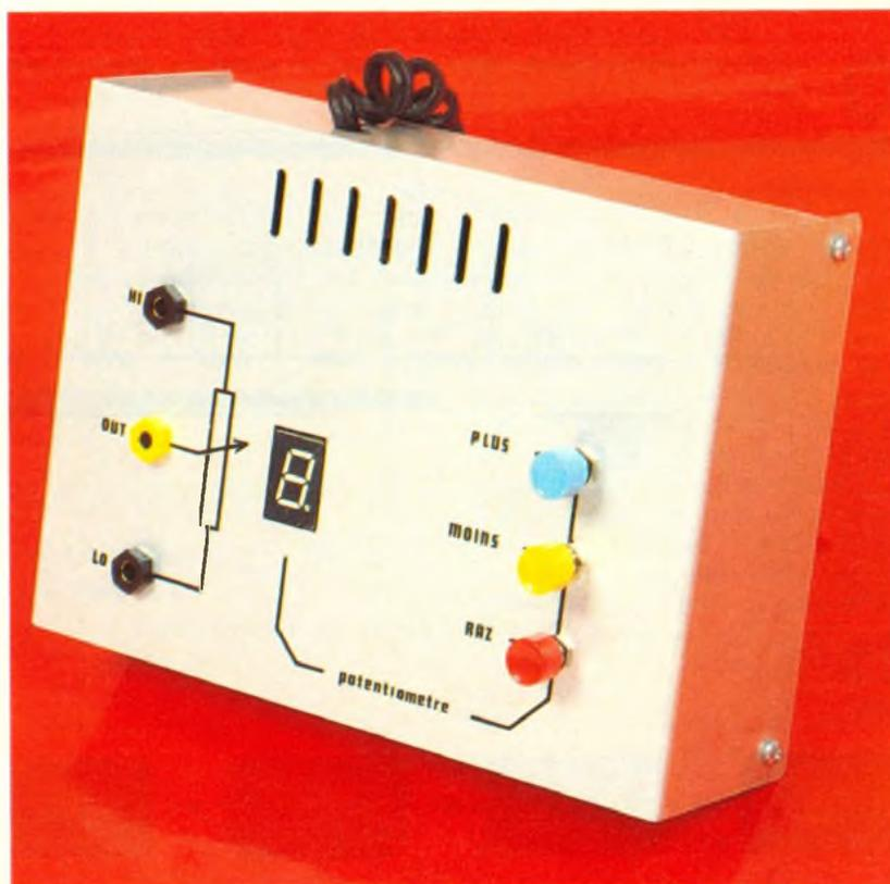
Un autre point est capital, et sera traité par notre maquette : lorsque le potentiomètre est à son niveau le plus bas, il ne doit pas être possible de « sauter » à la valeur la plus haute ou, inversement, un volume maximal ne doit pas précéder une chute brutale vers la valeur suivante.
