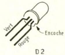
Pour la dernière combinaison,  $1\phi$ , seul  $T_1$  est saturée, inhibant ainsi la DEL verte, et la couleur obtenue est le rouge. Les résistors  $R_6$  et  $R_7$  assurent la polarisation des DEL lorsque les transistors sont bloqués ; comme l'alimentation des DEL est prise sur la tension mesurée, l'éclairement variera légèrement avec la tension, ce qui complète la mesure logique en fournissant une information analogique sommaire.
