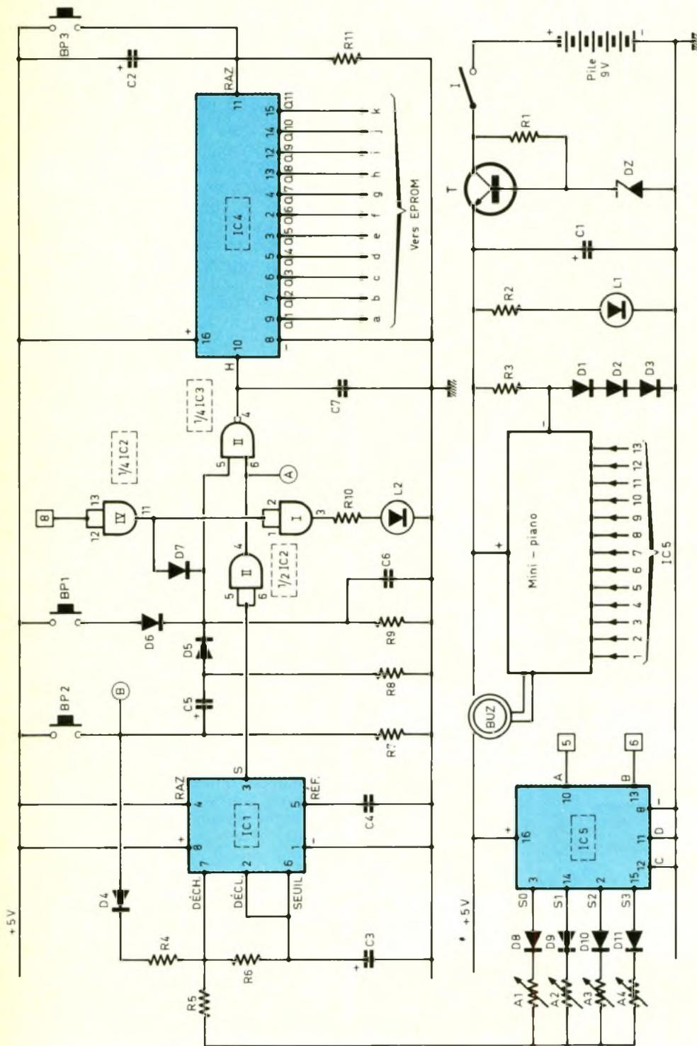
d'un dispositif de contrôle adapté. Les sorties du compteur d'adressage sont reliées aux entrées « adresses » de l'Eprom. Les sorties de l'Eprom rejoignent :
