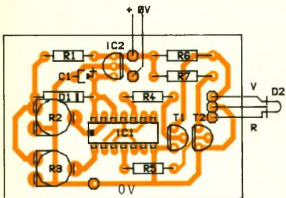
de la batterie est supérieure au maximum, un état « 1 » est présent à l'entrée des deux portes. On dispose donc de trois combinaisons logiques différentes, qui vont permettre la commande de la DEL tricolore après décodage. Les portes {a,b} interviennent avec les portes {c,d} dans le décodage.
