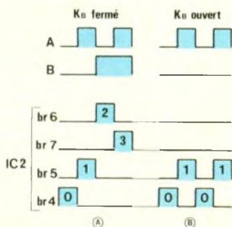
dule LO-3. Ce module sera alimenté indifféremment entre 5 V et 15 V, mais le module LO-4 est IMPÉRATIVEMENT alimenté en + 5 V (cf. volet n° 6). On dispose les signaux A, B, broches 4, 5, 6, 7 respectivement sur les entrées 7, 6, 1, 2, 4 et 3 du module LO-3 pour les visualiser dans l'ordre de la figure, avec un espace entre les signaux d'entrée et de sortie.
