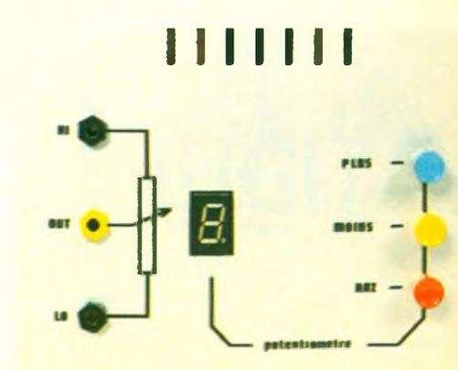
Photo 3 - Les inscriptions de la face avant pourront être réalisées à l'aide de transferts Mecanorma
