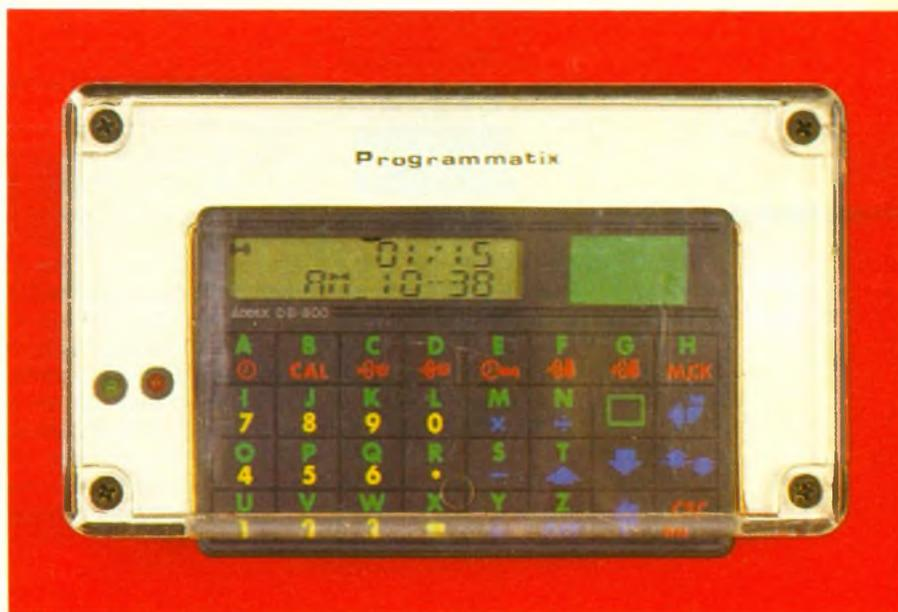
auparavant en appuyant sur la touche « arrêt ». Parallèlement, le message programmé apparaît sur l'écran. Ce message disparaît également de façon automatique après quelques minutes. A noter que la sonnerie se manifeste même si l'organiseur a été placé en position arrêt ; il est constamment en veille grâce à son dispositif de chronométrage interne.
