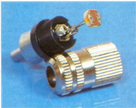
Photo 4. - Réalisation de la sonde avec sa LDR
