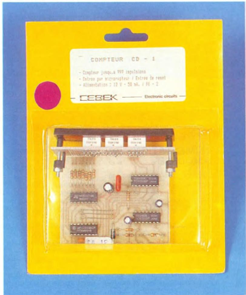
bonds des contacts du dispositif qui génère les impulsions d'entrée. L'étape suivante, constituée par le circuit intégré 4553, est un compteur décimal multi-
