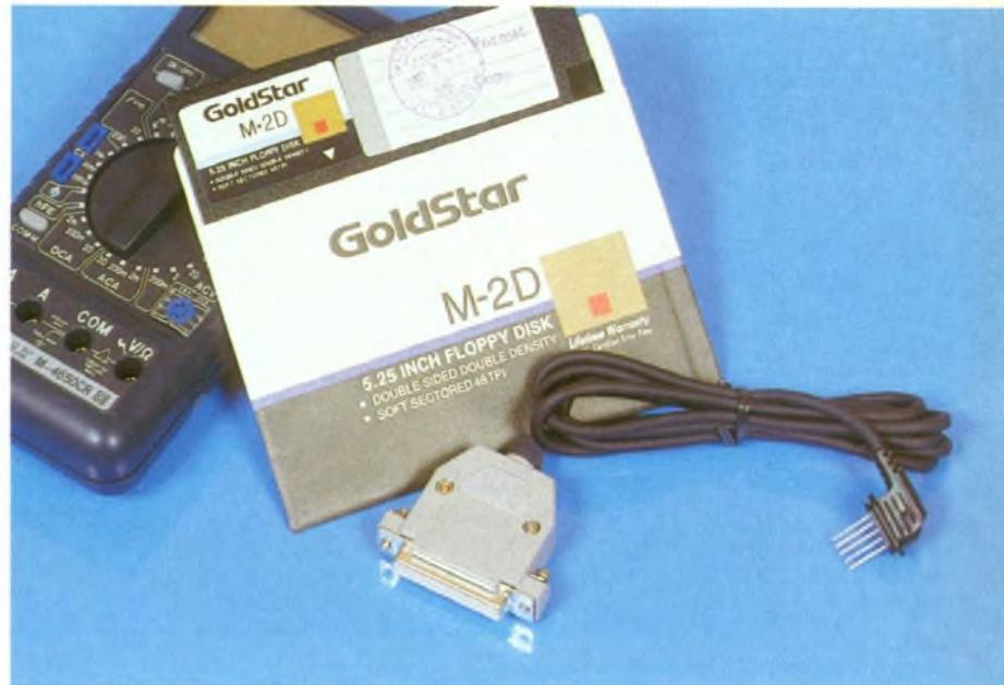
Photo 4. – La disquette livrée avec l'appareil fournit le programme pour mémoriser les données lues par le multimètre.
