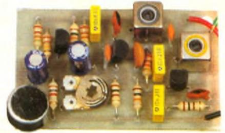
$L_2$  (attention aux couleurs) ; les condensateurs polarisés  $C_9$  et  $C_{10}$  (la polarité est indiquée sur le boîtier) ; le micro (la patte reliée à la partie métallique au symbole  $\ominus$ , l'autre patte au point M) et la prise pile en branchant le fil rouge au « + » et le fil noir au « - ». Raccordez une antenne au point A ou soudez un fil électrique d'au moins 50 cm.
