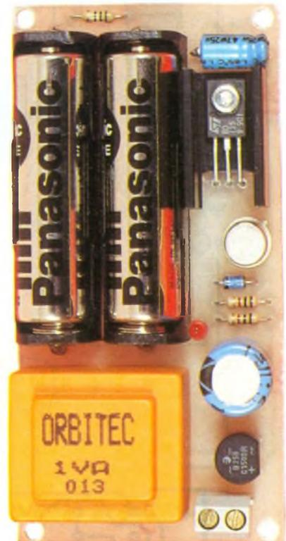
L'énergie est prélevée du réseau de distribution 220 V par le biais d'un petit transformateur délivrant une tension de 6 V sur son enroulement secondaire. Après redressement de deux alternances, la capacité  $C_1$  réalise un efficace filtrage. La LED  $L_3$  dont le courant est limité par  $R_1$  témoigne de la présence de l'alimentation.
