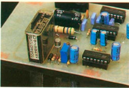
Photo 2 – Vue sur le relais de commande.
