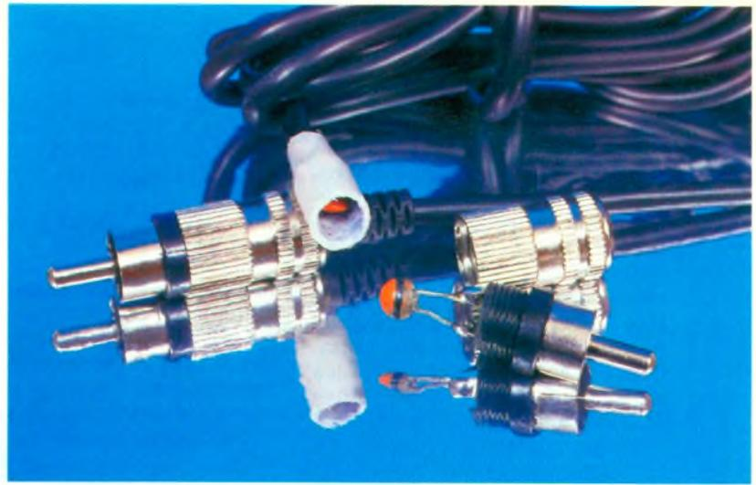
Photo 3. - Vue détaillée de la sonde encapsulée dans une fiche RCA mâle.
