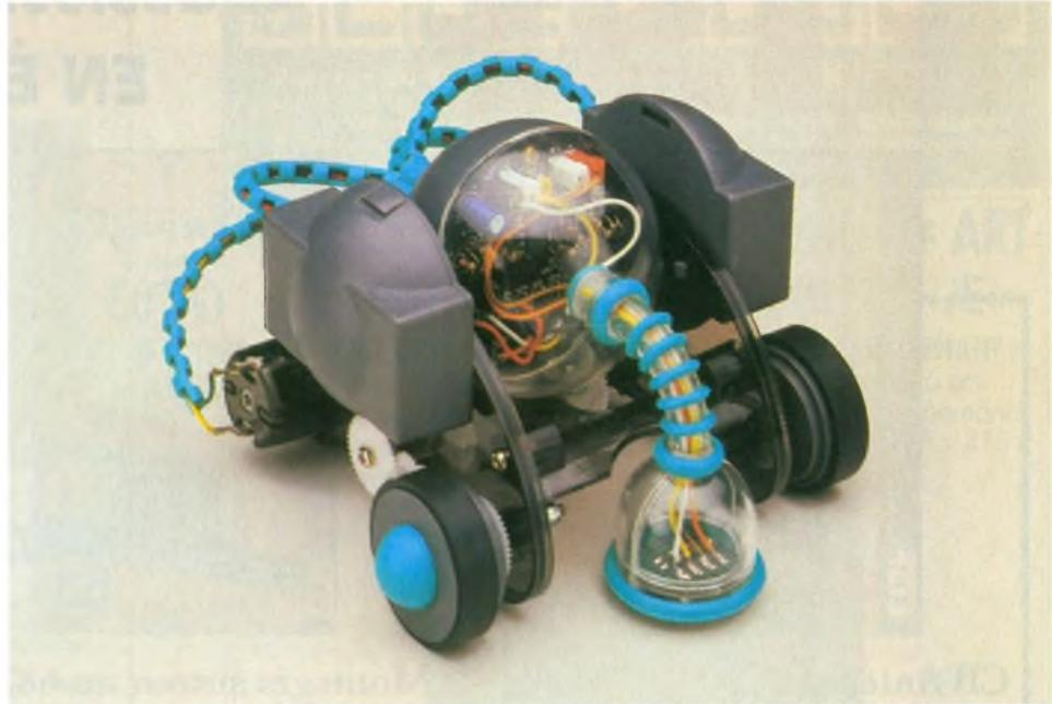
il tourne sur la gauche avant de continuer sa route en ligne droite. Ce robot évolue à l'aide de trois jambes disposées de chaque côté de la coque.
