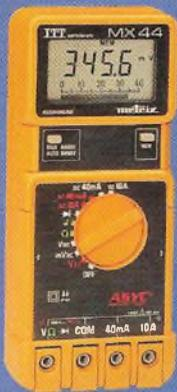
Caractéristiques : Tension 5 cal. 400 mV à 1000 V (0,3%) • Tension 4 cal. 4 V à 750 V (1,5%) • Intensité 2 cal. 40 mA - 10 A (1%) • Intensité 2 cal. 40 mA - 10 A (2%) • Résistance : 6 cal. 400  $\Omega$  à 20 MW (0,3%) • Tension : 2 V, 1 mA • Continuité avec beeper : R < 50  $\Omega$   $\pm$  20  $\Omega$  • Alimentation : Pile 9 V 6LF22 AL 0042.
