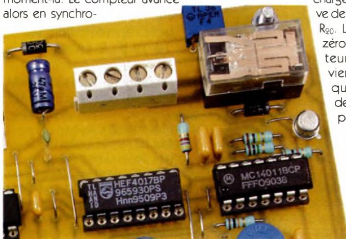
poursuivra par les capacités et les transistors pour terminer avec les composants les plus volumineux. Attention à l'orientation correcte des composants polarisés. Les curseurs des ajustables pourront, dans un premier temps, être placés dans leur position médiane.
