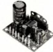
Petit circuit imprimé avec préamplificateur et amplificateur de sortie pouvant être employés séparément. Aucun réglage requis. Protection contre les courts-circuits. Alimentation : 4,5 à 15 VDC. Sensibilité d'entrée amplificateur de sortie : 150 mV (12 V) - préamplificateur : 20 mV (12 V) - Puissance maximale de sortie : 2,5 W (4Ω, 12 V) - Dimensions du circuit imprimé : 42 x 32 x 27 mm.
