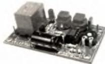
Minuterie miniature pour toutes les applications, à temporisation jusqu'à max 60 min. Possibilité de modification de la plage de réglage. Alimentation : 12 VDC/55 mA - Relais : 220 V/3 A - Inverseur - Intervalle (sans modifications) réglable de 0 à 15 minutes - Dimensions du circuit imprimé : 38 x 69 mm.
