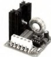
Ce petit circuit peut être utilisé non seulement pour varier la luminosité de lampes, mais également pour varier des charges inductives, telles que la puissance d'un transformateur pour éclairage halogène, la puissance de moteurs, etc.
