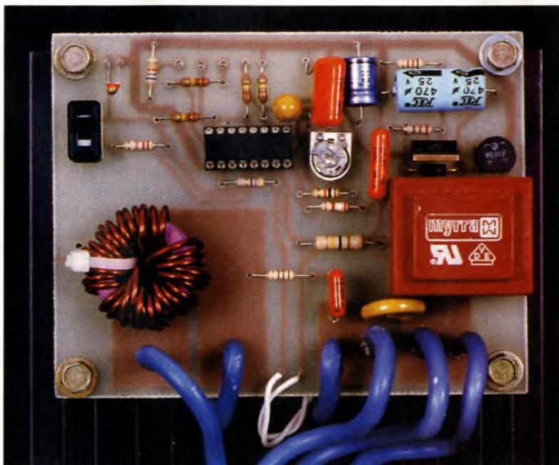
Tout de suite rappelons que nous avons affaire à un montage d'électronique de puissance. Le refroidissement du triac est donc indispensable : c'est un BTA40-700B (40A nominal et 700V) qui dissipe 35W pour 27,3A (intensité pour 6 kW en 220V). En conséquence, IL EST INDISPENSABLE de monter le triac enduit de graisse de dissipation thermique pour maintenir sa jonction en dessous des 125°C fatidiques.
