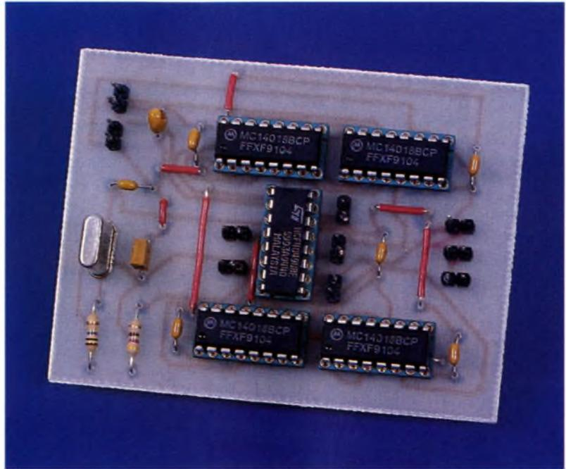
visée par quatre compteurs en décade du type CD4018 ( $U_1$ ,  $U_2$ ,  $U_4$  et  $U_5$ ) pour fournir des sorties de 100 kHz, 10 kHz, 1 kHz, et 100 Hz. La sortie de chaque compteur attaque l'horloge du compteur suivant pour diviser de nouveau la fréquence par dix.
