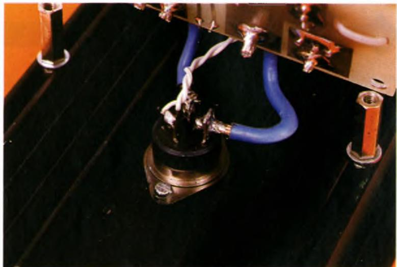
La mise en service du montage est simple : il suffit de placer  $P_1$  en position température maximale et vérifier l'alimentation permanente de la charge avec un voltmètre. Ensuite, testez l'arrêt du fonctionnement en fermant  $S_1$ .
