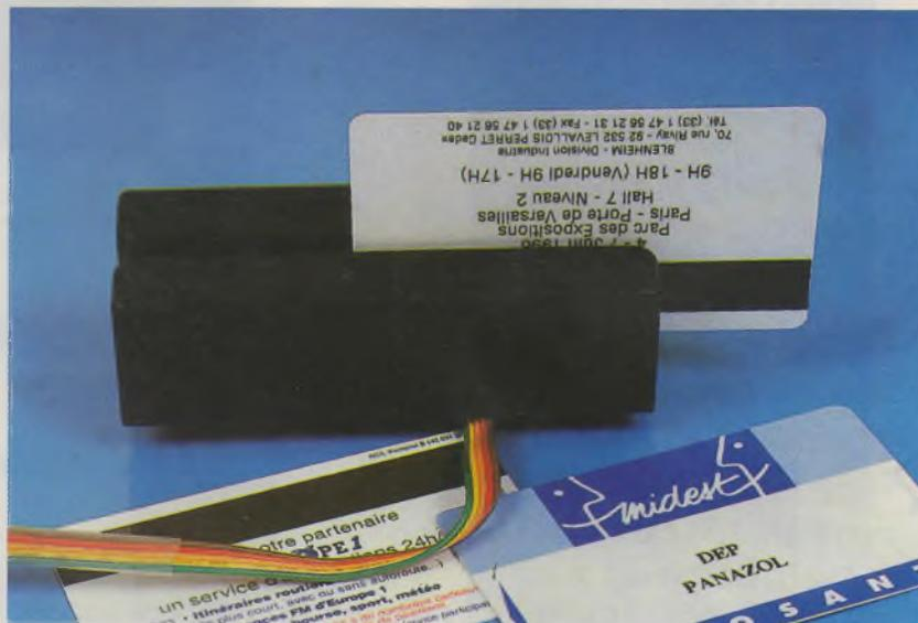
une trace de ces données, à chaque passage de carte, il va être possible de les collecter via le terminal de Windows, paramétré sur 1200 bauds, 7 bits de données et 2 bits de stop. Pour ce faire, vous aurez besoin de réaliser l'interface TTL/RS232.
