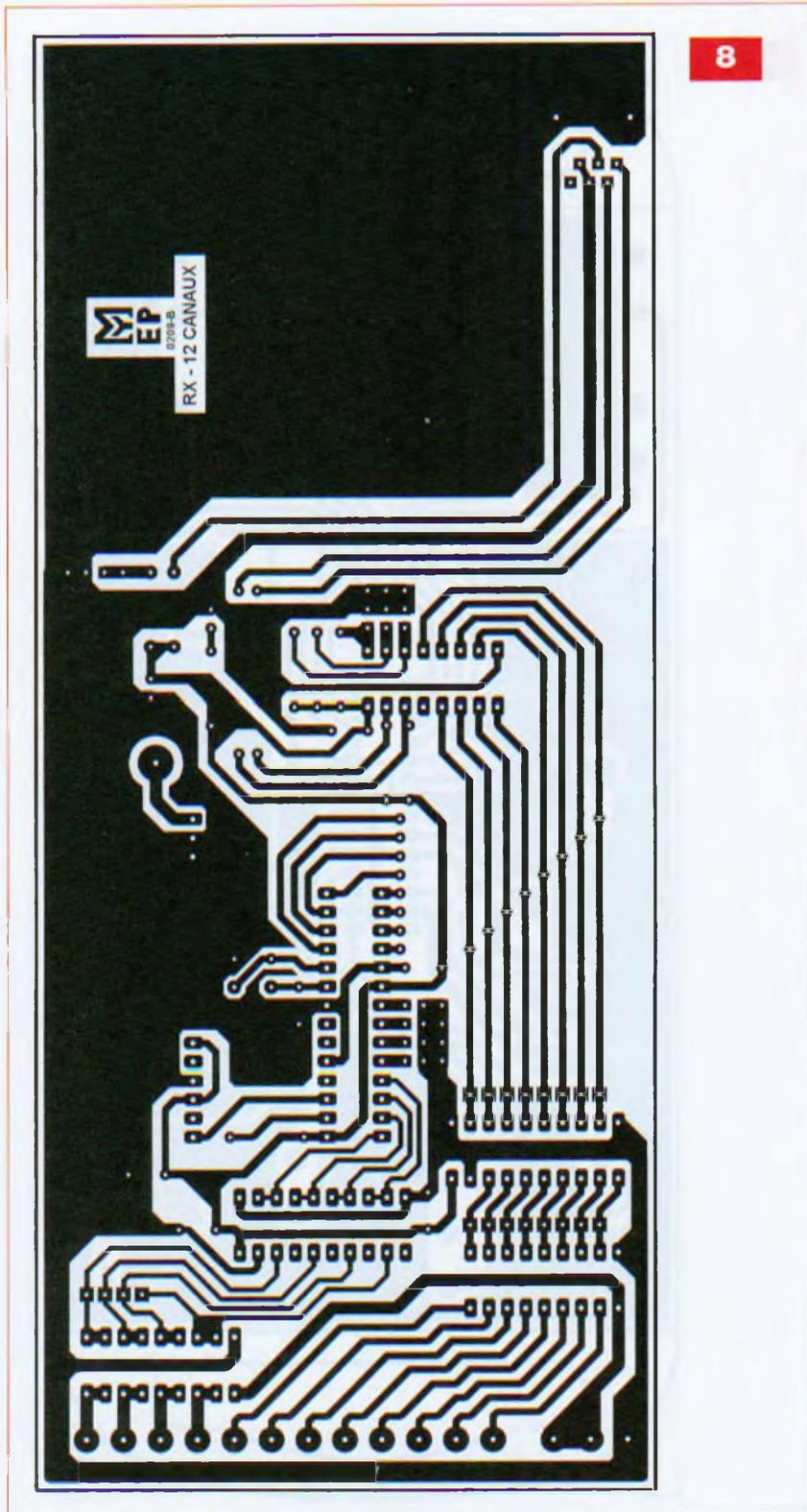
La tension de « puissance » externe, commune à toutes les sorties, peut être comprise entre +5 V et plus de +24 V. Attention à la somme des intensités véhiculées sur les pistes du circuit imprimé !
