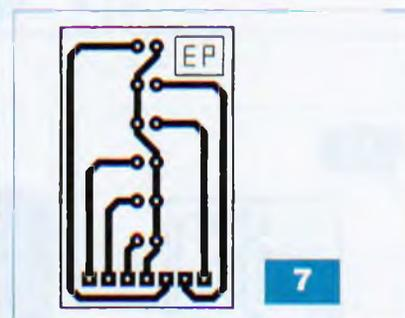
Le module rotatif se compose de deux circuits imprimés : le module de base (figure 6, page suivante) et l'afficheur (figure 7).
