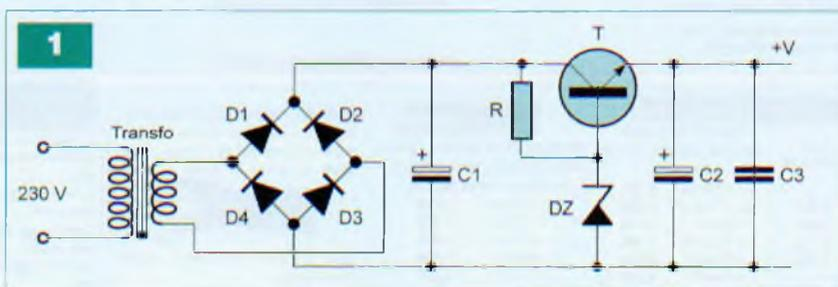
ment, la puissance thermique perdue dans le régulateur atteint déjà 1 W. C'est de l'énergie dépensée en pure perte. Si la source provient du secteur de distribution 230 V, cette perte reste éventuellement acceptable.
