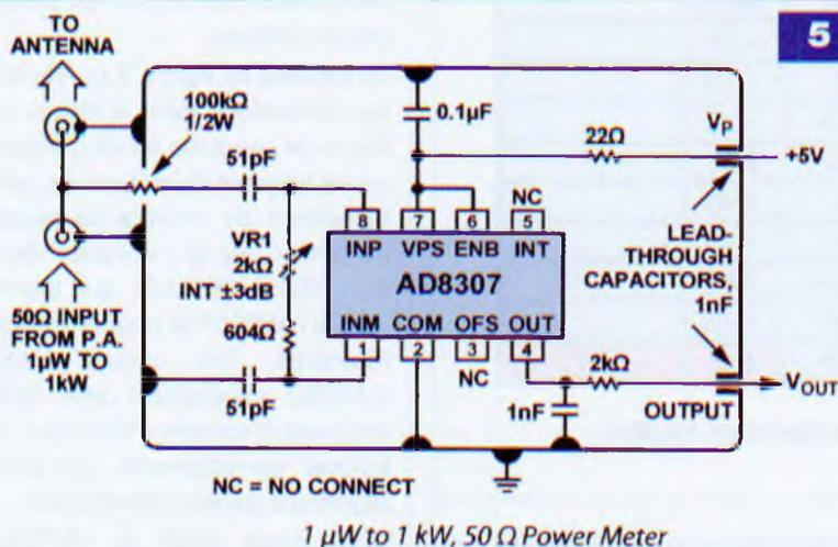
à +60 dBm (223  $V_{rms}$ ). Un rapport d'atténuation de 158 : 1 (44 dB) a été utilisé. Ainsi, la plage de mesure est déplacée de -84 dBm à -40 dBm. L'AD8307, calibré à 250 mV/décade de puissance, indique alors 1,5 V pour un niveau de puissance de 100 mW, 2 V pour 10 W et 2,5 V pour 1000 W, d'après la formule :
