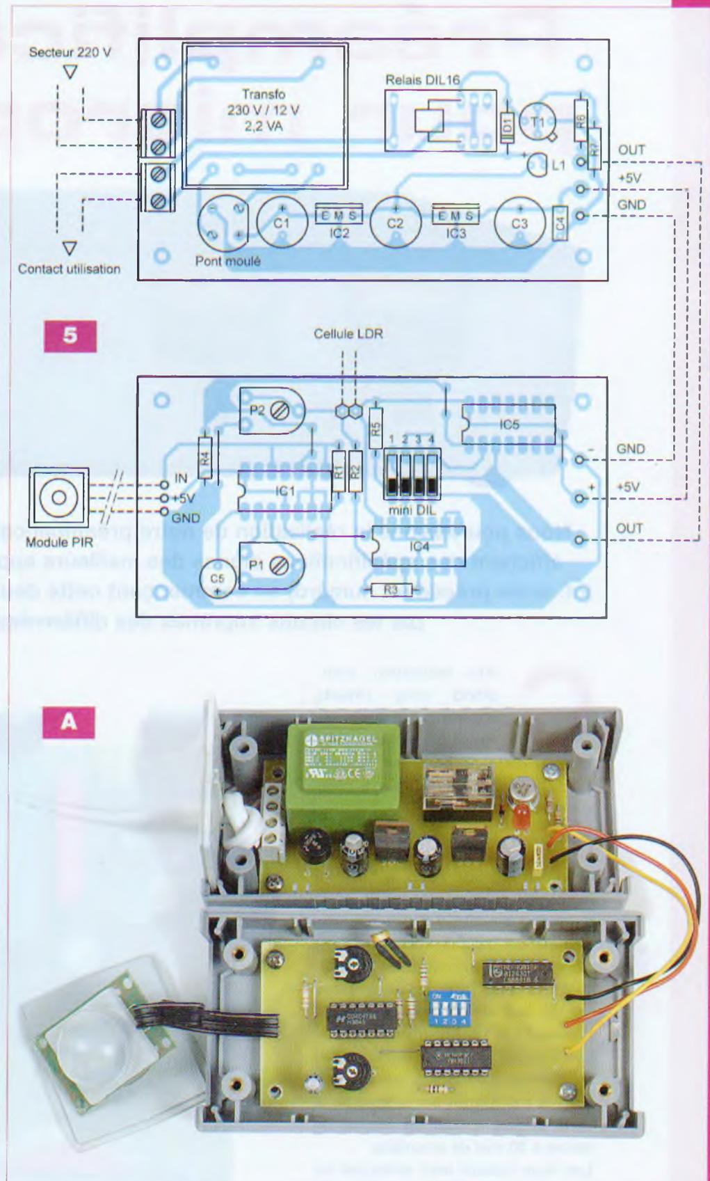
Fresnel. Les ajustables sont réglés à mi-course pour les essais, après un contrôle minutieux des pistes et des soudures.
