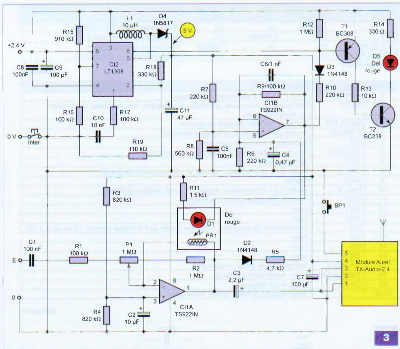
nue. Cette résistance shunte celle de contre-réaction de l'amplificateur opérationnel et réduit instantanément (aux constantes de temps près) le gain de l'amplificateur, évitant ainsi un écrêtage.
