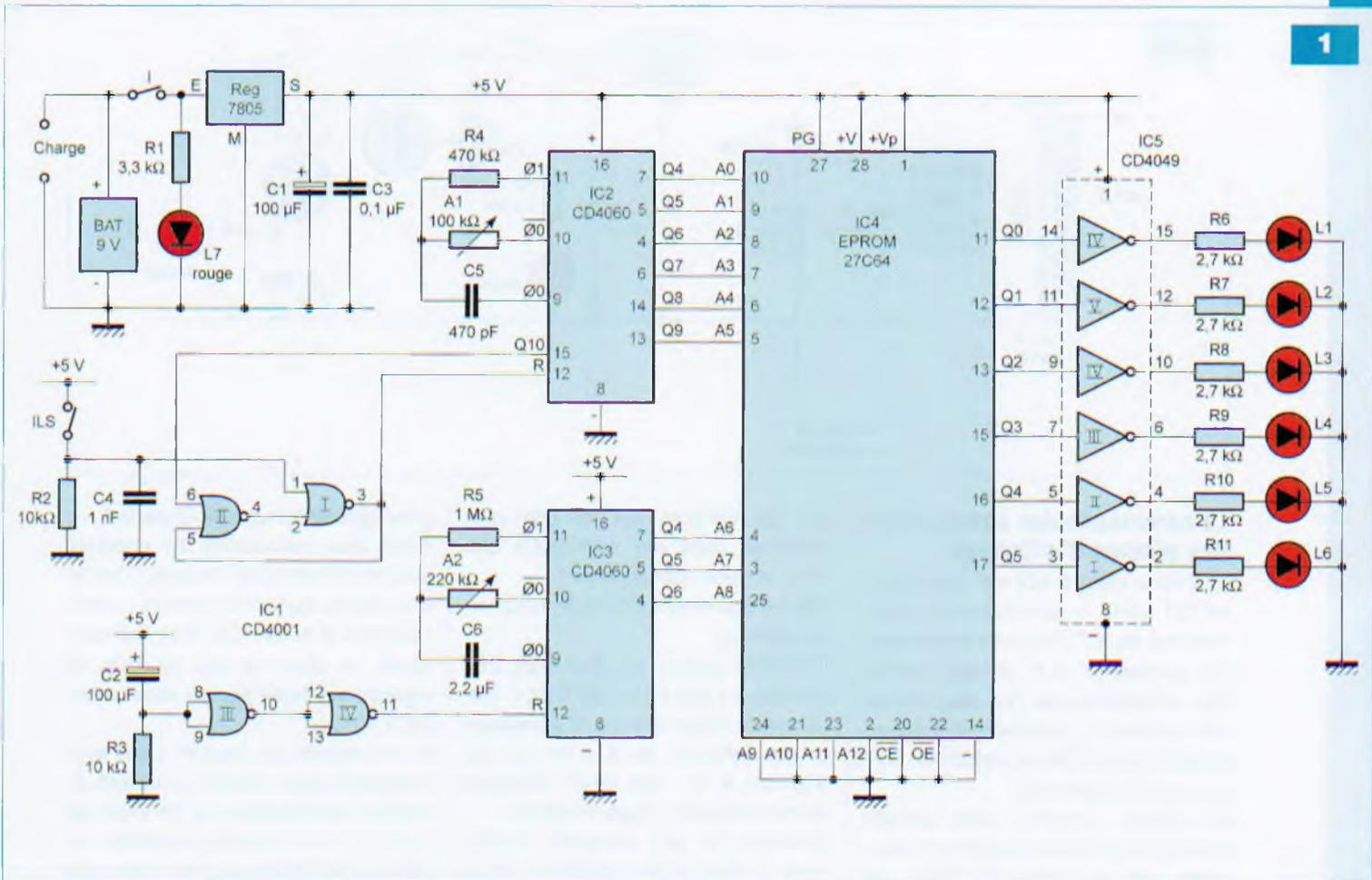
À noter que la charge de la batterie est possible à tout moment, même lorsque l'interrupteur (I) est ouvert.
