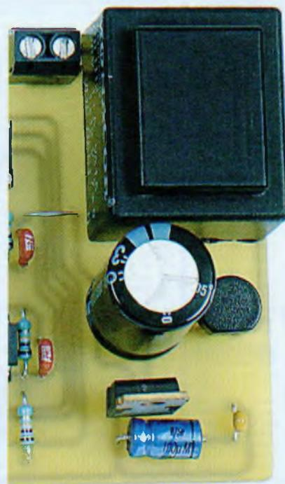
secteur 230 V par l'intermédiaire d'un transformateur abaisseur de tension. La basse tension recueillie voit ses deux alternances redressées par quatre diodes formant un pont. La capacité C1, que l'on pourrait qualifier de capacité « réservoir », réalise un premier filtrage. On observe alors, sur son armature positive, un potentiel légèrement ondulé, de valeur moyenne relativement supérieure à la tension alternative efficace nominale du secondaire du transformateur.
