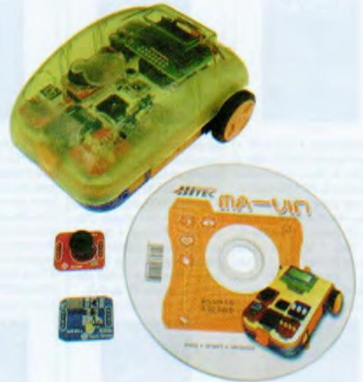
Le robot « MA-VIN », distribué en France par la société Lextronic, est constitué d'une base mobile pourvue de deux moteurs équipés de réducteurs avec pneus « gomme » et d'une roue « libre » au centre. Le montage du mobile ne demande pas plus de quinze minutes et ne nécessite aucune soudure.
