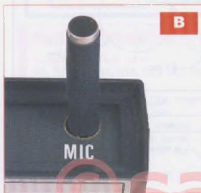
que le micro dépasse du sommet du corps de la fiche d'au moins 1 ou 2 cm, il convient ensuite de rigidifier cette liaison souple, par exemple avec du carton fort enroulé autour du câble « audio » en formant un cylindre de même diamètre que le corps du micro. Ensuite, enserrer le tout dans une gaine thermorétractable noire de diamètre approprié. La **figure 7** montre quelques aspects de cette réalisation.
