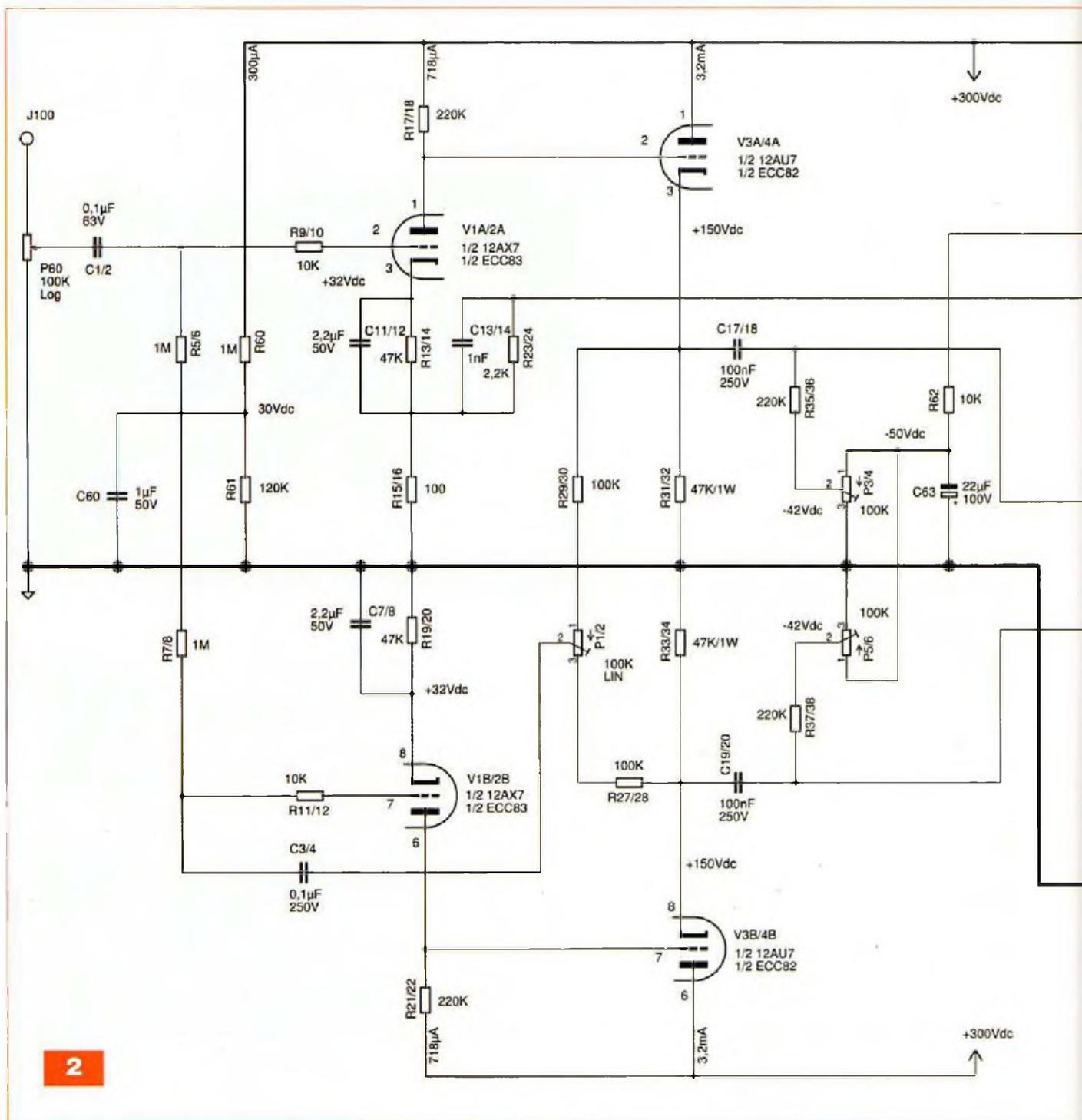
Son réglage permet de réduire le taux de distorsion à son minimum. Les deux signaux déphasés se retrouvent aux cathodes de la 12AU7 (V3A et V3B).
