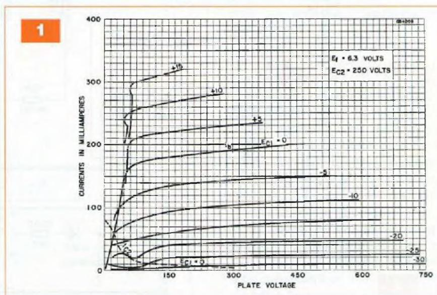
La tétrode KT66 fut développée au Royaume-Uni à partir de 1935 par Marconi Osram Valves (M-OV). Commercialisée en 1937, donc un an après la 6L6 lancée aux États-Unis, elle présentait l'avantage d'avoir éliminé totalement la caractéristique de résistance négative présente aux tensions d'anode inférieures à 150 V, ce qui n'était qu'imparfaitement réalisé avec la 6L6 américaine (figure 1).
