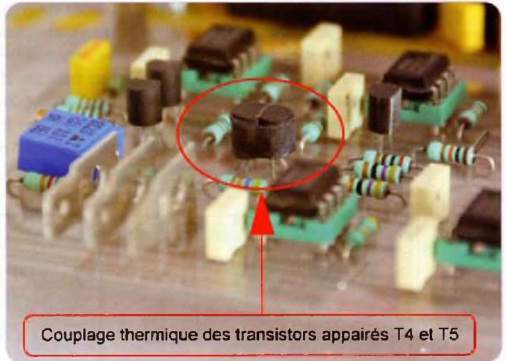
Couplage thermique des transistors appariés T4 et T5
