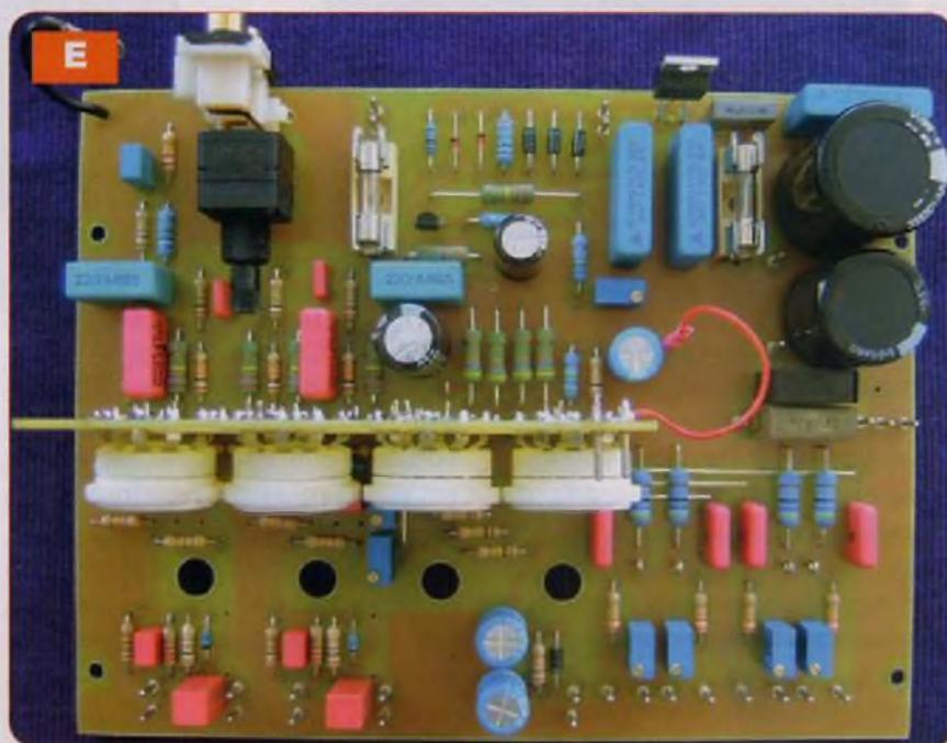
(photo E). Le fil de 1,5 mm<sup>2</sup> est coupé à bonne longueur et terminé par une cosse de 4 mm. Le raccordement au
