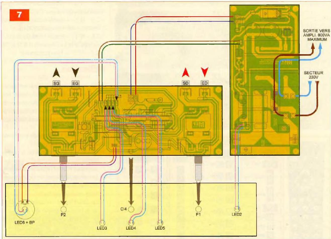
Effectuez ensuite le raccordement de la platine de commande à son alimentation et à la face avant en vous aidant du plan de la figure 7 et du schéma de principe (figure 1).
