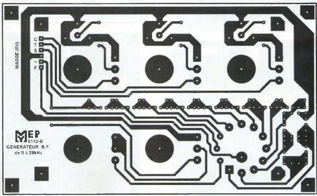
Afin de relier la platine de commande à celle du générateur, insérez dans les trous six broches de barrette sécable SIL mâles longues, en regard du connecteur femelle, vissez-les provisoirement à l'aide d'entretoises filetées de diamètre 3 mm et 25 mm de longueur et soudez-les sous le cir-
