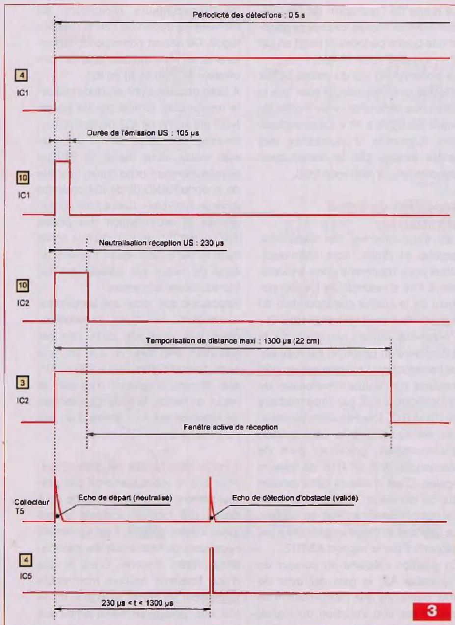
teurs récepteurs sont généralement impactés par l'écho correspondant. Un bref état «haut» apparaît alors sur les sorties des portes AND (I) et (II) de IC5. Mais l'une de ces sorties accusera fatalement un front montant avant l'autre, même si l'écart n'est que de quelques nanosecondes ! En effet, ainsi que nous l'avons déjà explicité au chapitre consacré au principe du fonctionnement, le chemin qu'aura à parcourir un train d'ondes, par rapport à l'autre, sera différent.
