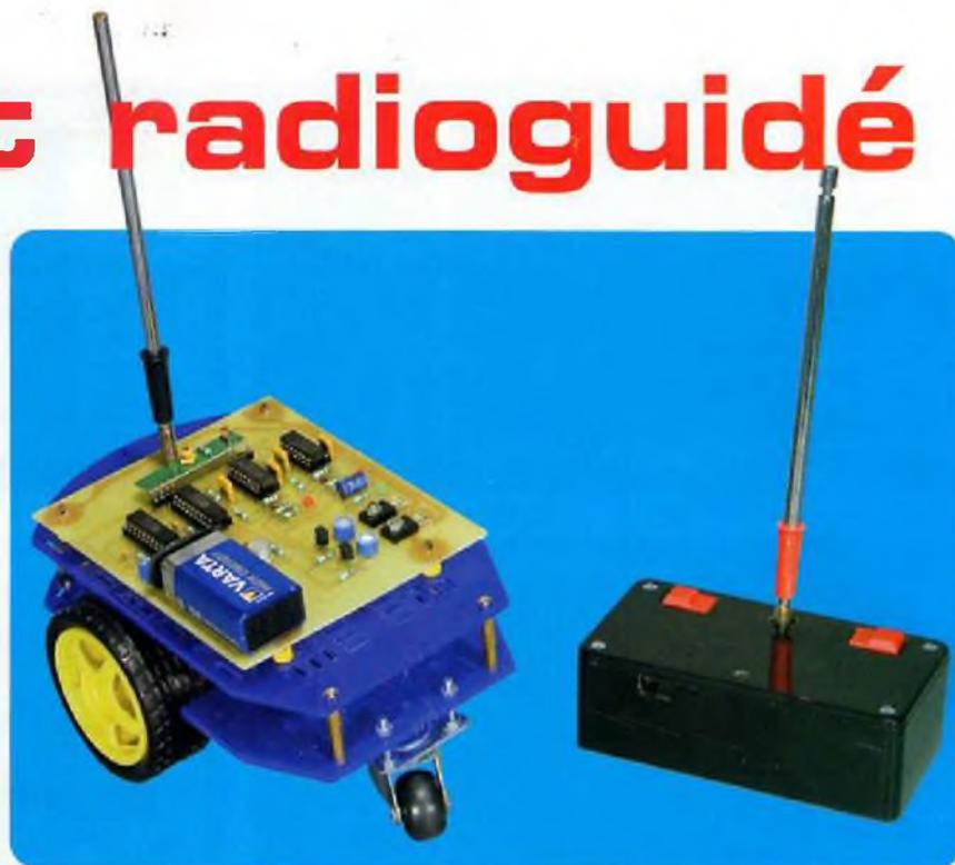
soit 36 cm/s. Les dimensions de l'ensemble sont de 175 x 110 x 70 mm et le diamètre des roues motrices de 65 mm, pour une largeur des bandes caoutchoutées de 26 mm.
