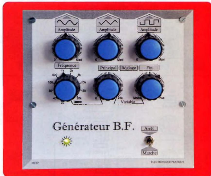
**N**ous souhaitons, par exemple, pouvoir disposer des trois formes d'ondes simultanément, régler individuellement le niveau de chacun des trois signaux, couvrir l'intégralité de la bande « audio » à l'aide d'un seul organe de commande.
