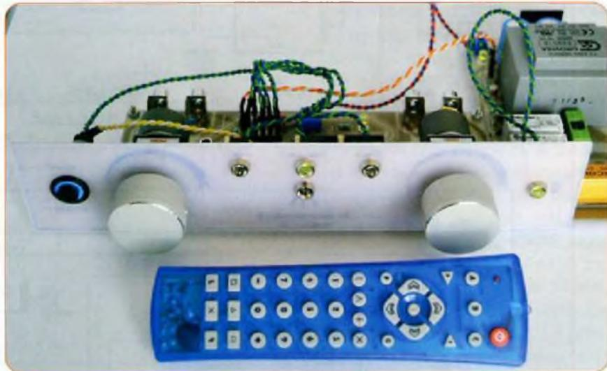
Celui-ci, en plus de sa motorisation permettant la commande à distance, peut se manœuvrer manuellement, ce qui ajoute une touche «high-tech» lorsque les boutons tournent seuls avec la télécommande.
