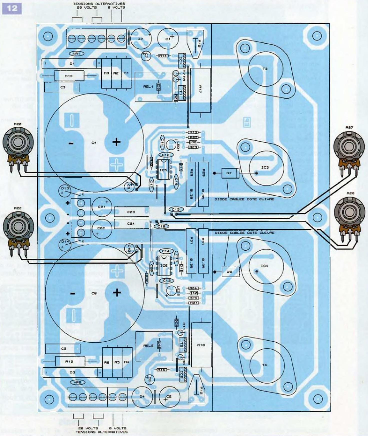
nécessaire car la dissipation n'est pas suffisante. Les ponts redresseurs D1 et D3 sont équipés de petits dissipateurs. Ces
