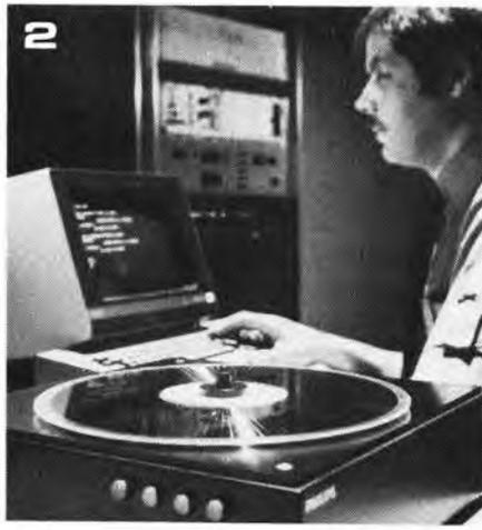
Figure 2. Le système complet à mémoire optique ressemble énormément à une platine classique. Cependant, le bras de lecture se situe sous la platine.
