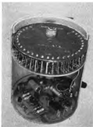
Ce convertisseur est conçu pour réaliser un **compte-tours** électronique utilisant l'afficheur à échelle circulaire décrit dans ce numéro. L'utilisation de diodes électroluminescentes commandées par un circuit UAA170, permet d'obtenir un dispositif sans aucune partie mobile, et supportant donc bien les vibrations du véhicule.
