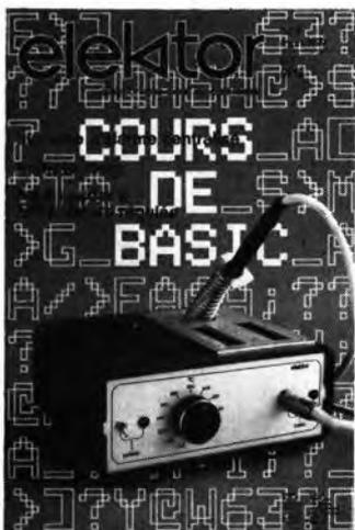
Les **fers à souder à température régulée** offrent de nombreux avantages par rapport aux fers à chauffage continu; le circuit décrit ici constitue un module de régulation de température qui, à la fois, est facile à construire, et utilise des composants classiques.
