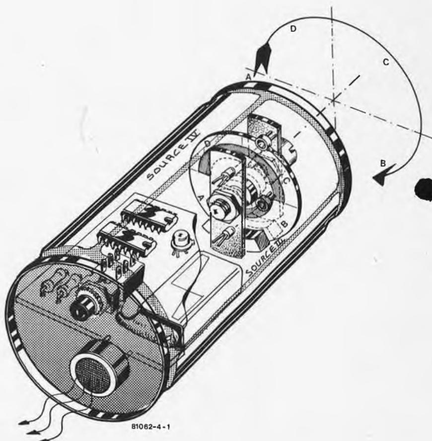
Figure 1. C'est encore la mécanique qui domine dans la réalisation de cette télécommande sans fil.
