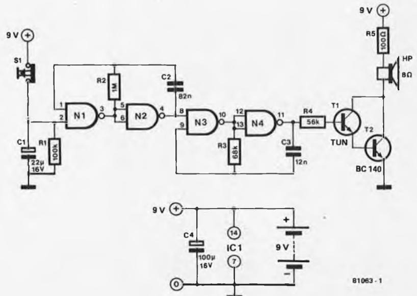
Figure 1. Le schéma du détecteur de raid nocturne, un oscillateur de fréquence 1 kHz est commandé par un autre dont la fréquence est de 3 Hz.
