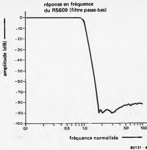
Figure 4. Courbe de réponse en fréquence d'un filtre passe-bas à fréquence de coupure variable, construit au moyen d'un R 5609 et d'un oscillateur produisant des signaux carrés.
