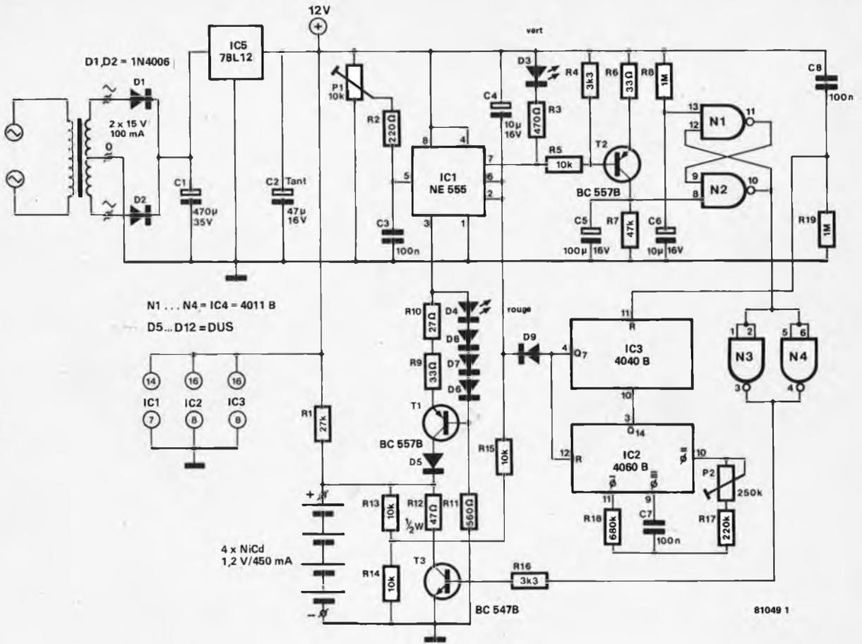
Figure 1. Le circuit complet du chargeur d'accus.
