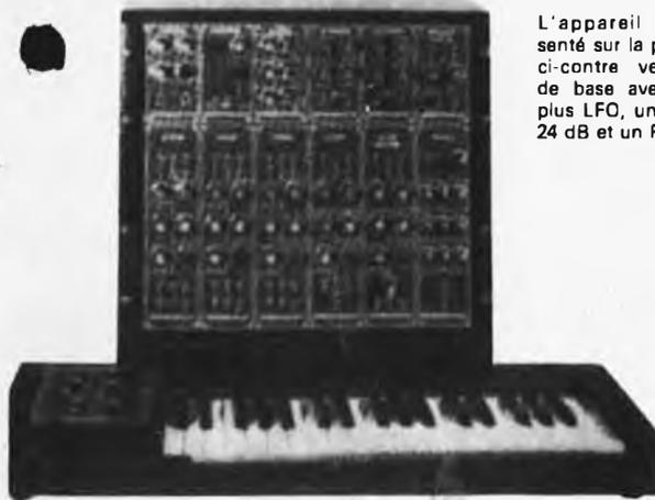
L'appareil présenté sur la photo ci-contre version de base avec en plus LFO, un VCF 24 dB et un RFM
