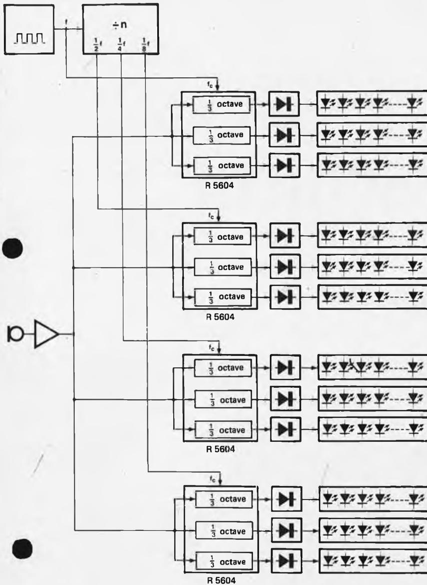
Figure 9. Le bloc-diagramme d'un analyseur de spectre audio "état solide". Le son amplifié est appliqué aux filtres 1/3 d'octave. Après détection, la sortie de chaque filtre est rendue visible à l'aide d'un réseau de LED pour thermomètre.
