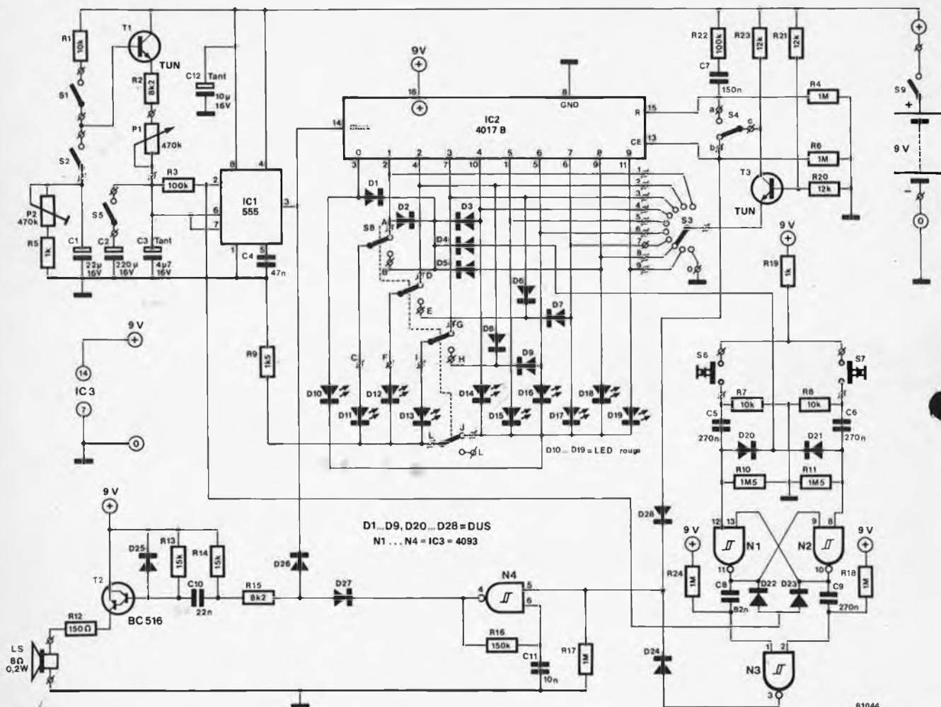
Figure 1. Le circuit de la boîte à jeux. Le chenillard construit autour d'IC1 et IC2 est au coeur de ce montage.
