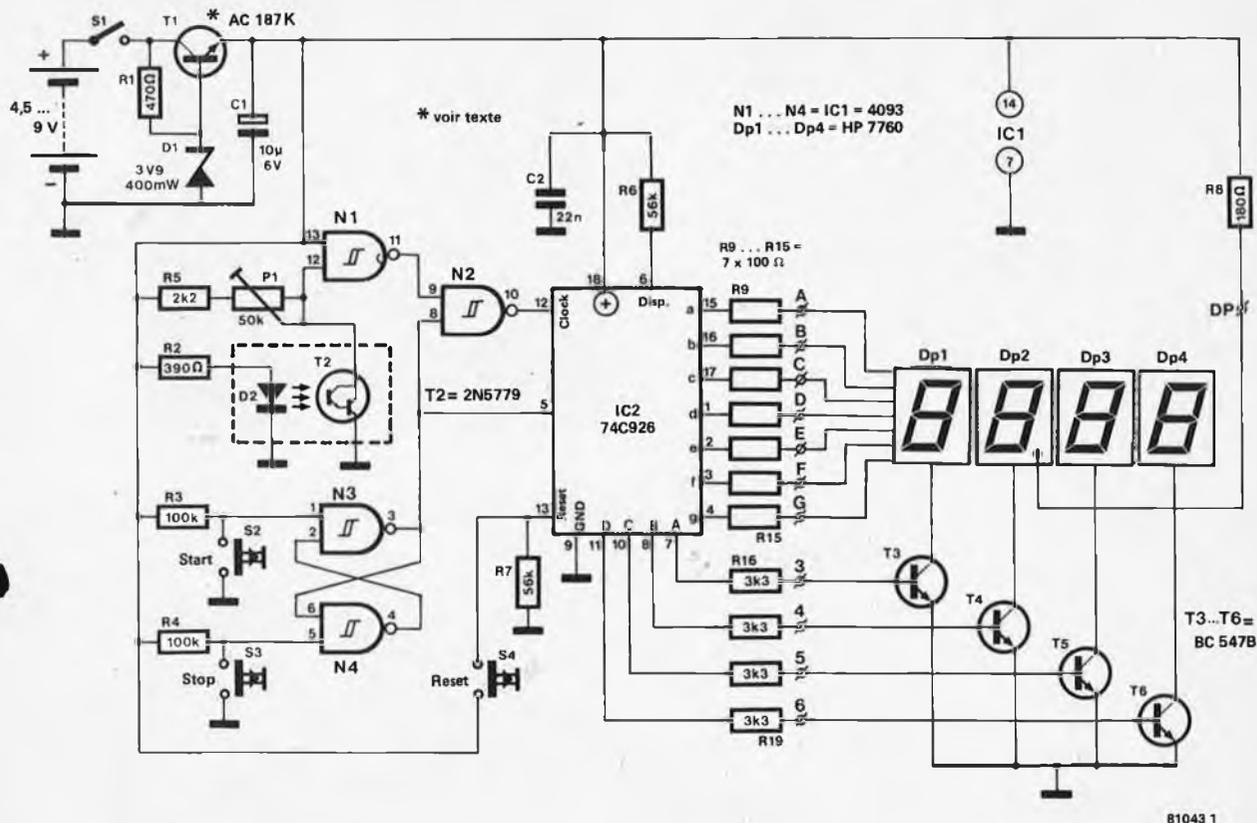
Figure 1. Schéma complet de la partie "mesure".
