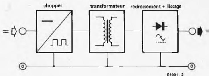
Figure 2. Conversion par chopper, transformateur, et redressement.
