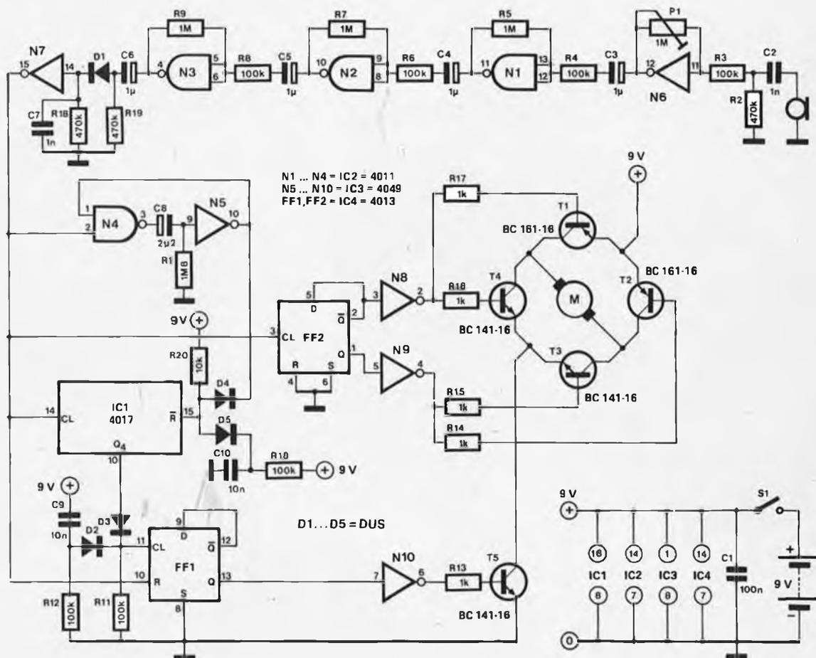
Figure 1. Le schéma de la boîte "mobile" présente deux points intéressants: la chaîne d'amplification (analogique) qui utilise des composants digitaux, et le pont de transistors qui permet d'inverser le sens de rotation du moteur.
