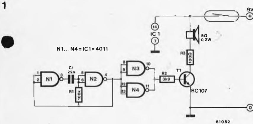
Figure 1. Le circuit du steelband aurait difficilement pu être plus simple. Ce qui permet de l'étendre à moindres frais.
