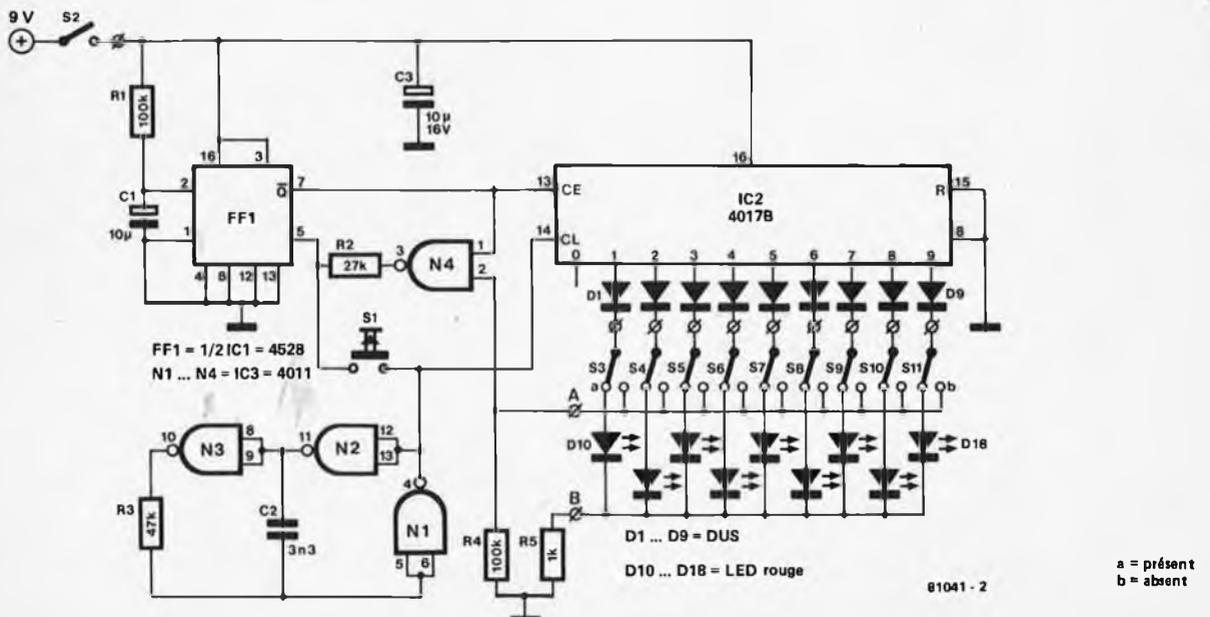
Figure 2. Circuit de comptage et d'affichage de l'indicateur.
