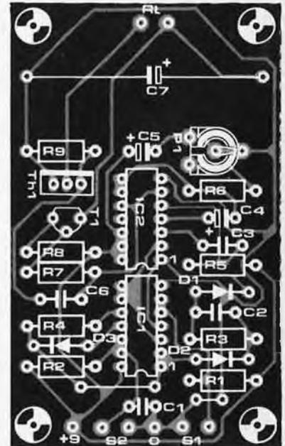
Figure 3. Circuit imprimé et implantation des composants du "cerveau" artificiel.
