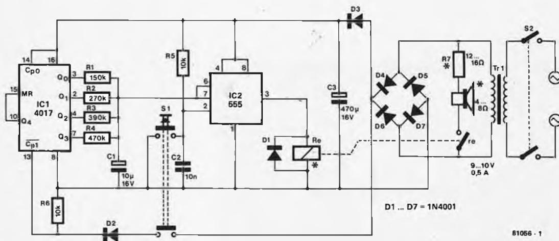
Figure 1. Le circuit complet du shaker à dés.
