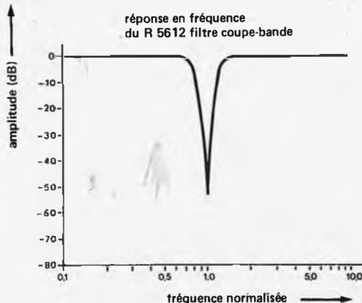
Figure 6. Au lieu du R 5609, on peut utiliser un R 5612 pour réaliser un filtre coupe-bande atténuant la fréquence "indésirable" d'environ 55 dB.
