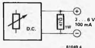
Figure 4. Circuit auxiliaire pour le réglage du chargeur.
