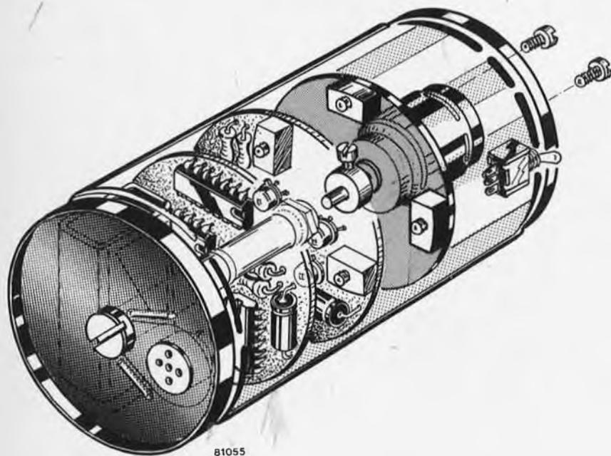
Figure 2. La construction mécanique de la boîte qui avance toute seule est très simple: il faut que le volant soit très bien équilibré (voir le texte).
