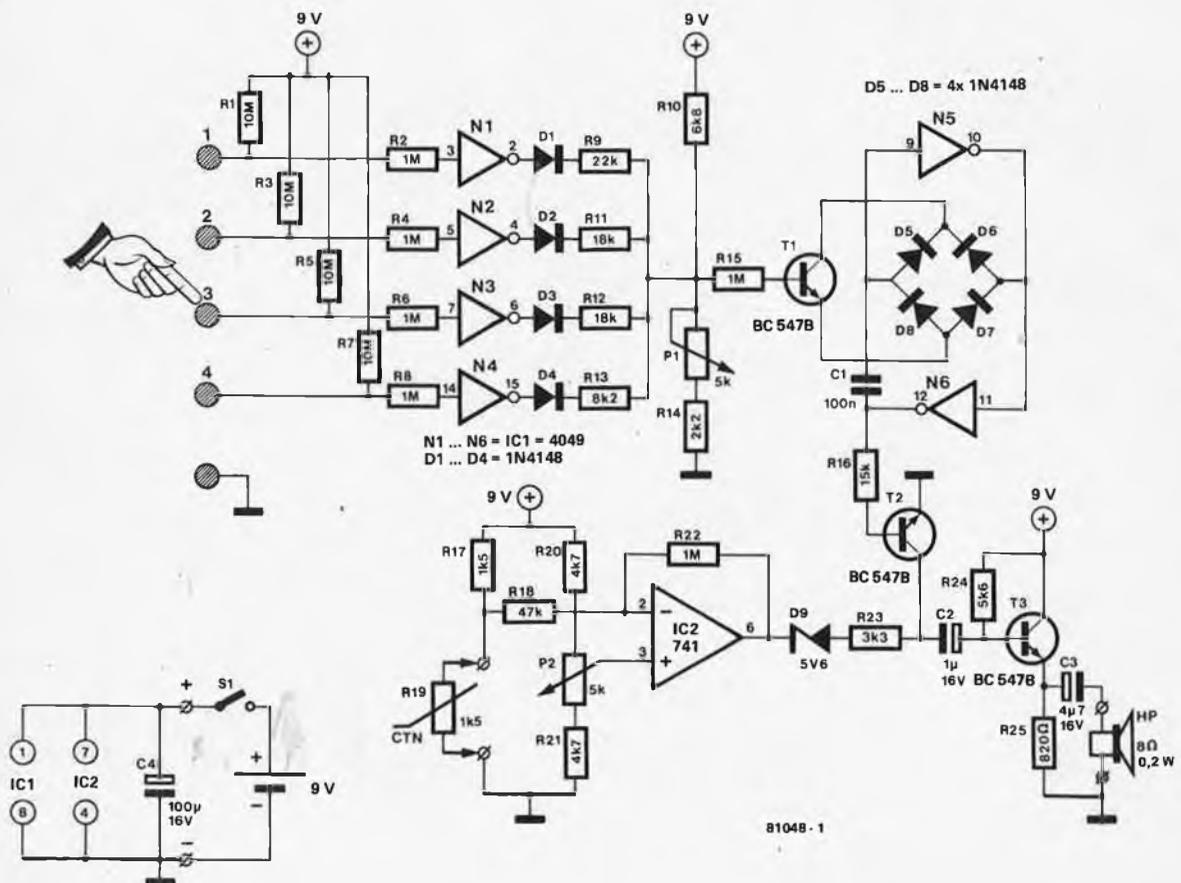
Figure 1. Schéma de principe du biniou électronique.
