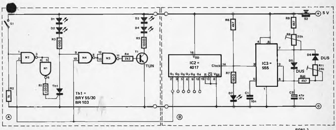
Figure 3. Le circuit se compose de deux sections. le circuit de reconnaissance des touches (section A), et le circuit de sélection de la cible (section B).
