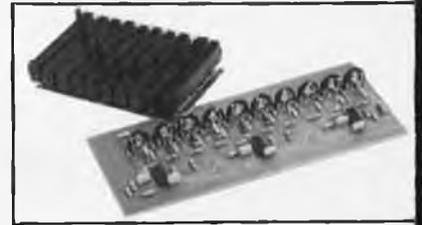
2052. Equalizer stéréo à 10 fréquences à potentiomètres rectilignes.
