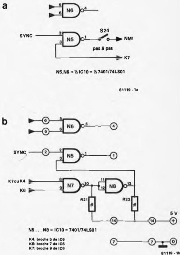
Figure 1. Le matériel nécessaire pour inhiber la procédure pas à pas lorsqu'on se trouve dans le moniteur (1a) ou dans une des deux zones d'extension sélectionnées respectivement par les signaux d'extension K4 ou K7 et K6 (1b).
