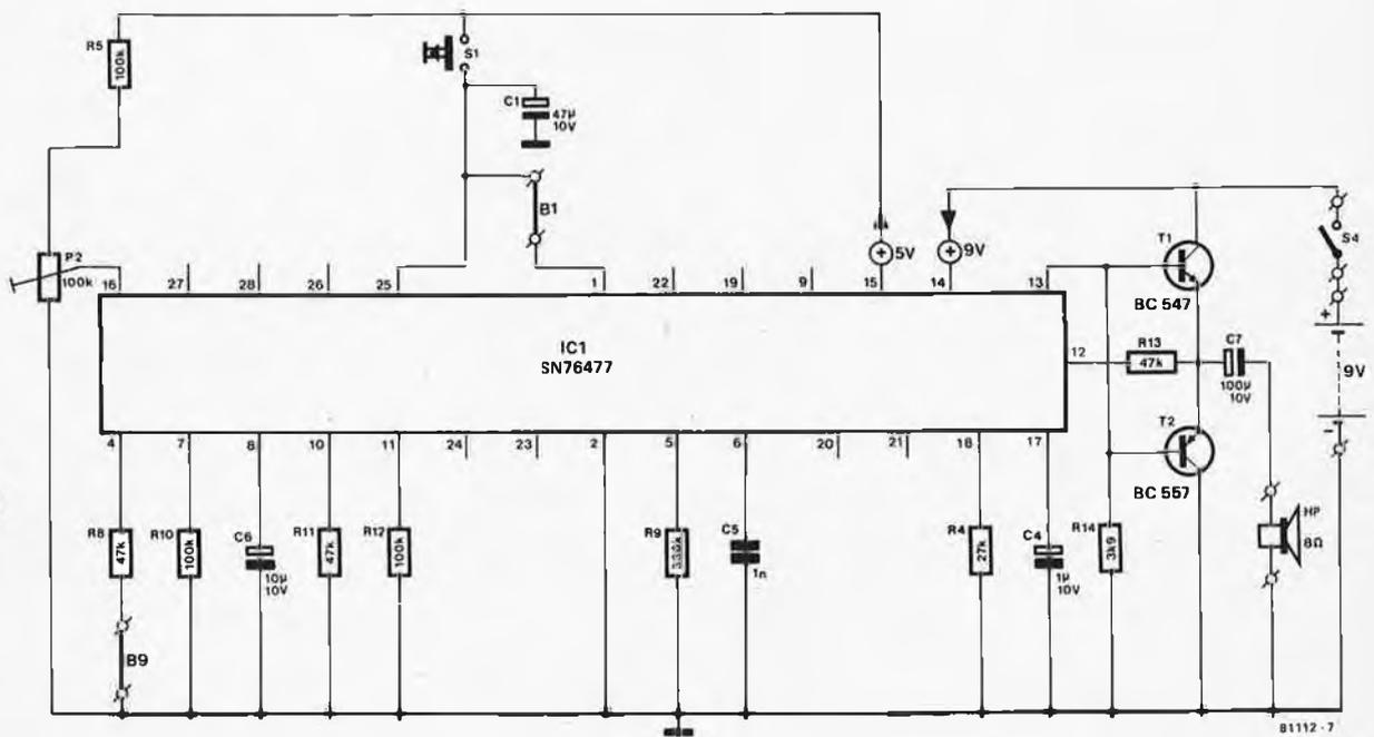
Figure 7. Voiture de course finissant dans les décors. Le potentiomètre P2 permet de régler le bruit propre à la voiture. Appuyer sur S1 fera quitter la route.
