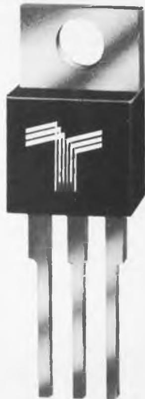
La dissipation est de 25 watts à 25°C boîtier et de 2 watts à 25°C ambiante (sans radiateur), mais il équivaut à un produit non isolé de 40 watts monté avec mica.
