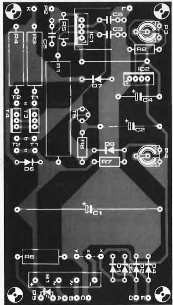
Figure 5. Circuit imprimé et implantation des composants.
