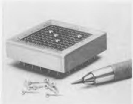
Les utilisations types se trouvent dans les systèmes de téléphone automatique, les programmes de séquences et les équipements de contrôle pour les procédés automatiques.
