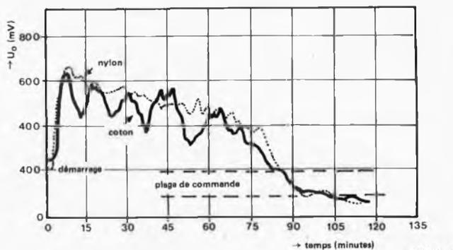
Figure 7. Un regard à l'intérieur d'un séchoir en cours d'opération. L'humidité relative chute au fur et à mesure que le chargement sèche. La courbe se réfère à un tambour plein, comme ce serait le cas chez une ménagère économe.
