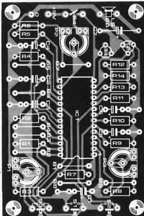
Figure 10. Voici le circuit utilisé pour tous les montages. Les éléments inutilisés pour un certain effet peuvent tranquillement être mis de côté.
