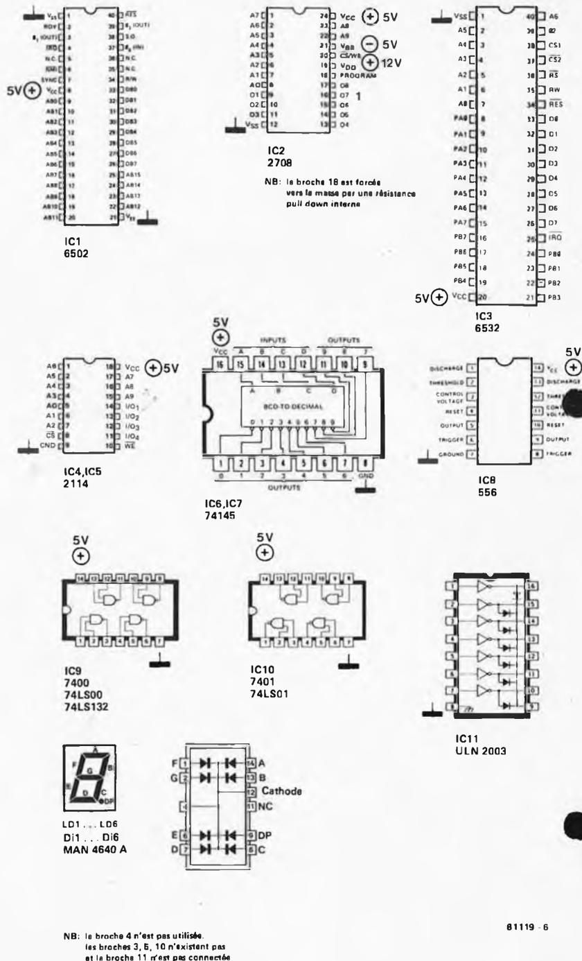
Figure 6. Le brochage de tous les circuits utilisés dans le Junior Computer, afficheurs compris.
