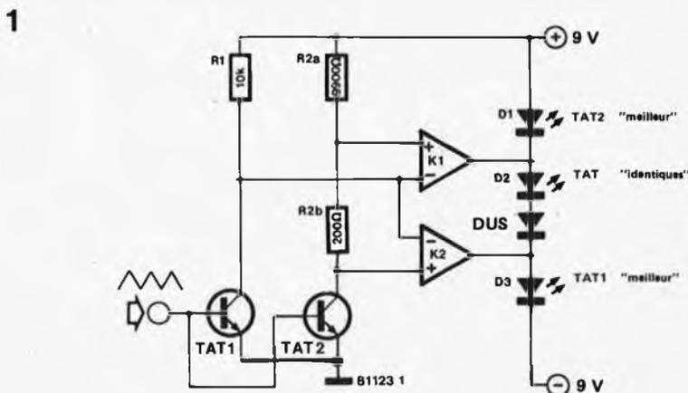
Figure 1. Schéma simplifié du testeur de transistors. Les différences entre les tensions de collecteur sont détectées par des comparateurs et affichées par des LED.
