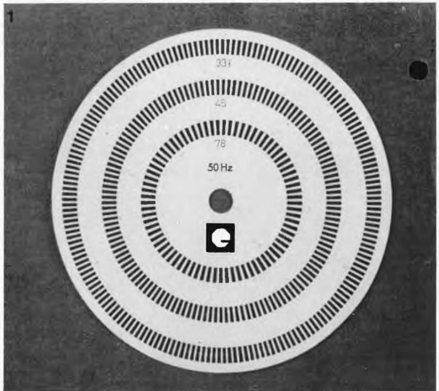
Figure 1. Modèle à l'échelle 1 d'un disque stroboscopique destiné au réglage des vitesses  $33\frac{1}{3}$ , 45 et 78 tours/min. Le nombre 50 Hz se rapporte à la fréquence du secteur pour laquelle ce disque est prévu.
