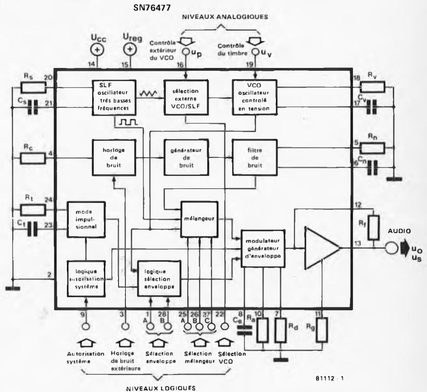
Figure 1. Schéma synoptique de la structure interne du circuit intégré générateur de sons complexes.
