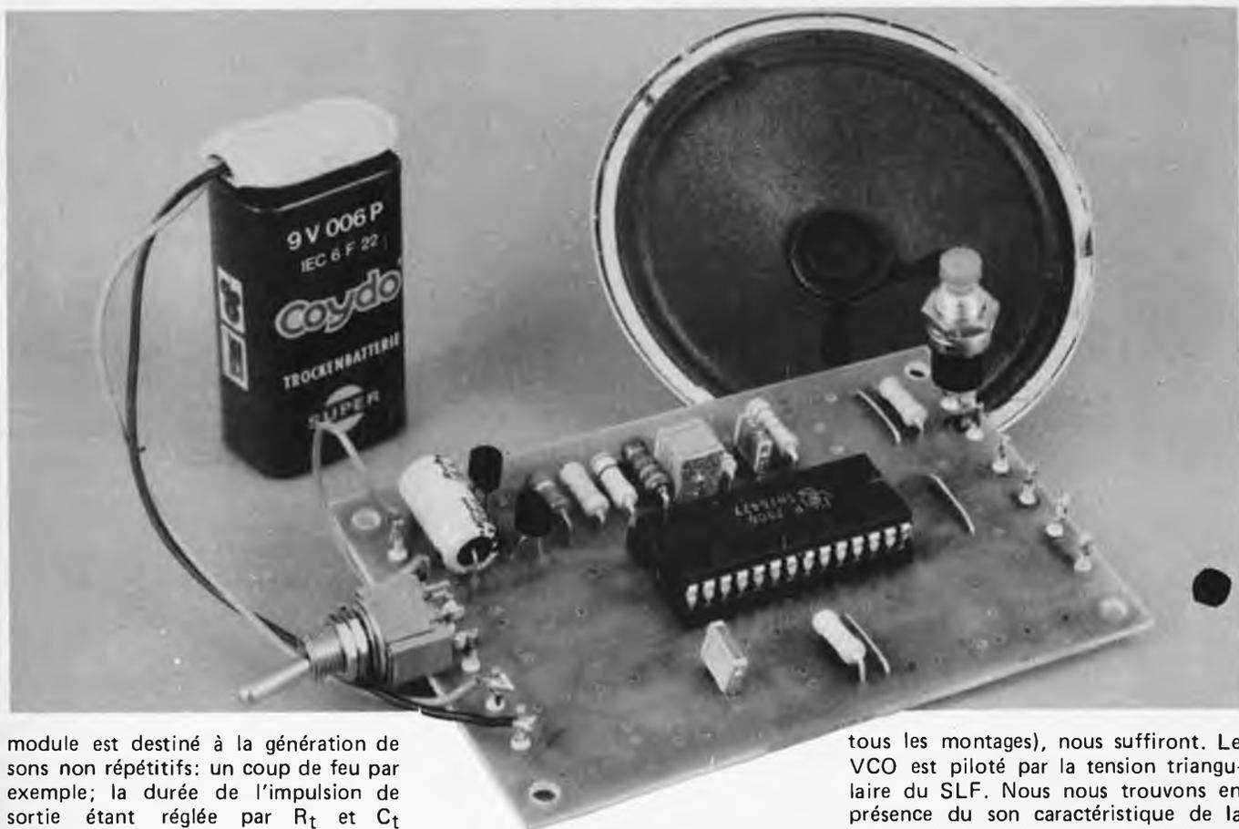
module est destiné à la génération de sons non répétitifs: un coup de feu par exemple; la durée de l'impulsion de sortie étant réglée par  $R_t$  et  $C_t$  (10 secondes au maximum).
