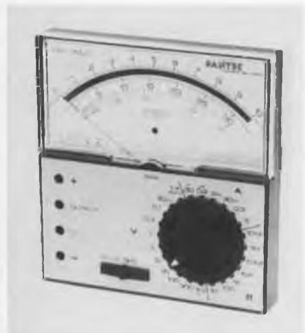
La lecture de toutes les gammes et calibres A, V et  $\Omega$  se fait sur une seule échelle linéaire, ce qui en ohmmètre garantit une grande précision dans les mesures. Le PAN 3003 est équipé d'un commutateur rotatif et sélecteur de fonctions à contacts dorés, lui assurant ainsi une longue durée de vie (jusqu'à 100 000 manœuvres).
