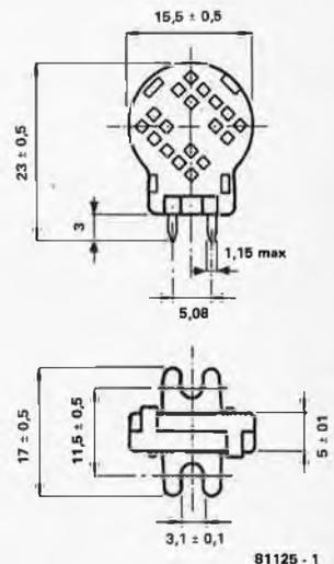
Figure 1. Le détecteur d'humidité à capacité tel qu'il a été conçu par Valvo. Les côtes sont données en mm.
