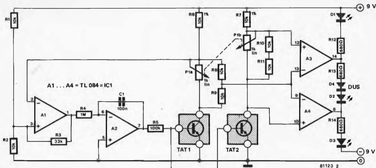
Figure 2. La version définitive du montage, dont voici le schéma, est construite autour d'un simple amplificateur opérationnel quadruple. Les deux premiers (A1 et A2) sont montés en générateurs de signaux triangulaires, les deux derniers (A3 et A4) tiennent lieu de comparateurs.
