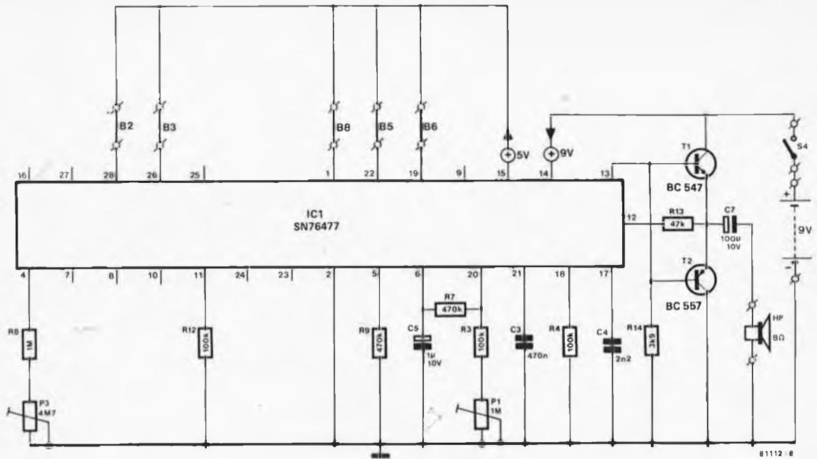
Figure 8. Gazouillis d'oiseau. En réglant P3 soigneusement, on obtient un effet très réaliste.
