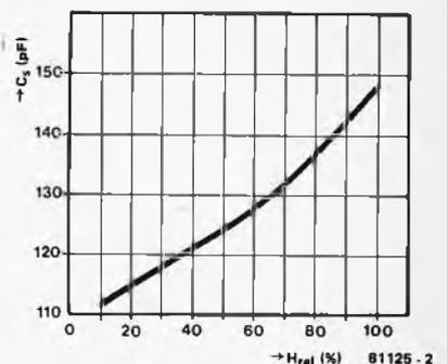
Figure 2. Relation entre l'humidité relative  $H_{rel}$  et la capacité du détecteur  $C_s$ .
