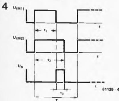
Figure 4. A quoi ressemblent les impulsions du circuit de la figure 3. La largeur des impulsions donne le degré d'humidité H<sub>rel</sub>.
