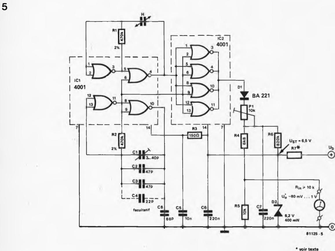
Figure 5. Le circuit de mesure avec sa sortie linéaire. Il peut être alimenté par une source extérieure. R7 a été choisie de façon à obtenir  $R7 \approx (U_B - U_{ST})/2mA$ , en  $\Omega$ .
