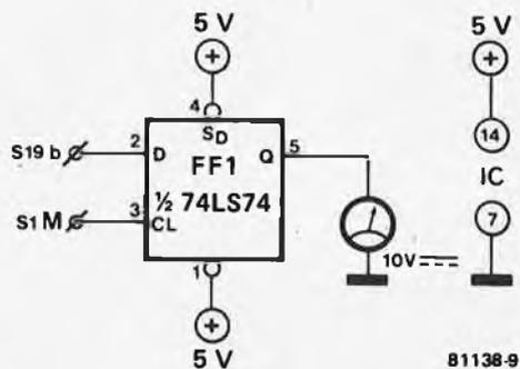
Figure 8. Voici un montage de secours qui vous permettra de calibrer P1.
