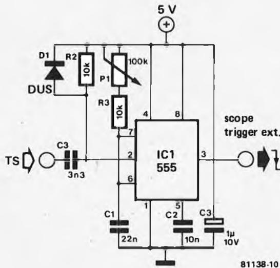
Figure 9. Pour ceux qui possèdent un oscilloscope sans base de temps variable! Le montage décrit ici permettra de visualiser tous les octets.
