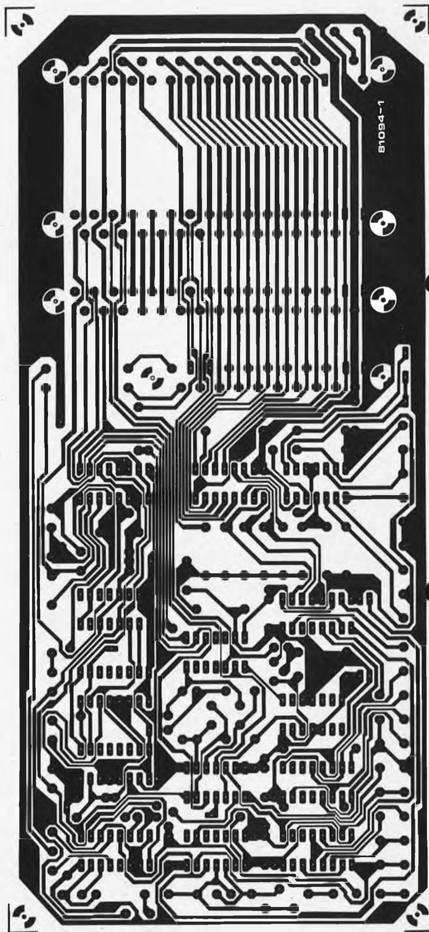
Figure 1. Circuit imprimé et implantation des composants du circuit principal. Les autres circuits
