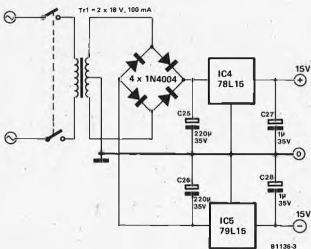
Figure 3. L'alimentation de notre montage. Les condensateurs C27 et C28 aplanissent les dernières ondulations.
