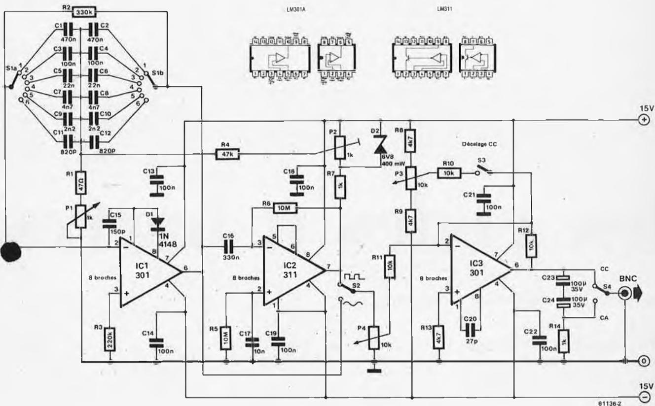
Figure 2. Le schéma de la version définitive. Il sera nécessaire d'utiliser soit un oscilloscope, soit un fréquencemètre pour régler les 6 échelles de référence.
