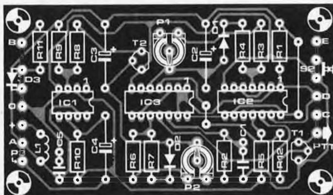
Figure 2. Les deux faces du circuit imprimé: cuivre et composants. Il faudra enfermer le montage dans un boîtier métallique pour éviter les interférences.
