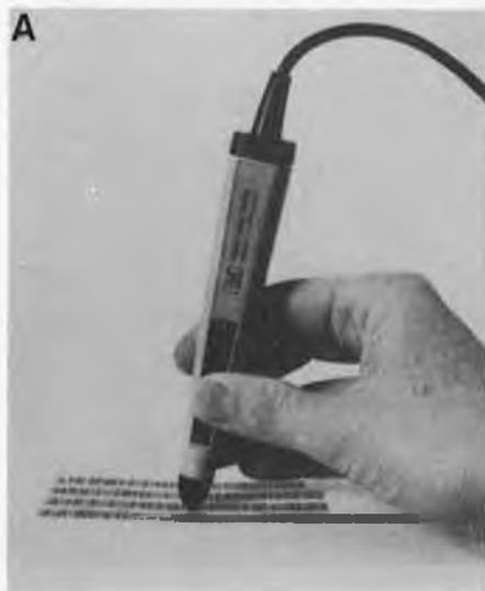
Photo A. Le crayon lecteur HEDS-3000 contient tous les composants nécessaires à la transformation des informations contenues dans un code à barres en signal digital utilisable pour le traitement de données.
