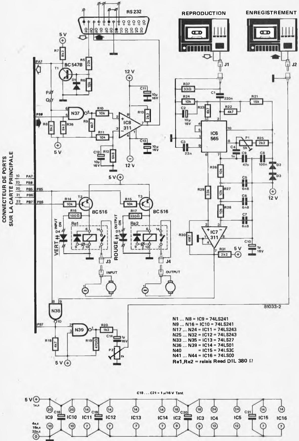
Figure 2. Voici le schéma du circuit de la carte d'interface. Il s'agit d'une part d'un circuit d'adaptation aux normes RS232 et d'autre part d'un circuit de communication avec deux lecteurs de cassettes.
