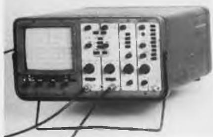
Non seulement l'appareil entre dans la classe des oscilloscopes de 40 à 50 MHz pour la visualisation des phénomènes rapides, mais il possède une véritable double base de temps retardée et étalonnée pour en faire l'analyse détaillée.
