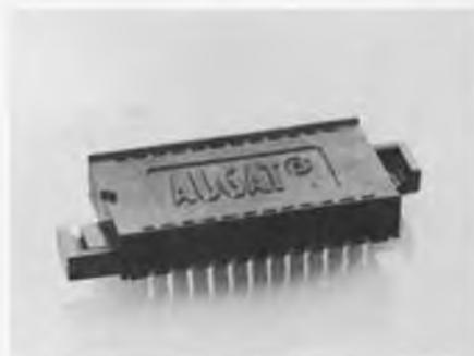
Les contacts, spécialement conçus, Cu/Be étamés ou sélectivement dorés, demandent une force d'insertion et d'extraction inférieure d'un dixième au moins à celle que requièrent les supports standards.
