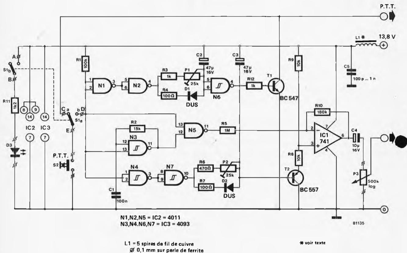
Figure 1. Schéma du gong dql. Il est hors fonction sur ce dessin.
