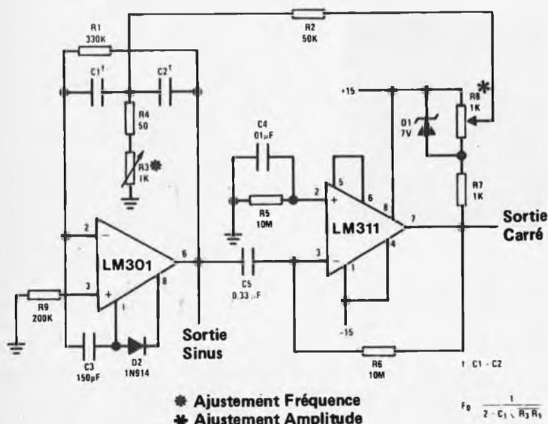
Figure 1. L'idée de base de notre boîte à signaux. L'échelle des fréquences va de 18 Hz à 50 kHz.
