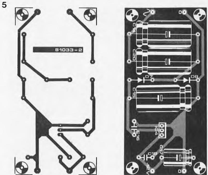
Figure 5. Voici le dessin de circuit imprimé que nous proposons pour le circuit d'alimentation en -12 V.
