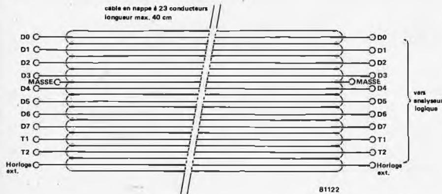
Figure 7. Ce schéma vous montre comment réaliser les mises à la masse du câble de mesure. Les différentes lignes de masse sont reliées entre elles, à l'entrée et à la sortie du câble de mesure.
