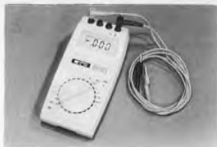
Le CDA 650 dispose de nombreux accessoires: sonde THT 30 kV, shunts 10 et 100 A, pinces transformateurs 150 et 1000 A, ceinture antichoc, gaine de transport, chargeur de batterie.
