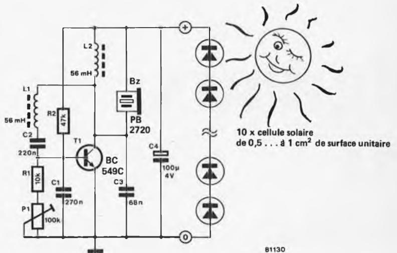
Figure 1. Nous avons pensé que ce schéma correspondrait parfaitement à un réveil automatique à compensation météorologique.
