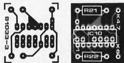
Figure 1. Ce petit circuit imprimé est destiné à être enfiché à la place de l'IC 10 original de la carte principale.
