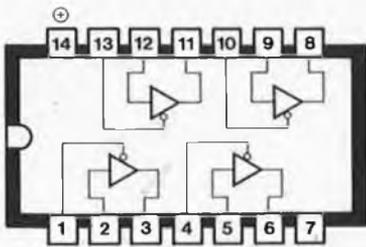
QUADRUPLE 2-INPUT NAND SCHMITT TRIGGER
