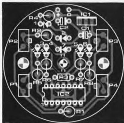
Figure 3. Le dessin du circuit imprimé a été conçu de celle sorte qu'il s'adapte aux boîtes de conserve. D7, la LDR et le câblage sont soudés côté cuivre.
