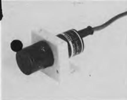
Un potentiomètre de réglage de sensibilité et un voyant de fonctionnement permettent un ajustement précis de la détection. Les alimentations sont directement de 90 à 250 VAC 50/60 Hz ou de 10 à 40 VDC aussi bien en version normalement ouverte ("N.O.") que normalement fermée ("N.F."). Le diamètre extérieur est de 34 mm pour une longueur d'environ 82 mm, la longueur de câble standard étant de 2 m.
