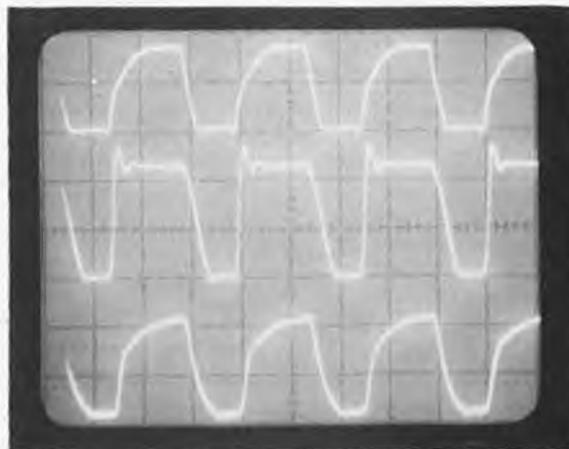
délivré par un circuit TTL est à la limite de ce qu'il faut pour un CMOS.
