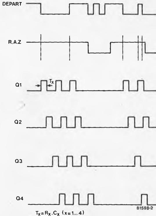
Il n'est pas nécessaire que les constantes de temps RC des temporisateurs soient égales entre elles; des constantes RC différentes produiront des signaux de sortie ayant des durées d'impulsion diverses. Il faut choisir une valeur comprise entre 2 k et 100 k pour les résistances qui déterminent le temps (R1 . . . R4). Si on désire obtenir des durées plus longues il faudra augmenter les valeurs de C1 à C4.
