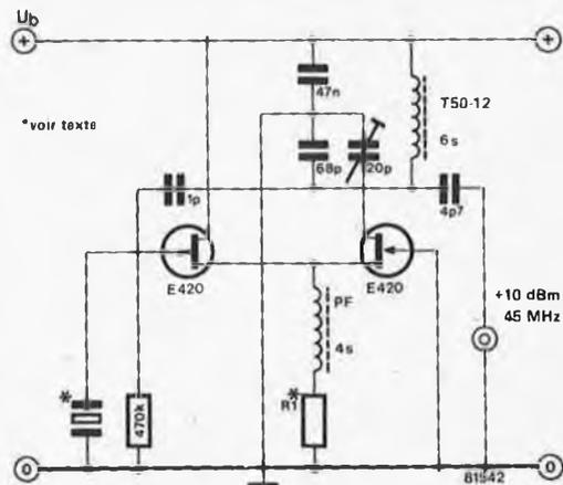
d'oscillateurs en mode parallèle. Pour éviter que le quartz ne se mette à osciller à sa fréquence fondamentale, il nous faudra un circuit d'accord. Il faut de plus que le signe du gain de l'élément actif soit positif, c'est pourquoi il faudra ajouter un enroulement de couplage au circuit d'accord que nous venons de mentionner ci-dessus.
