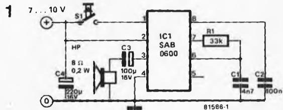
La tension de sortie ressemble à une tension carrée, dont le contenu harmonique est atténué par le condensateur C2. Il est judicieux de monter le haut-parleur dans un boîtier qui contribue à enrichir le timbre par sa résonance. D'autres possibilités peuvent s'avérer intéressantes; comme par exemple monter deux gongs à quelque distance l'un de l'autre, et légèrement désaccordés. On obtient ainsi des effets de battements qui peuvent être très agréables.
