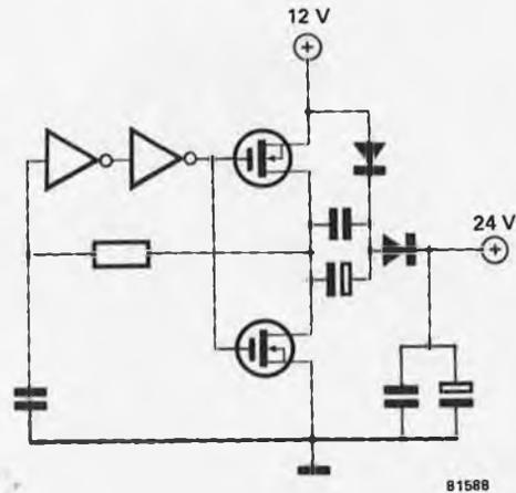
multivibrateur astable avec une sortie de puissance CMOS. La tension carrée, redressée et filtrée, est additionnée à la tension de l'accu. Nous reviendrons là-dessus dans un prochain numéro. **M**
