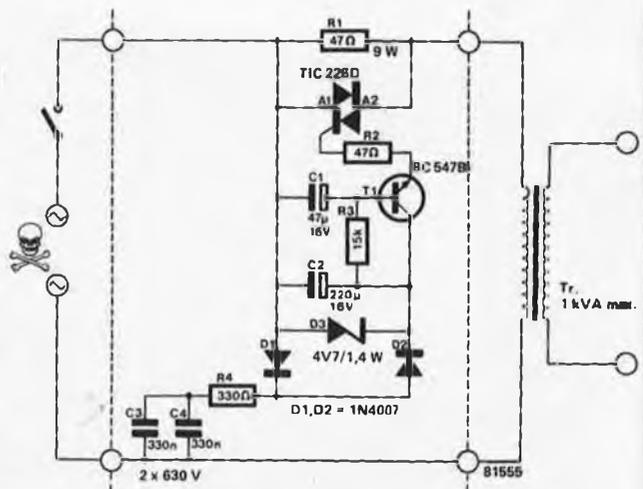
re. Ce n'est que quelques 100 millisecondes plus tard que cette résistance est mise "hors-jeu" si l'on peut dire, par un pontage mis en oeuvre par le triac. Le courant de fermeture retardé arrive par la commande de la gâchette du triac, par l'intermédiaire de T1. La tension secteur, est tout d'abord abaissée par la capacitance de C3/C4, à un point tel, qu'après redressement par D2, et filtrage par C2, on trouve aux bornes de la diode zener D3 une tension continue de 4,7 V.
