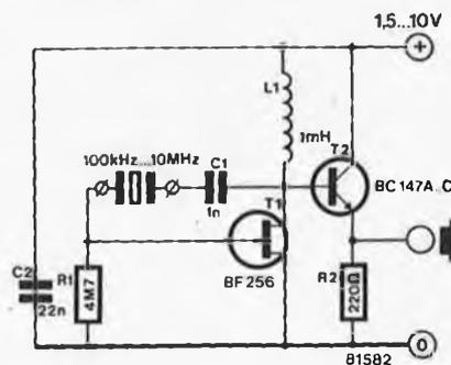
Voici les valeurs exactes des quartz à l'aide desquels le circuit a été testé: 100 kHz, 1 MHz, 4 MHz, 6 MHz, 8 MHz et 10 MHz. Cet oscillateur pourra trouver de nombreuses applications, notamment en raison de la faible tension d'alimentation requise (1,5 V minimum).
