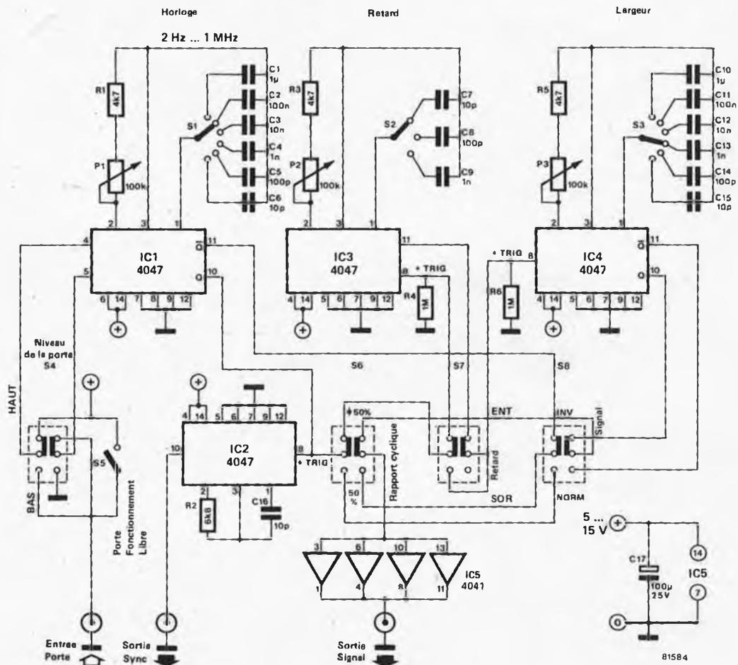
seur S5 est fermé et que le commutateur S1 se trouve en position "Haut", le circuit intégré IC1 fonctionne librement, il fonctionne donc en générateur de signaux rectangulaires. Si S5 est ouvert, il sera possible de déclencher IC1 à l'aide d'un signal envoyé à la prise "Entrée Porte". On pourrait dire que IC1 est poussé par ce signal. Cela permet en outre d'adapter le niveau du signal de déclenchement, en inversant S1, à la polarité d'entrée adéquate qu'il faudra présenter à la broche 4 ou 5.
