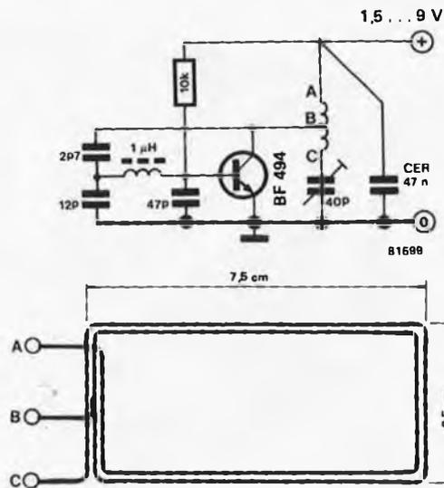
antenne sur circuit imprimé:
