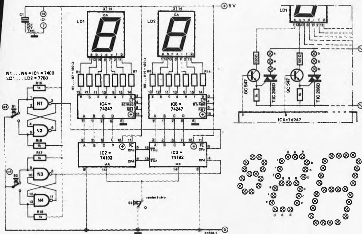
laisse quelque peu à désirer. C'est pourquoi nous proposons le schéma d'un circuit d'affichage réalisé à l'aide de petites ampoules 220 V. Pour chaque segment de "a" à "g", et pour chaque afficheur, il faut un triac et un transistor de commande. Les triacs devront pouvoir être déclenchés par un courant de "gate" de 5 mA. Si l'on désire réaliser ces maxi-afficheurs, on remplacera IC4 et IC5 par des 74248. Par ailleurs, tous les
