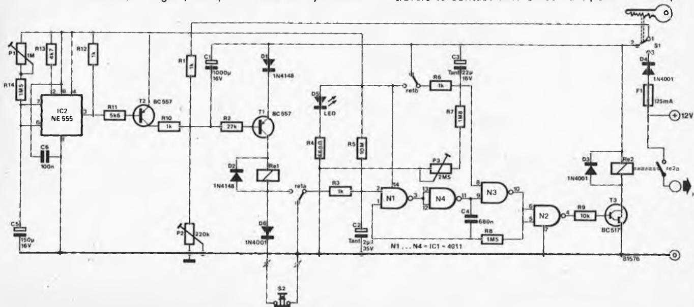
teur de porte de la voiture. Aussi a-t'il fallu prévoir D6 pour éviter que le plafonnier du véhicule ne reste allumé. Quelque soit la vélocité du cambrioleur, il aura beau ouvrir et refermer la porte très rapidement, le système d'alarme aura été déclenché. Le deuxième contact du relais ferme les circuits de charge pour C2 et C3 et met D5 au potentiel positif indiquant ainsi que l'alarme est active.
