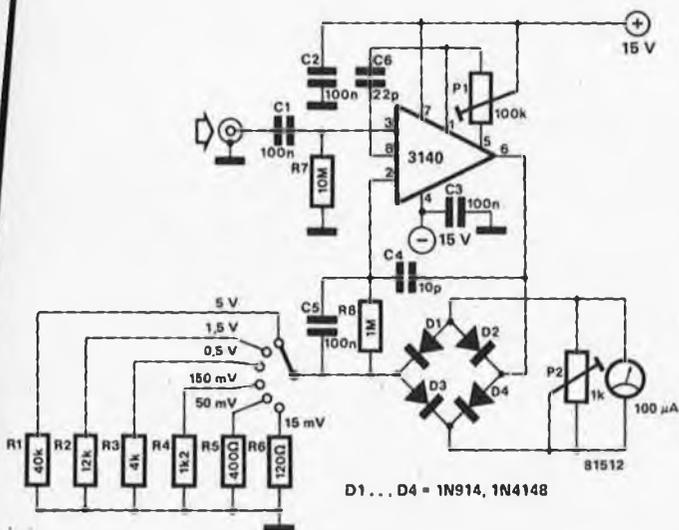
publié ici. Il convient pour des mesures de tensions alternatives dans une plage de fréquences comprise entre 100 Hz et 500 kHz. L'impédance d'entrée est de  $10M\Omega$  sur toute l'étendue de la plage grâce à l'utilisation d'amplis op à entrée MOSFET. La sensibilité est de 15 mV dans la plus petite plage de mesure pour une déviation maximale de l'aiguille de l'instrument de  $100\mu A$ .
