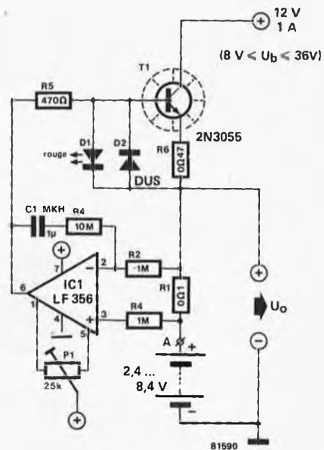
La tension de sortie sera égale au nombre de cellules multiplié par 1,2 volt. Si on travaille avec moins de deux cellules et une tension d'alimentation inférieure à 8 volts, le chargeur d'accus NiCad ne fonctionne plus. Il faut également veiller à ce que la tension d'alimentation soit toujours supérieure de quelques volts à la tension des accus NiCad. La tension maximale d'alimentation est de 36 volts. Tant que l'on reste dans ces limites, on pourra choisir la tension de son cœur. ■
