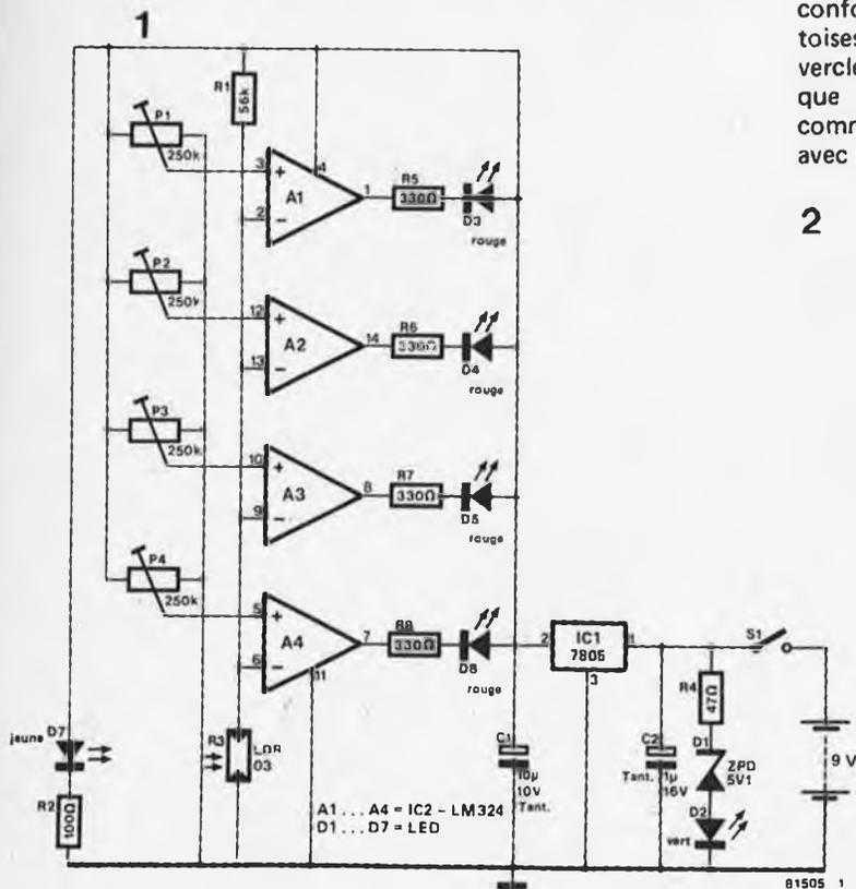
Figure 1. Le schéma de ce pèse-lettres ne comporte que deux circuits intégrés et quelques composants périphériques, dont les LED indiquant le poids. Le capteur opto-électronique est constitué de la LED D7 (jaune) et de la LDR R3.
