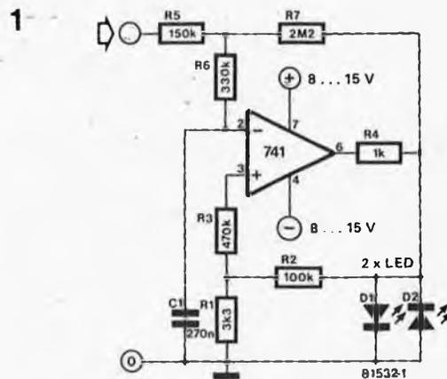
à R5 (que nous imaginons au potentiel de la masse jusqu'ici) une tension continue, le niveau de la tension continue est décalé par la tension de contre-réaction. Lorsque ce niveau est suffisamment élevé pour que la tension aux bornes de C1 tombe en dehors du seuil de basculement du trigger de Schmitt, l'oscillateur s'arrête, et une des deux LED reste allumée.
