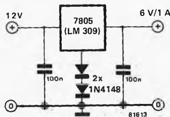
relativement difficile à obtenir dans le commerce. Les postes de radio cassettes ont, en particulier, une tension de fonctionnement qui se situe aux environs de 7,5 volts. Dans ce cas, on ajoutera trois ou quatre diodes à la broche centrale du 7805, au cas où il serait impossible de trouver un 7808 chez
