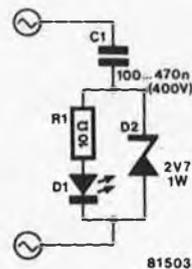
Au passage brutal à la demi-période positive, D2 permet d'éviter que la tension aux bornes de la LED D1 et de la résistance R1 ne dépasse 2,7 volts. Si on se sert d'une diode ordinaire à la place de cette diode zener (ce qui nous faisons lors de notre montage initial), le risque de voir la diode partir en fumée existe.
