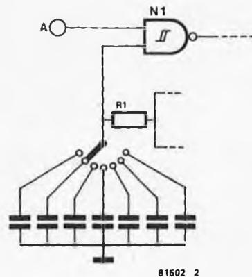
Du fait de la présence de la résistance R1, qui sert de garde-fou dans le cas de la mise en butée du potentiomètre P1, il n'est pas possible de régler le rapport cyclique à 100%; la gamme de réglage est "limitée" de 2 à 98%: ce n'est quand même pas si mal.
