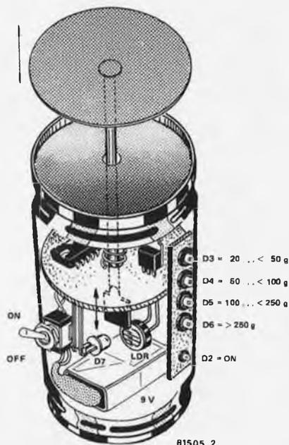
Figure 2. Vue d'ensemble de la mécanique du pèse-lettres électronique. C'est la pointe de la recharge pour stylo à bille (plus ou moins transformée) qui commande le passage de la lumière entre la LED et la LDR. Comme on voit, la "mise en boîte" du mois de Janvier de cette année n'a pas fini de faire parler d'elle.
