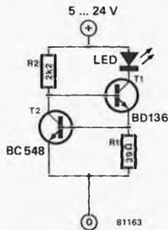
stable et précisément définie. Ce qui n'est plus le cas avec le montage proposé ici. Il permet en effet de maintenir constant le courant qui alimente la LED pour une plage de tensions s'étendant de 5 V à 24 V. Ce qui permet d'alimenter des LED avec une tension d'alimentation très instable.
