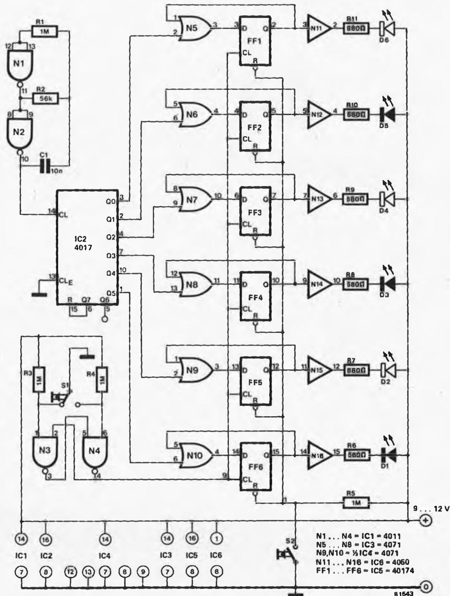
La LED correspondante s'éteint à ce moment. La réaction de la sortie Q de la bascule sur la porte OU à l'entrée D veille à ce que lorsqu'une bascule est initialisée, elle le reste, même après d'autres impulsions d'horloge. Du fait que la sortie Q6 du compteur est en l'air, il se peut que le premier coup fasse "fausse queue". Si l'on veut supprimer cette éventualité, on relie l'entrée "reset" du compteur à Q6 au lieu de Q7, comme c'est le cas ici.
