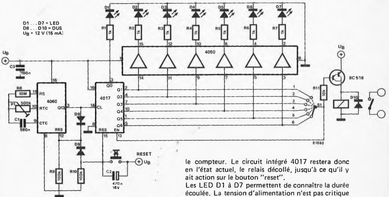
tionner une durée allant de 1 à 6 heures. Dès que le contact principal de S1 transmet un "1", le relais décolle (ce qui entraîne la coupure du courant, et de ce fait l'extinction de la chaîne); par l'intermédiaire de l'entrée autorisation (EN= Enable, broche 13 de IC 4017), on empêche l'impulsion d'horloge suivante d'avoir un effet quelconque sur
