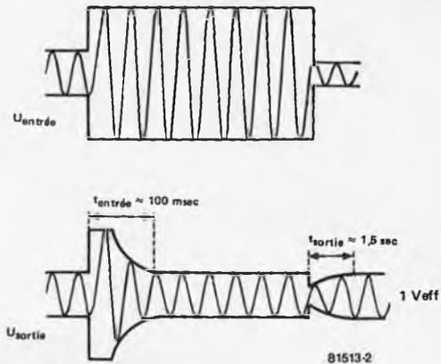
but en rendant l'atténuation dépendante de la plus grande amplitude rencontrée dans le signal d'entrée. Pour ce faire, on mesure l'amplitude du signal de sortie. Dès que celle-ci dépasse une valeur de  $1 V_{eff}$ , l'atténuateur réglable (IC1c) reçoit un signal de commande via C7 et R13.
