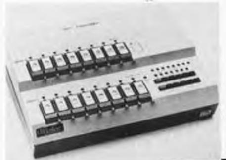
Il réalise les fonctions suivantes: programmation, test de virginité, contenu de la mémoire RAM avec les mémoires en programmation, contenu de la RAM avec le contenu d'une bande perforée, transfert des données de la mémoire RAM vers une imprimante TTY.
