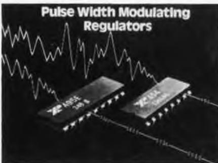
L'oscillateur interne peut facilement être mis hors fonctionnement et être couplé à une fréquence extérieure.
