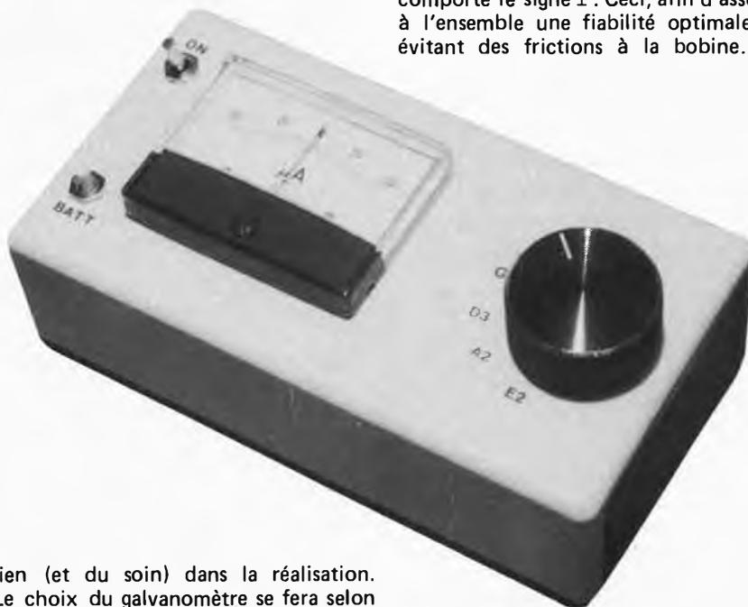
sien (et du soin) dans la réalisation. Le choix du galvanomètre se fera selon des critères de qualité... et non de prix. On commence à trouver des commutateurs à glissière rectilignes (comme les potentiomètres du même type) qui peuvent avantageusement remplacer les traditionnels commutateurs rotatifs à galettes. Si vous en trouvez, n'hésitez pas; c'est plus beau, plus pratique et moins encombrant!
