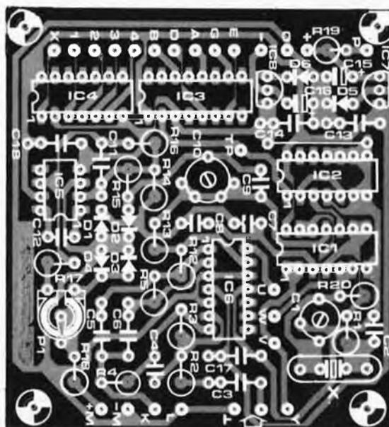
Figure 5. Dessin de circuit imprimé avec sérigraphie pour l'implantation des composants du diapason.
