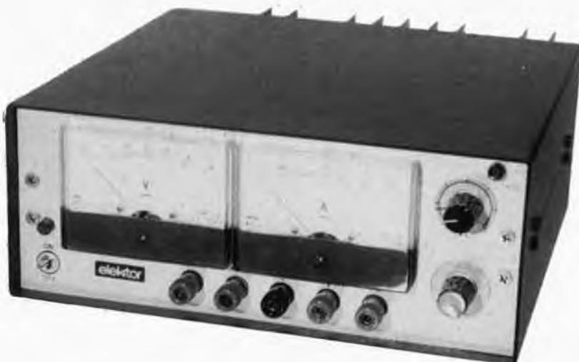
tive au secondaire du transformateur. Pour un transformateur de 33 V, on peut compter avec une tension de sortie maximale d'environ 35 V. Pour le courant, on calcule que le transformateur doit délivrer un courant alternatif d'environ  $\sqrt{2}$  fois le courant de sortie maximal. Pour un courant de 3A, le transformateur devra en délivrer 4. Le nombre de transistors à mettre en
