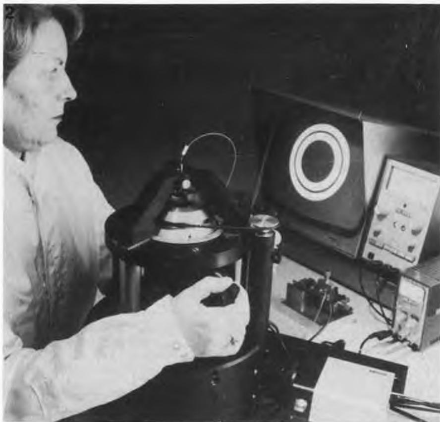
Photo 2. Grâce à la méthode de contrôle optique, on peut voir d'un coup d'œil que l'âme de la fibre est exactement dans l'axe du tour. Il faut pour cela que les deux anneaux affichés sur le moniteur soient exactement concentriques. De cette manière, un opérateur exercé peut centrer l'âme avec une tolérance de 0,05  $\mu\text{m}$ .
