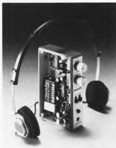
Figure 2. De concert avec le TDA 7000, le TDA 3810 (au centre de la figure) permet de construire un petit récepteur pseudo-stéréo de dimensions fort réduites.
