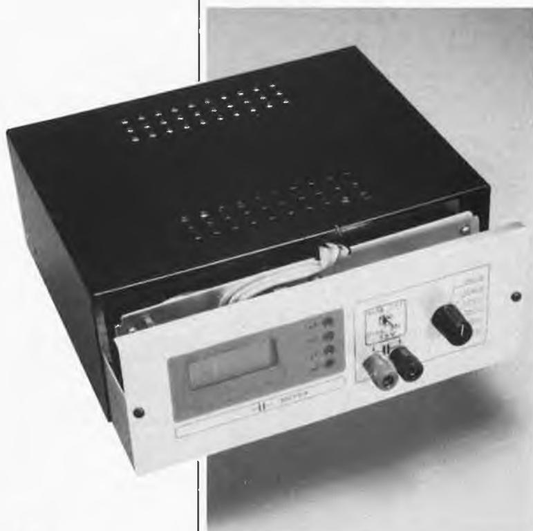
constater une erreur pouvant atteindre quelques pour cent. Si on regarde le schéma, on voit que le point "broche 6 de IC3" est en contact avec le point de connexion central de S1a; on peut ainsi tirer un fil depuis ce point-là vers une borne spéciale baptisée "varicap", sur la face avant du capacimètre.
