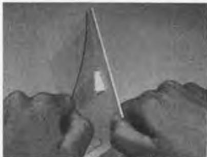
lique, matériau stable qui conserve ses propriétés visco-élastiques dans le temps, reste insensible à l'humidité, a une excellente tenue en extérieur et une grande résistance aux chocs thermiques.
