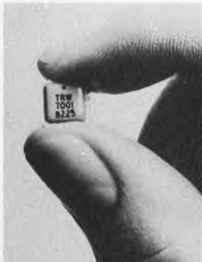
En boîtier céramique/epoxy, ils sont conformes au standard JEDEC pour les boîtiers de "type C", et ont des performances supérieures à la caractéristique H de la norme MIL-R-83401.
