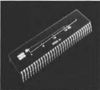
Le TMC 2010 dissipe 10 fois moins de puissance que le TDC 1010, et exécute une multiplication/accumulation  $16 \times 16$  en 165 ns (6 MHz). Le format d'entrée peut être spécifié complètement à 2 ou magnitude non signée, et donne un produit en double précision sur 32 bits. Les produits peuvent être accumulés jusqu'à 35 bits.
