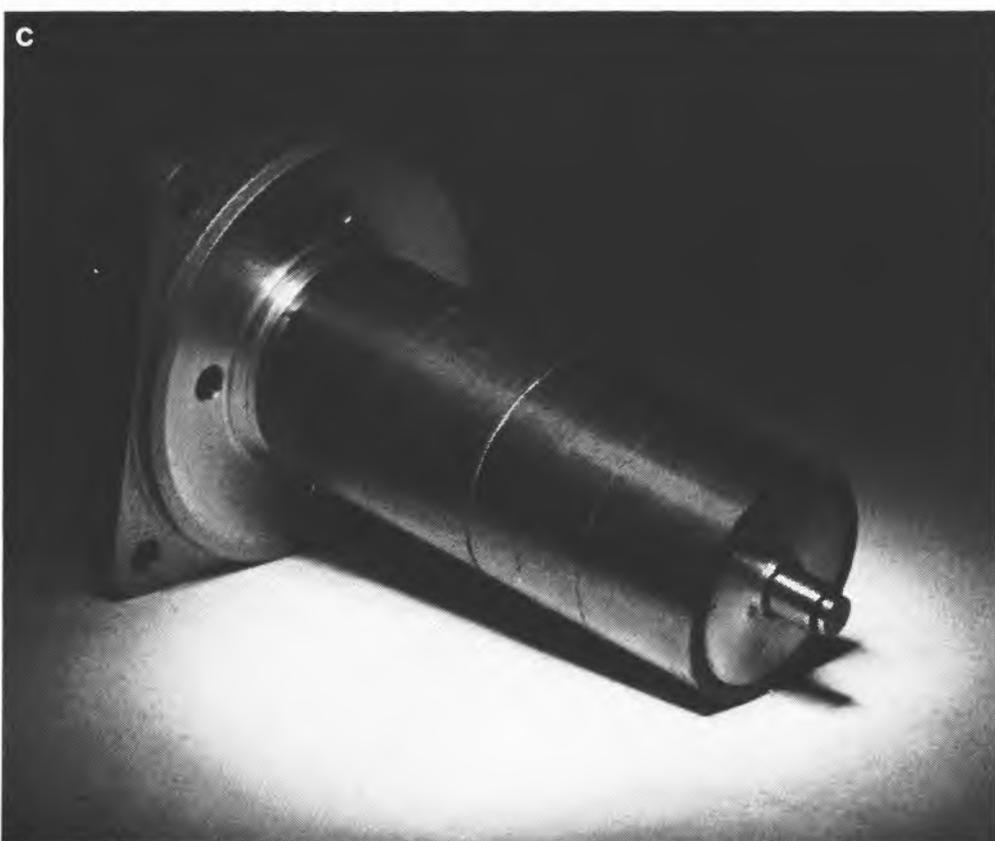
l'aimant permanent du rotor induit une tension dans le stator. Pour permettre une vitesse de rotation plus élevée, on fait appel à des moteurs pas à pas dont le rotor est en fer doux. Celui-ci compte moins de pôles que le stator, lequel est toujours unipolaire dans ce cas-là (figure 4). Les enroulements du stator sont montés les uns derrière les autres (séquentiel).
