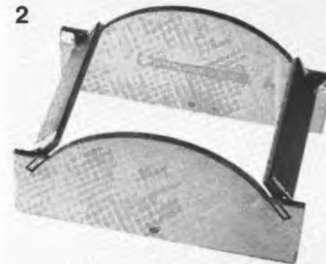
Photo 2. Vue illustrant la réalisation mécanique de la partie optique du montage sur laquelle viendra prendre place la lentille de focalisation.
