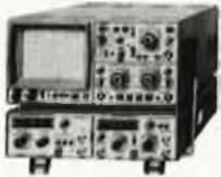
HM 8001. Module de base avec alimentation pour recevoir 2 modules simultanément.
