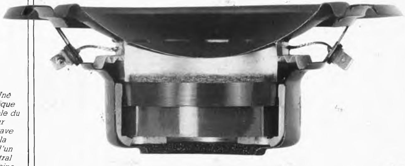
Figure 1. Une caractéristique remarquable du haut-parleur médium grave 17W75 est la présence d'un aimant central dans la bobine.
