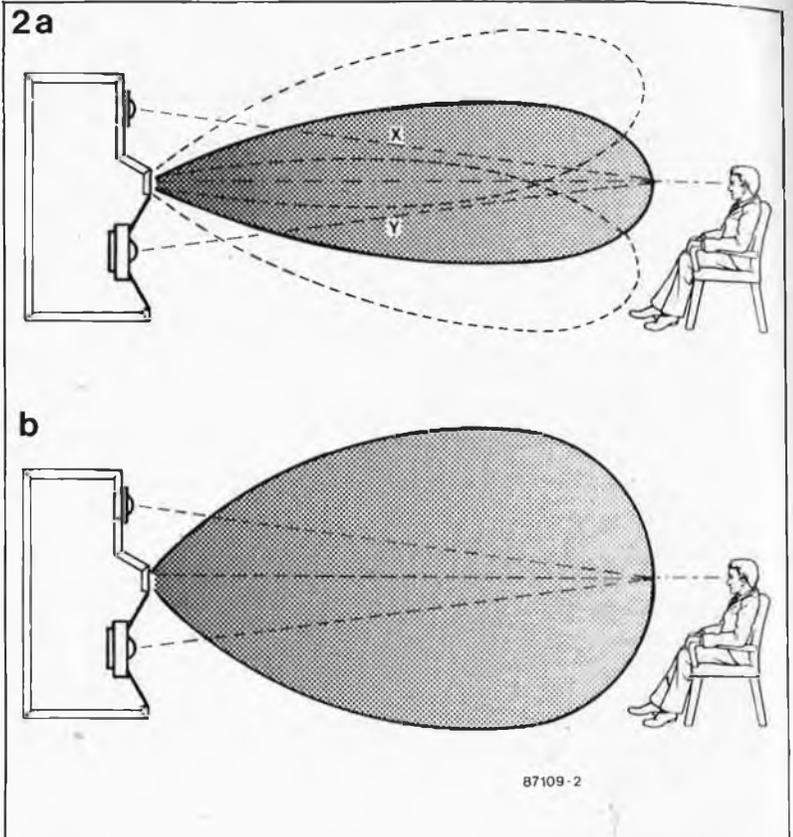
**Figure 2. Le comportement rayonnant d'un filtre soustractif est notablement meilleur dans les domaines des fréquences de recouvrement. Le lobe de la figure 2a est celui d'un filtre conventionnel, le lobe de la figure 2b celui du filtre soustractif.**
