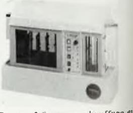
Gravure 2 faces avec chauffage et rinçage, transport automatique des circuits. Format 460 x 900 mm.
