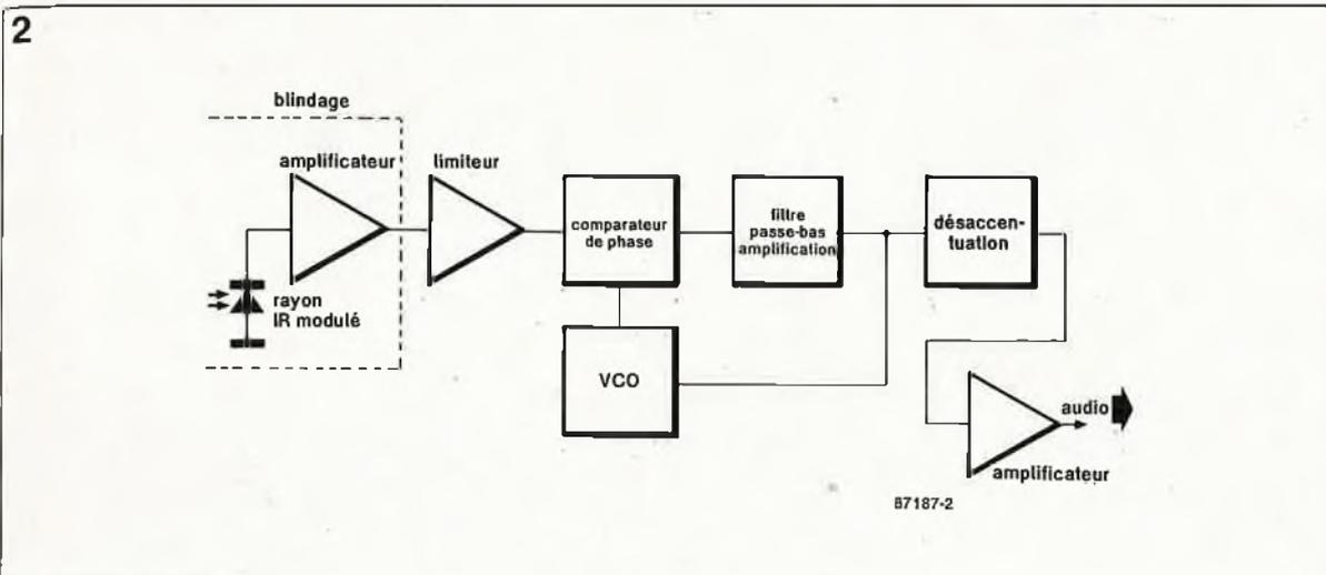
Figure 2. Le synoptique du récepteur est plus complexe, complexité due en particulier au détecteur subdivisé en trois blocs: le comparateur de phase, le VCO et le filtre passe-bas.
