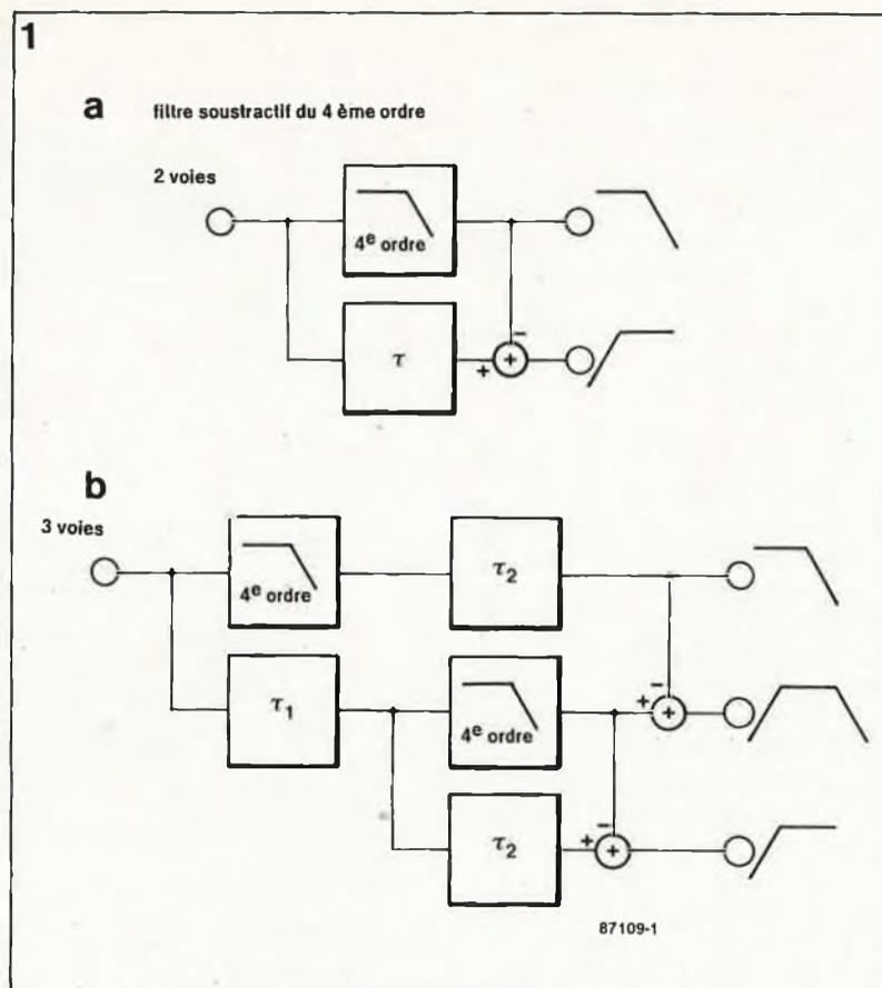
Figure 1. Synoptique d'un filtre soustractif chrono-compensé en version à 2 voies (1a) et en version à 3 voies (1b).
