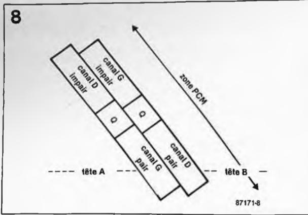
**Figure 8. Schématisation de l'entrelacement dans la zone PCM. Q est une zone tampon entre les zones de données.**
