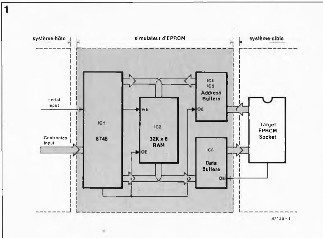
tème-cible vers le simulateur. Là, le bus d'adresses est relié à un tampon commandé exclusivement par le simulateur, et le bus de données est relié à un tampon commandé exclusivement par le système-cible. De l'autre côté de ces deux tampons se trouve un bloc de 32 Koctets de mémoire vive dans laquelle le microprocesseur du simulateur (ici un 8748H) place les données que lui envoie le système-hôte sur son interface sérielle ou parallèle. Pour éviter
