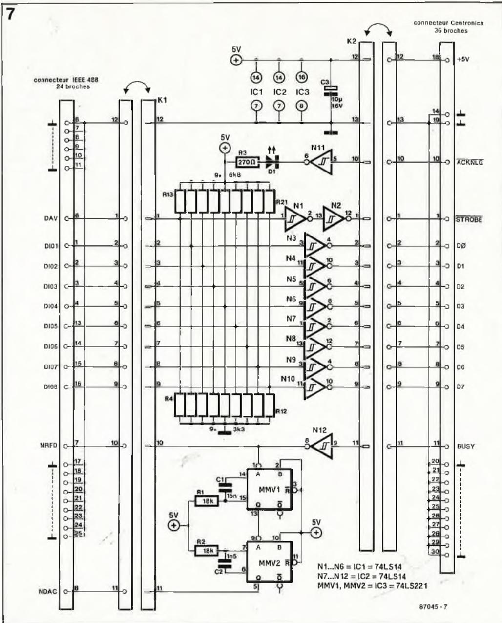
**Figure 7.** Pour contourner l'obstacle du signal ACKNLG dont la chronologie dans le protocole Centronics est mal définie, le signal NDAC est produit par une cascade de monostables déclenchés par le signal BUSY inversé. Les lignes de l'interface IEE sont à collecteur ouvert, d'où la présence indispensable des résistances R4...R21.
