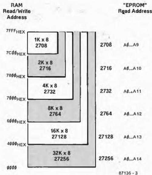
Figure 3. Lorsque l'EPROM simulée n'est pas une 27256, elle est toujours adressée "tout au fond" du bloc de 32 K. C'est pourquoi il faut toujours veiller à ce que sur le système-cible les lignes d'adresses non utilisées soient à un niveau logique haut ou indéfini.
