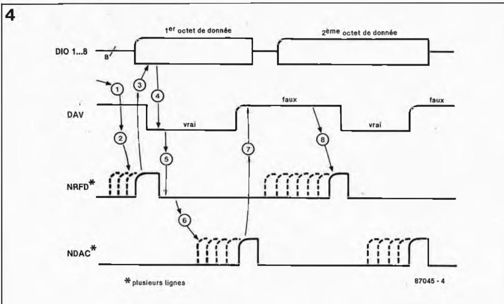
**Figure 4. Chronogramme des signaux d'acquittement.** En (2) et en (8), les LISTENERS se déclarent prêts les uns après les autres en relaxant leur ligne NRFD. En (5), aucun appareil n'a encore pu traiter la nouvelle donnée. En (6) ils la chargent les uns après les autres et le signalent en relaxant leur ligne NDAC. En (7) la donnée n'est plus disponible, et en (8) tous les appareils sont prêts à accepter la deuxième donnée.
