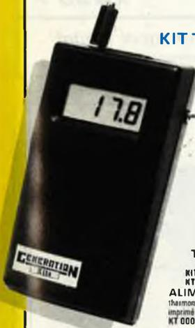
Le kit comprenant : le circuit imprimé percé sérigraphié, les composants passifs (1 sonde Siemens KTY 10), les composants actifs, commutateurs, connecteurs, supports fil, soudeuse et pile 9 V
