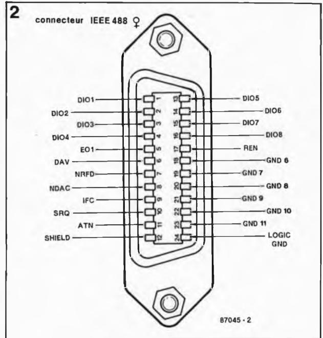
Les noms des signaux et le brochage des connecteurs apparaissent sur les figures 1 et 2. Les 16 signaux peuvent être répartis en un groupe de 8 lignes de données, un autre groupe de 3 signaux d'acquiescement et enfin un groupe de 5 lignes de commande, comme le montre la figure 3.
