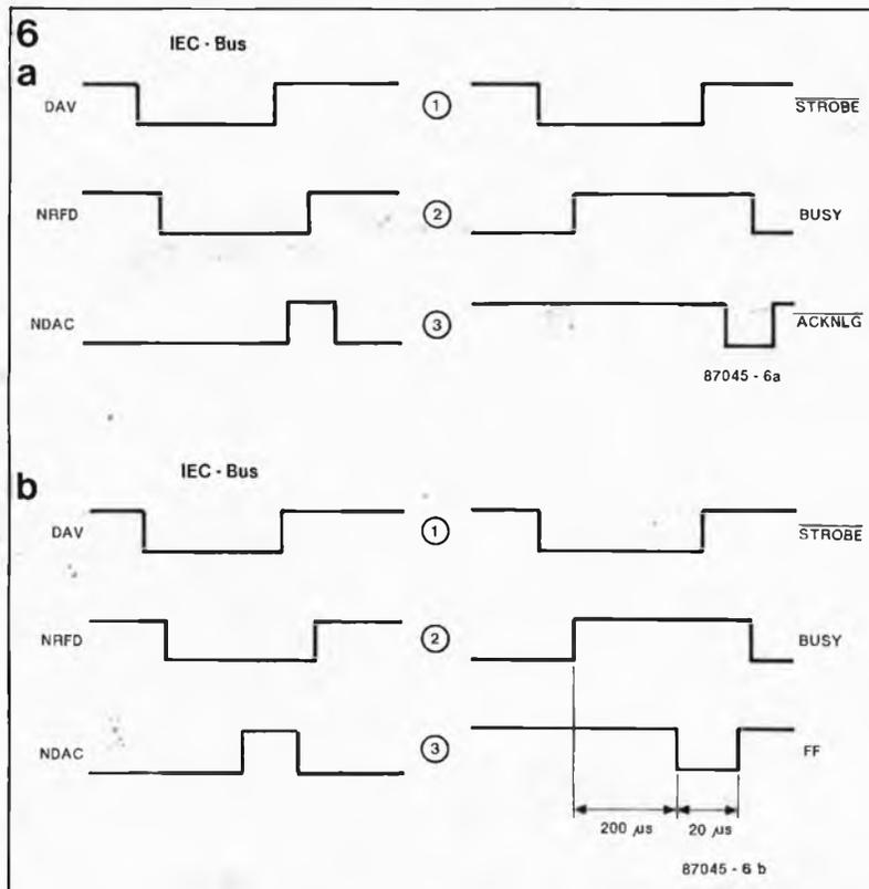
Figure 5. La chronologie des signaux d'acquittement de l'interface Centronics n'est pas définie avec rigueur. On trouve trois types d'imprimantes, caractérisés par la position particulière du signal ACKNLG par rapport au signal BUSY.
