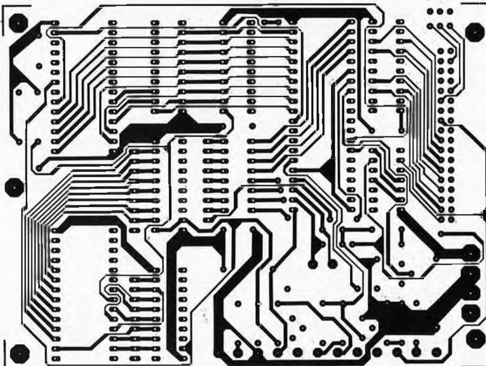
**Figure 5. La platine du simulateur d'EPROM RAMSAS est à double face avec trous métallisés. L'élégance quasi-artistique du tracé est le fait du savoir-faire de notre bureau d'étude des circuits imprimés.**
