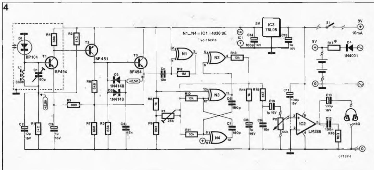
rythme de la fréquence de la porteuse auxiliaire, la base de T1 est tirée vers la masse à ce rythme. Pour ne laisser passer que les signaux ayant la fréquence de la porteuse auxiliaire, l'entrée comporte un filtre passe-bande constitué par L1 et C1 montés en réseau parallèle. Ce type de réseau est caractérisé par une résistance équivalente (une impédance) faible sauf à une certaine fréquence, appelée fréquence de résonance, que l'on peut calculer à l'aide de la formule suivante:
