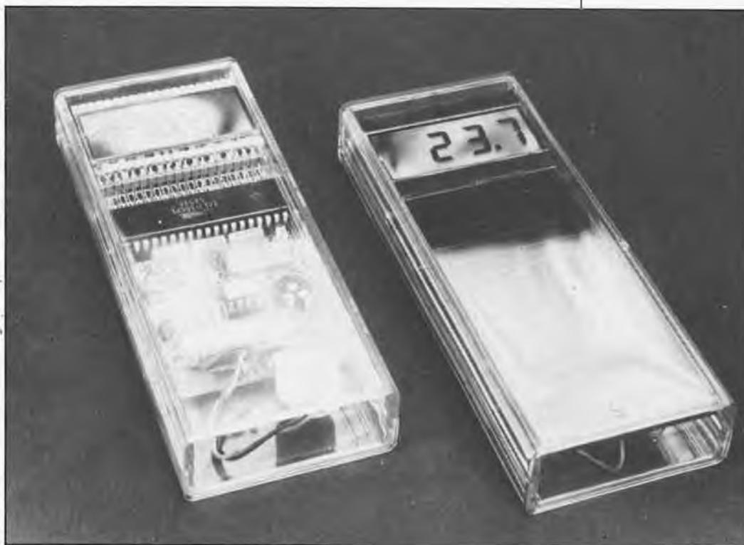
3 °C! Au voisinage de la température ambiante (25 °C), la dérive n'est que d'un quart de degré centigrade. Sa consommation intrinsèque est très faible; le courant qui circule à ce niveau passe pour l'essentiel par la résistance de polarisation de la sortie. A propos de températures, ne perdez pas de vue le fait qu'en-dessous de -10 °C, les cristaux liquides gèlent...
