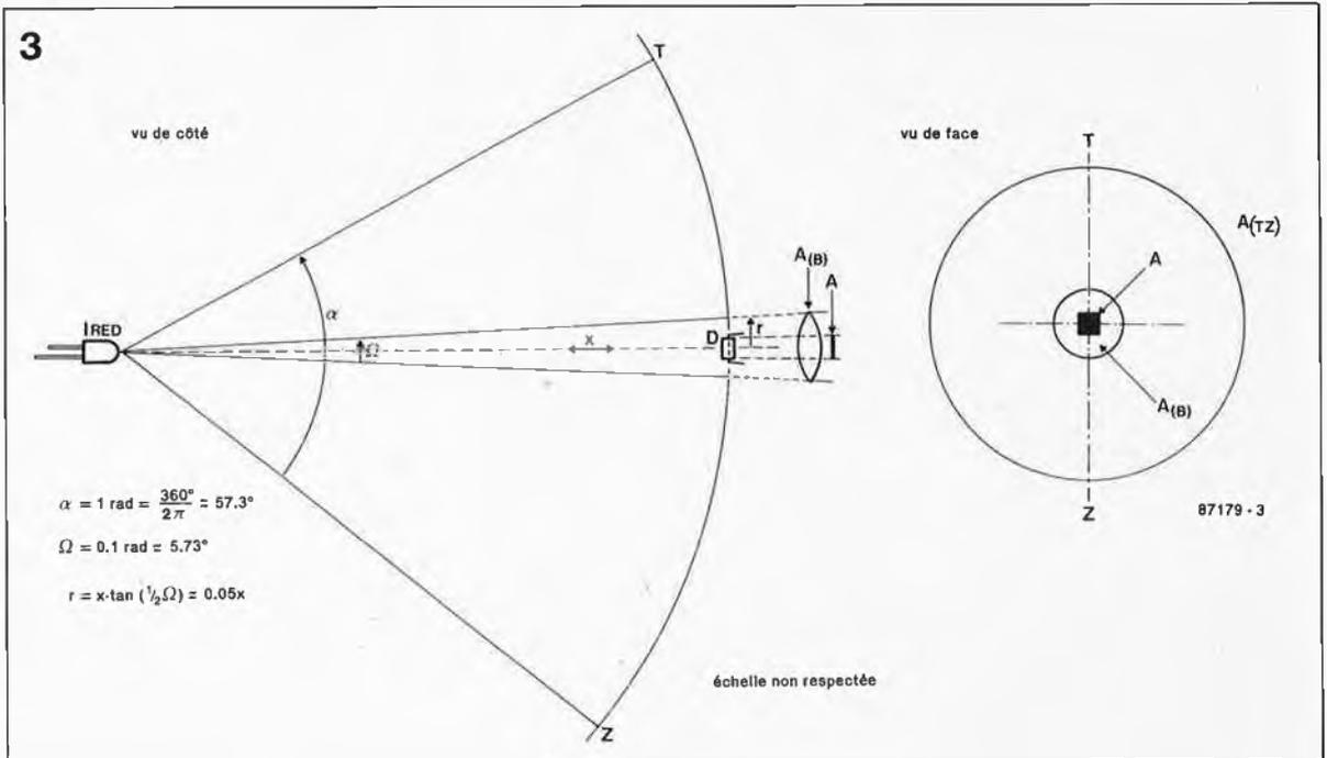
Figure 3. La distance théorique couverte par le système de transmission est la longueur  $x$  du faisceau conique de lumière infrarouge.
