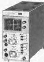
DÉVIATION VERTICALE: Simple trace, temps de montée 35 nano-S, atténuateur 10 positions (10 mV/div. à 5 V/division), impad. d'entrée directe: 1 M $\Omega$ /40 pF avec sonde 1/1 et 10 M $\Omega$ /25 pF avec sonde 1/10.
