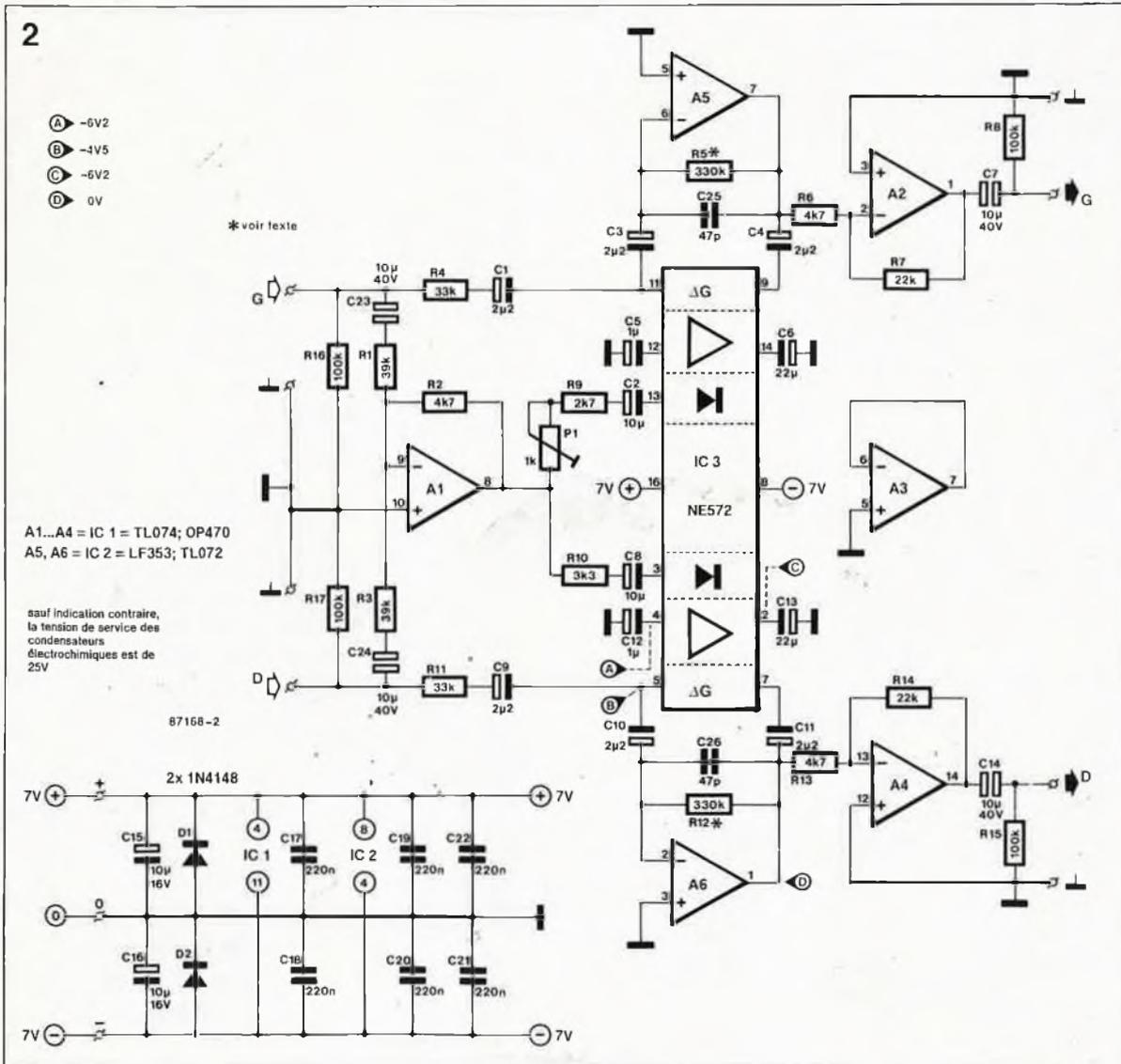
**Figure 2. Schéma du compresseur stéréo.**
