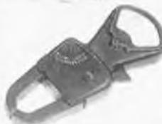
Mesures en alternatif 50 Hz, 0 - 10 - 25 - 100 - 500 Amperes en 4 gammes, 0 - 300 - 600 Volts, 2 gammes
