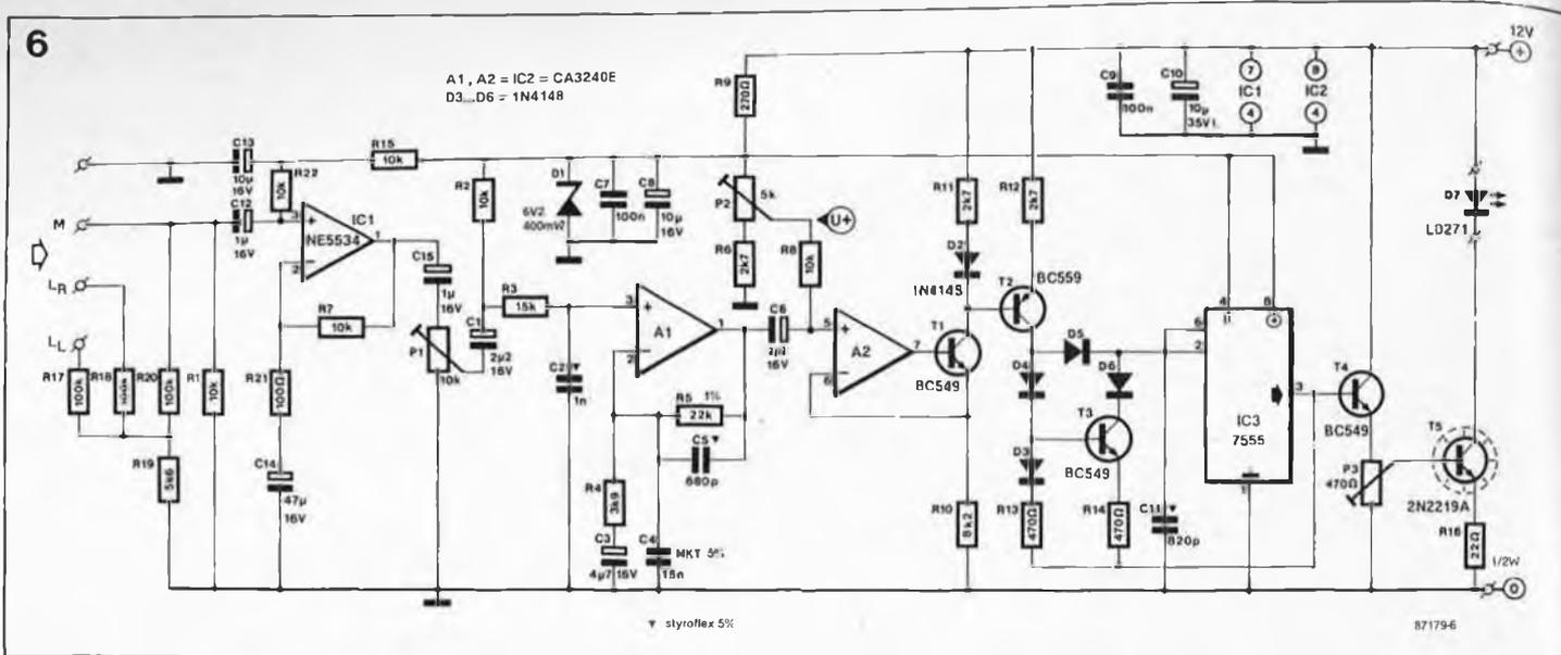
**Figure 6. Schéma complet de l'émetteur FM infrarouge.**
