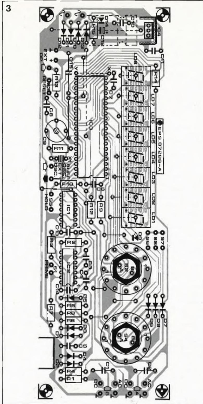
**Figure 3. Représentation de la sérigraphie de l'implantation des composants de la platine conçue pour le fréquencemètre. Ses dimensions sont étudiées de manière à en permettre l'implantation directe dans un boîtier du type de celui représenté en début d'article.**
