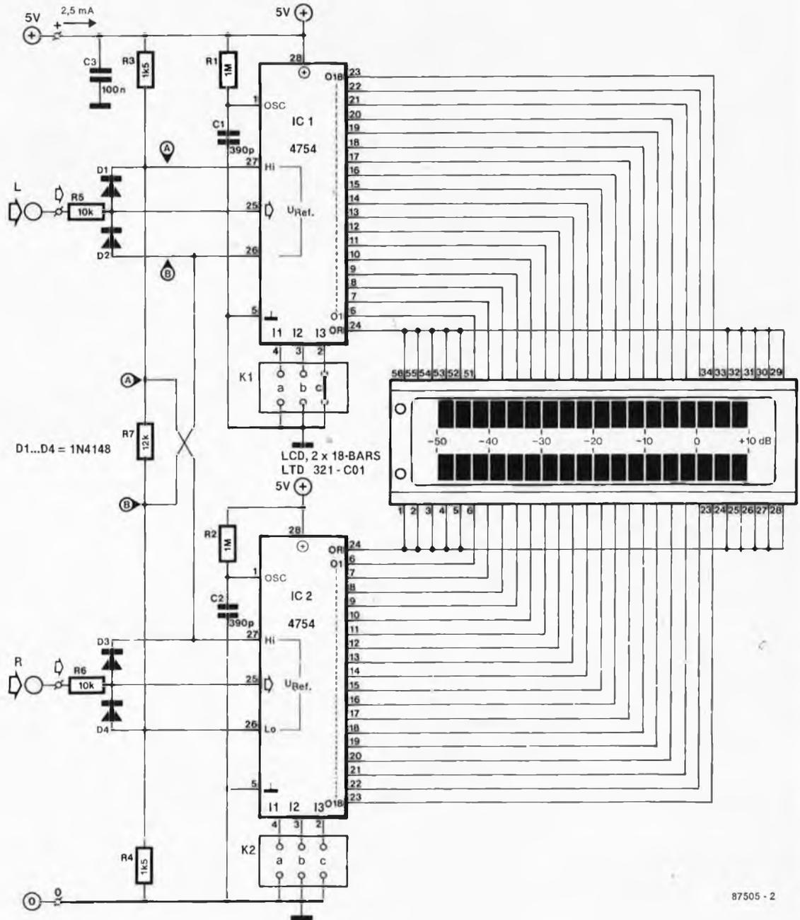
Figure 2. Electronique de l'afficheur LCD linéaire. De gauche à droite (et de haut en bas), les connexions de l'alimentation et des signaux d'entrée, suivies du dispositif de protection contre les surtensions, des circuits de commande de l'afficheur LCD et de celui (tout à fait à droite).
