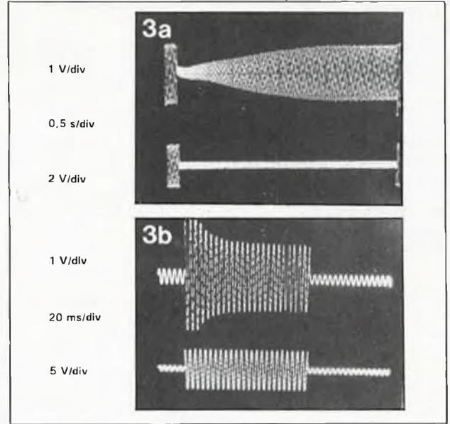
**Figure 3. Comportement dynamique du compresseur stéréo:**
