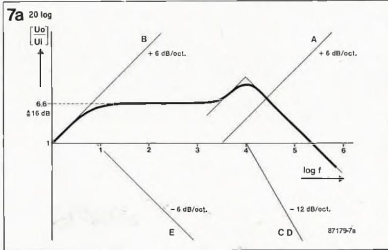
Figure 7. Courbes de réponse théorique (a) et pratique (b) de l'émetteur. La courbe B de la figure 7b donne la réponse générale du système DELIRE.
