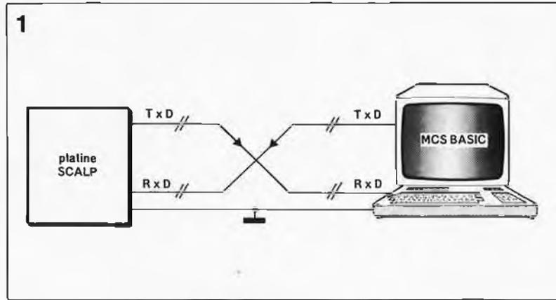
Figure 1. Liaison sérielle établie entre le système SCALP et une console vidéo quelconque.
