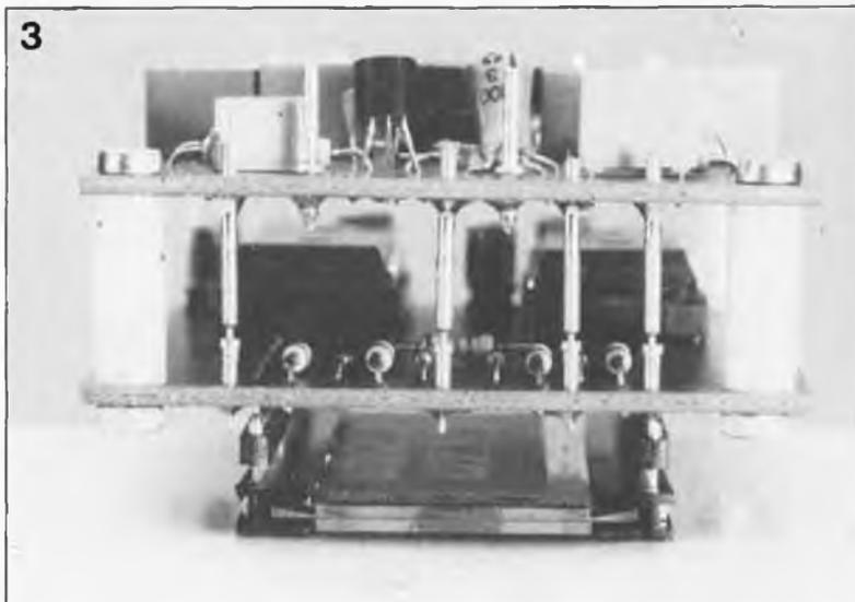
Figure 3. Les quatre conducteurs électriques permettent une interconnexion aisée des deux circuits imprimés.
