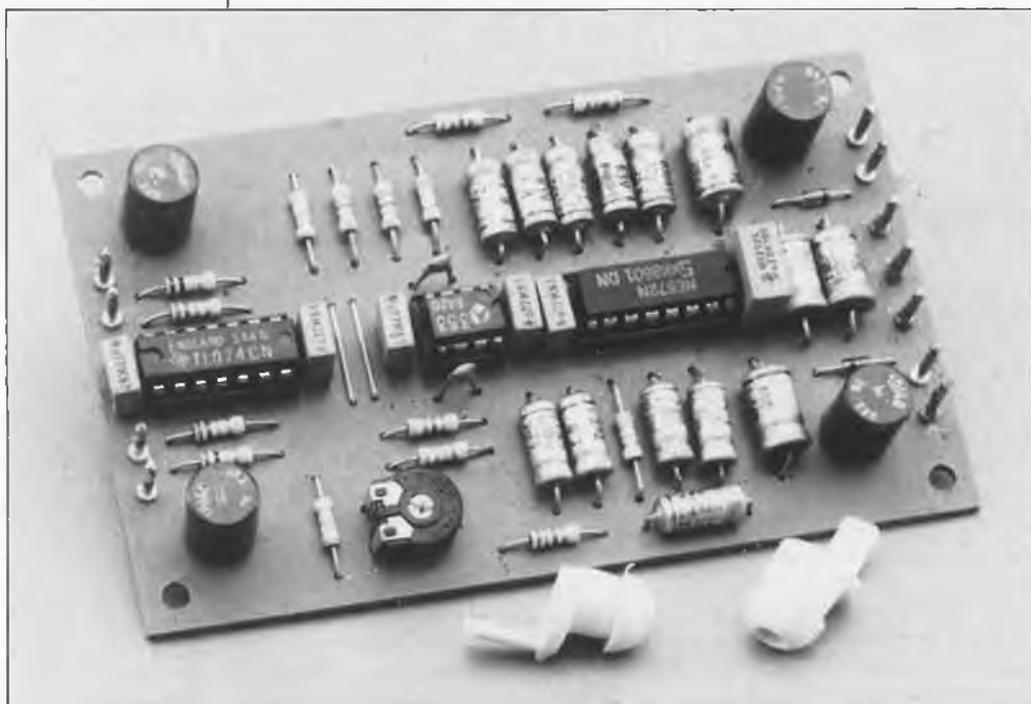
trée du potentiomètre. Les condensateurs C5/C6 et C12/C13 définissent les temps de réponse et de chute de la régulation (voir **figure 3**). Les potentiomètres " $\Delta G$ " sont connectés entre les broches 11 et 9, et 5 et 7 (entrée et sortie respectivement). Associée à A5 (et A6), cette partie du circuit fonctionne en amplificateur.
