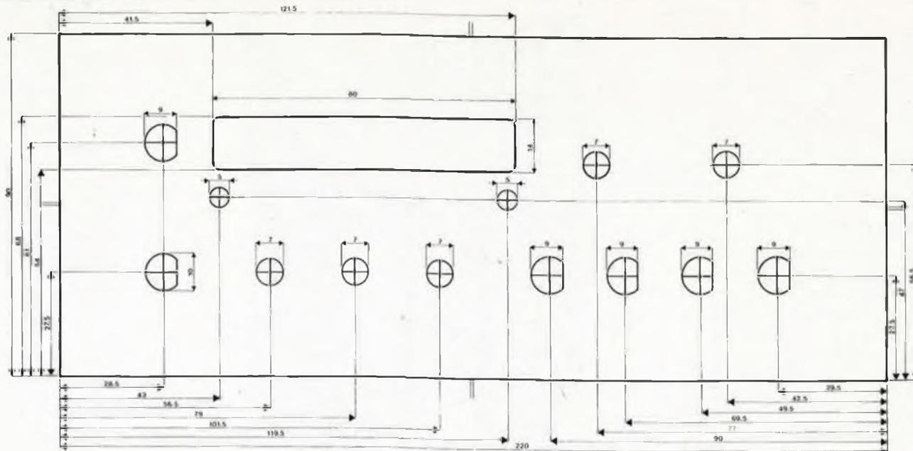
**Figure 4. Gabarit de perçage pour la face avant du fréquencesmètre. Attention, étant données ses dimensions, nous ne pouvons pas vous le proposer à l'échelle 1.**
