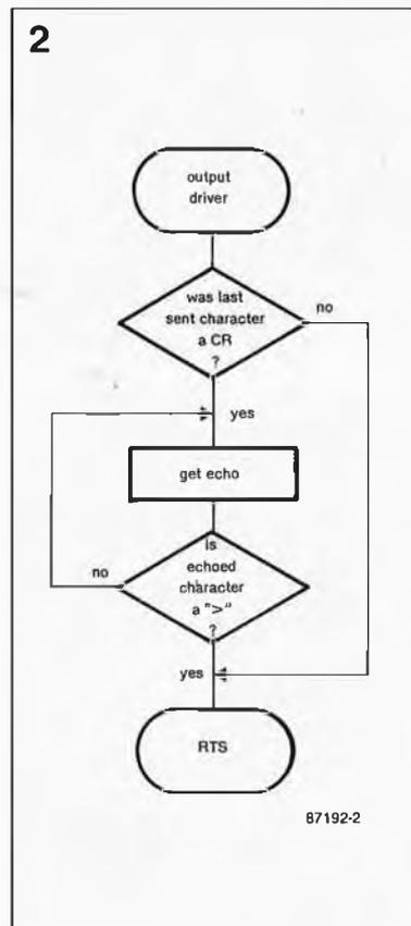
Figure 2. Ordino-gramme d'une routine de filtrage des CR; lorsqu'un fichier est envoyé d'une seule traite à SCALP par un terminal, il faut attendre l'arrivée d'un caractère d'acquiescement après chaque CR.
