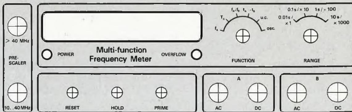
**Figure 2. Représentation de la face avant en film plastique autocollant conçue à l'intention du fréquence-mètre multifonction. Si l'on ne prévoit pas l'adjonction du prédiviseur de fréquence d'entrée, on pourra supprimer les deux entrées prescaler.**
