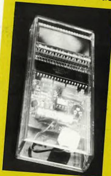
A partir d'un prototype original issu du laboratoire SELECTRONIC et repensé par ELEKTOR, nous vous proposons ce thermomètre de précision qui fera date, puisqu'il fonctionne... sans pile ! La précision est de 0,1° C.
