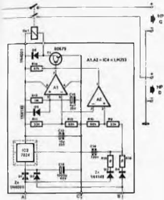
Si l'on prévoit d'implanter cet amplificateur dans "the preamp", il est relativement facile d'ajouter un relais supplémentaire monté en parallèle sur le relais Line-out commandé simultanément que celui-ci.
