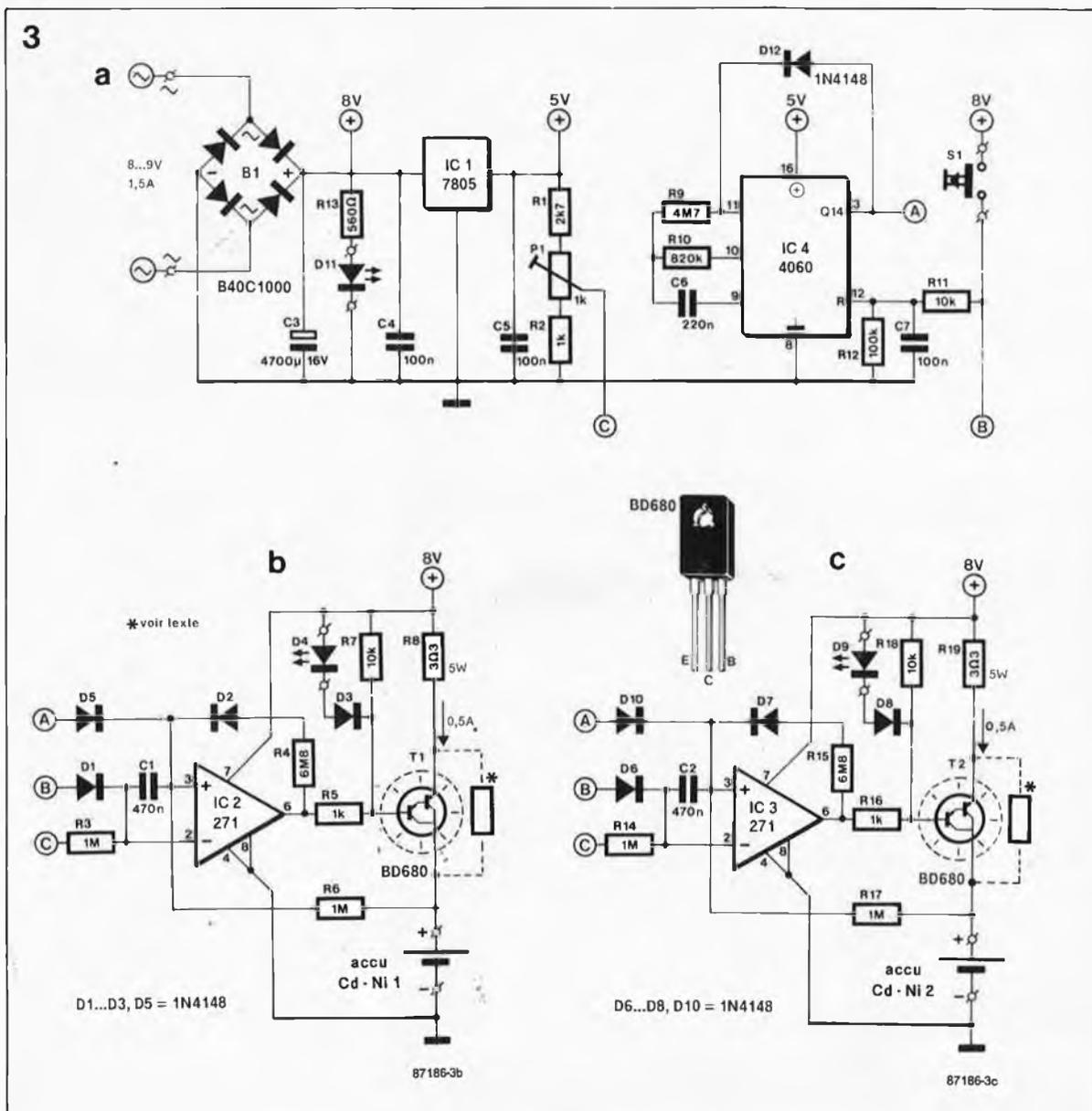
Figure 3. Schéma du chargeur ultra-rapide. L'alimentation et le temporisateur de la figure 3a ne sont construits qu'en un seul exemplaire, mais la source de tension et le dispositif d'interruption de la charge sont doubles (figures 3b et 3c).
