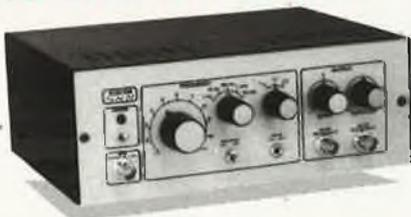
1 Hz à 110 KHz en 5 Gammes. SIGNAUX : Carré triangle sinus. Distorsion sinus inf. à 0.5%
