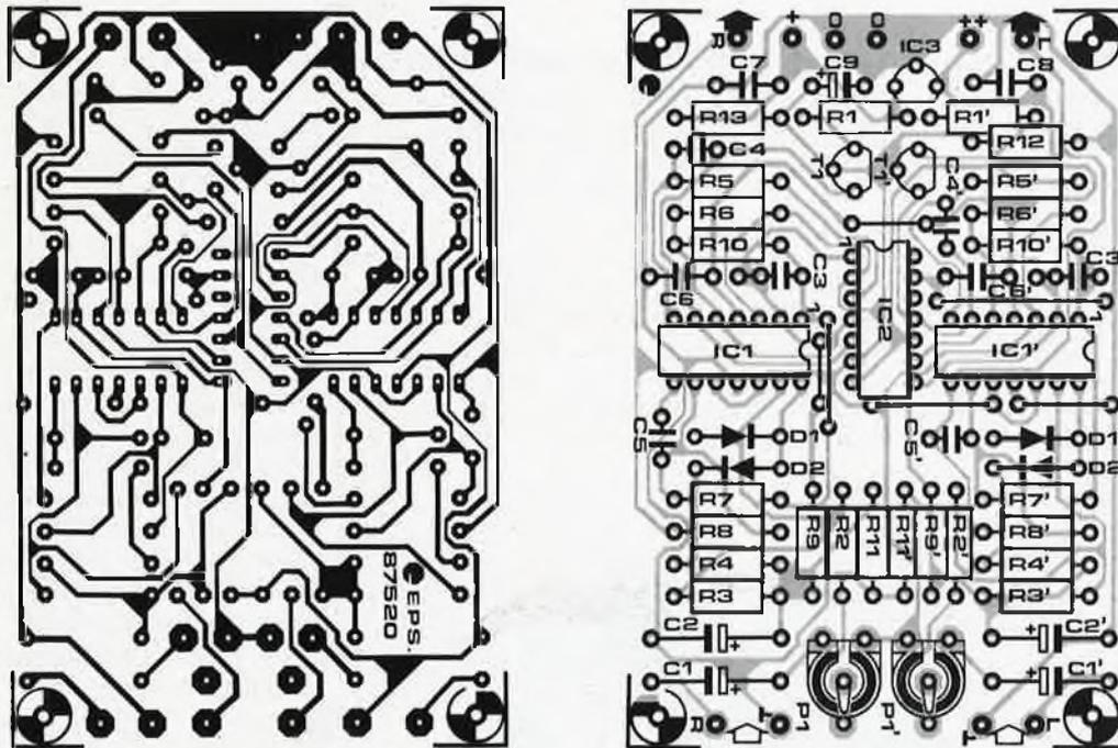
Figure 9. Représentation de la sérigraphie de l'implantation des composants de la platine de l'amplificateur logarithmique sur lequel se trouvent les deux potentiomètres ajustables servant au réglage de la sensibilité.
