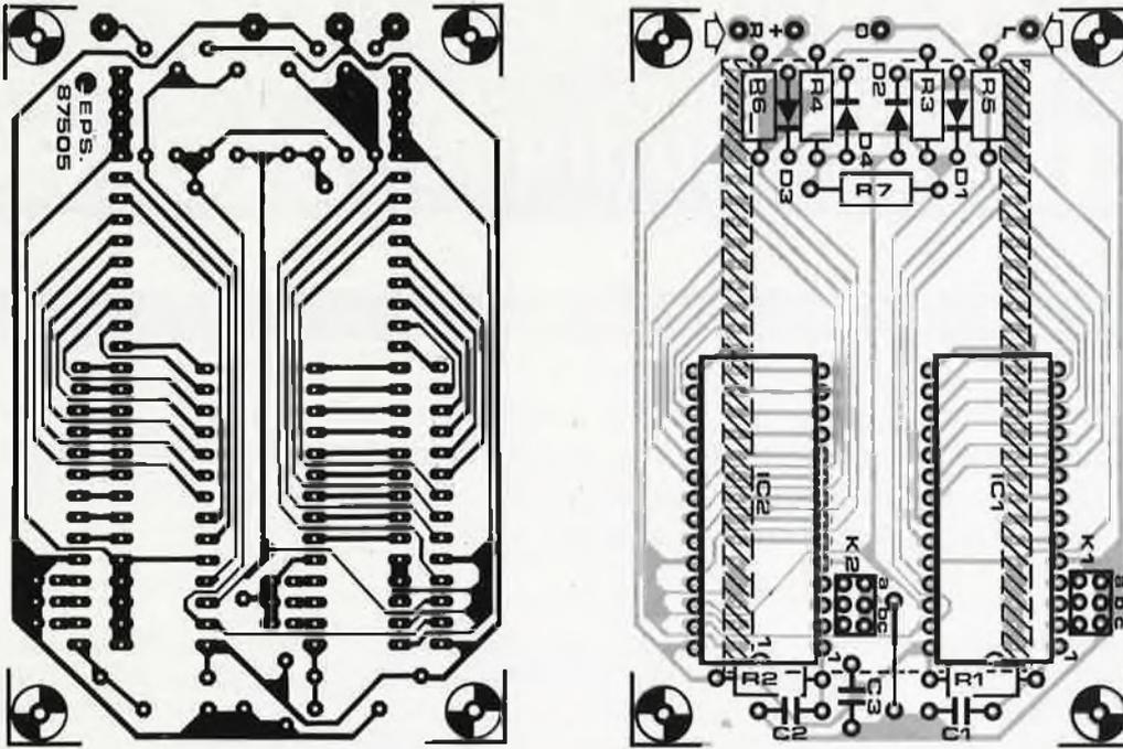
Figure 8. Représentation de la sérigraphie de l'implantation des composants de la platine de l'afficheur LCD. Le LCD lui-même sera implanté (pas soudé) côté pistes du circuit imprimé.
