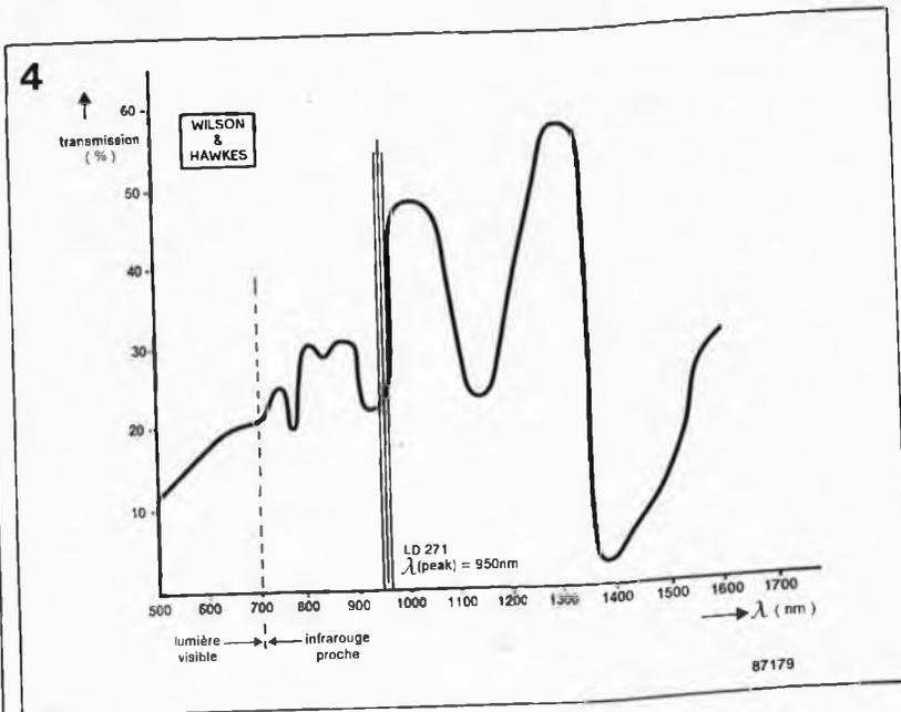
Figure 4. Corrélation entre la longueur d'onde et le pourcentage de la transmission à travers 1 km d'atmosphère au niveau de la mer (source Wilson/Hawkes).
