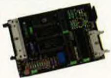
Le SCALP (Système de Conception Assisté par un Langage Populaire) est un remarquable outil de développement programmable en BASIC et conçu spécialement comme outil de saisie de données, de test d'instrumentation et de commande de processus. Avec, en plus, de très puissantes fonctions d'entrées-sorties
