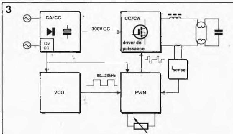
**Figure 4. Amorçage électronique: la fréquence évolue de 80 à 30 kHz. A proximité de la fréquence de résonance (50 kHz) le tube s'allume.**
