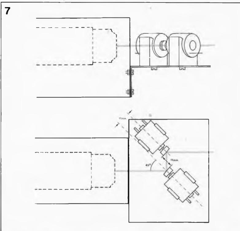
Figure 7 : Voici comment disposer les deux moteurs sur leur équerre métallique à l'avant du boîtier dans lequel se trouve le tube laser. Le socle est pré-percé et les deux étriers sont munis d'une perforation longiligne, ce qui permet d'en régler la position avec toute la précision souhaitée.
