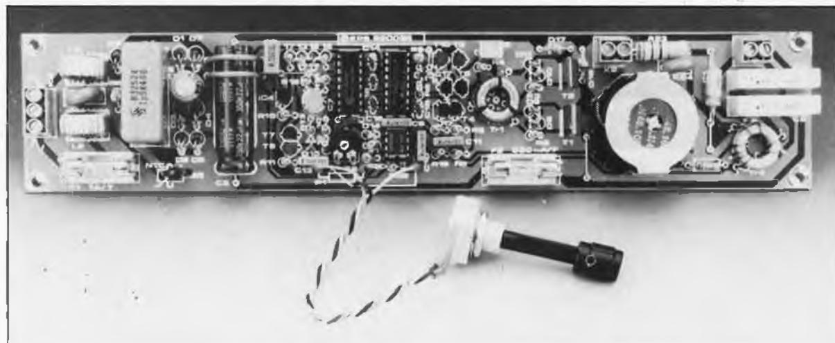
Notre montage permet la commande d'un tube luminescent (TL) à une fréquence relativement élevée (30 kHz); cette approche présente un double avantage: une augmentation du rendement (déjà élevé) de ces tubes, économiques s'il en est, et une possibilité de gradation impeccable de ce type de luminaire réputé si difficile à commander.
