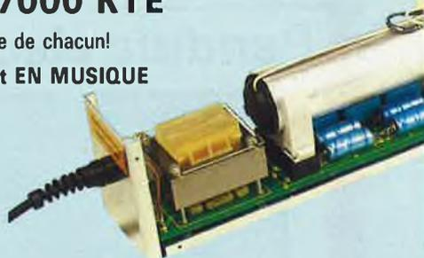
**Alimentation de puissance pour pilote LASER PL-7000**
