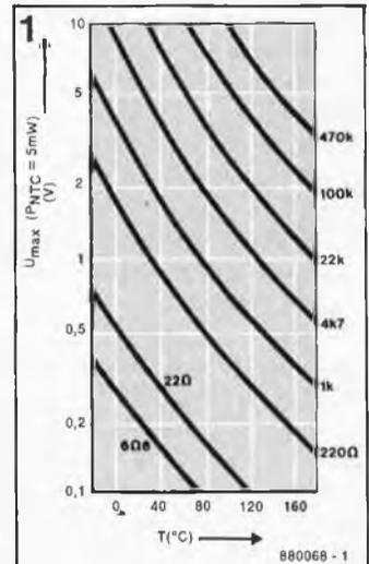
Figure 1. Ces courbes nous apprennent que pour garder constante la puissance dissipée dans une NTC, il faut diminuer la tension au fur et à mesure de l'augmentation de la température de ce composant.
