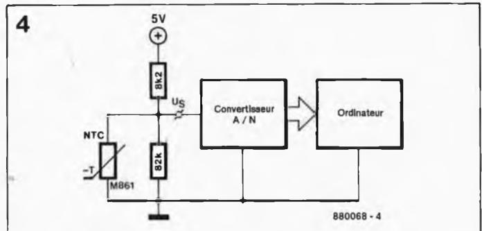
Figure 4. Principe de la mesure informatisée de la température à l'aide d'une NTC.
