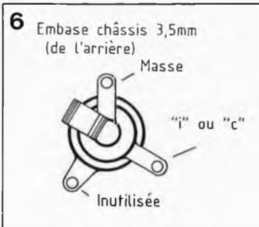
Figure 6 : Brochage des fiches jack châssis (moteurs).
