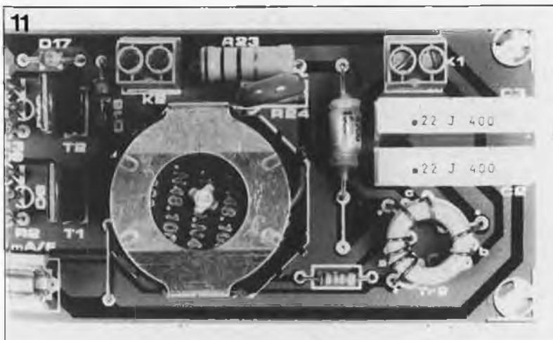
**Figure 11.** Vue plongeante sur le transformateur de mesure du courant.
