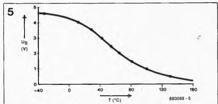
Figure 5. Le signal de sortie  $U_S$  du réseau à NTC de la figure 4.
