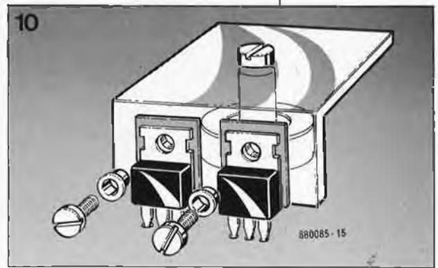
**Figure 10.** Avec des tubes de puissance supérieure à 30 W il faut doter les transistors T1 et T2 d'un radiateur, une équerre en aluminium par exemple. Utiliser des plaquettes de céramique pour l'isolation.
