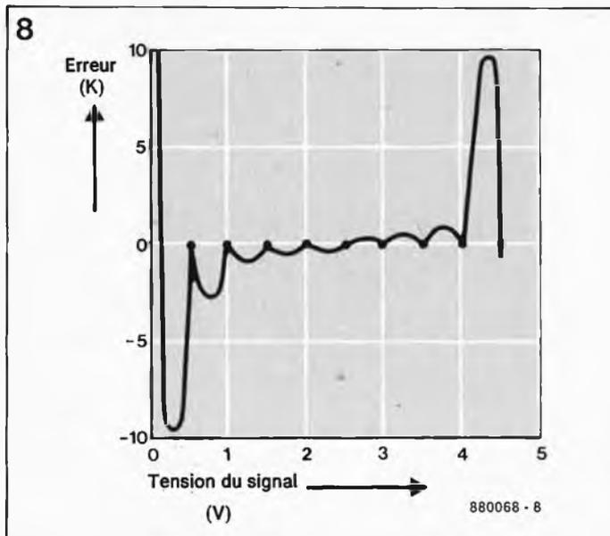
Figure 8. Comparaison de la précision obtenue par l'interpolation du tableau 1 et de la courbe réelle (figure 5).
