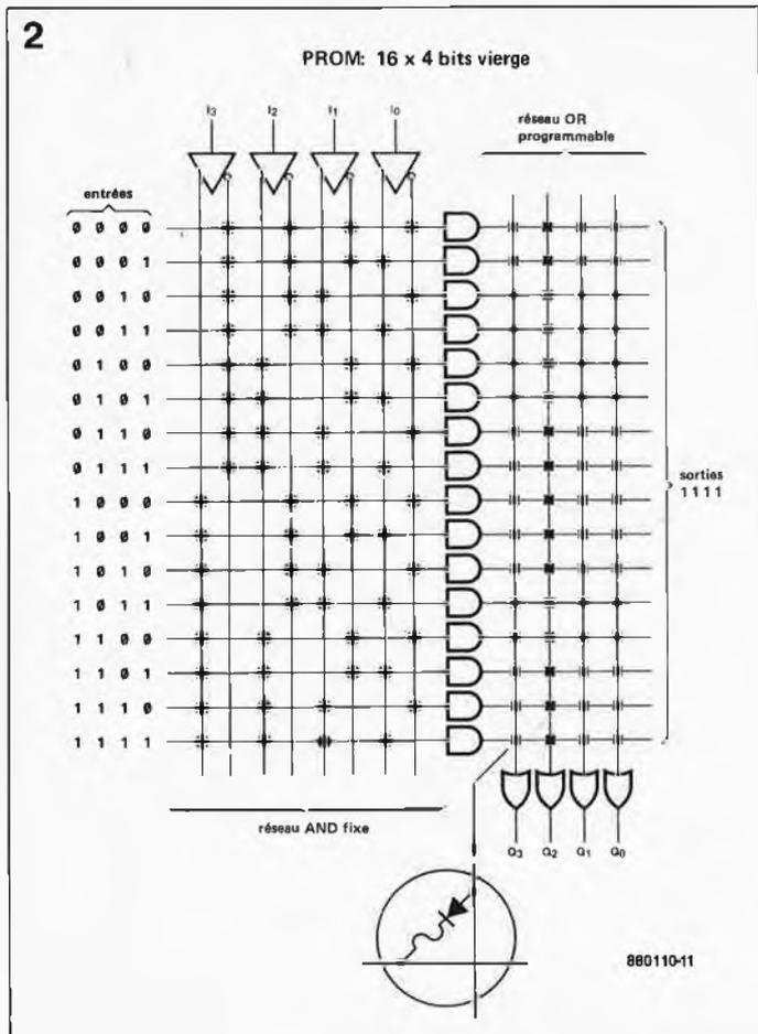
Figure 2. La structure d'une PROM. Le réseau AND non programmable sert en fait de décodage d'adresses.
