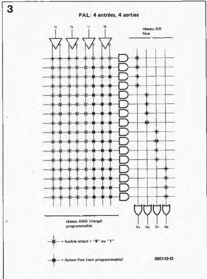
Figure 3. Grâce à son réseau AND programmable, une PAL est plus flexible que la PROM.
