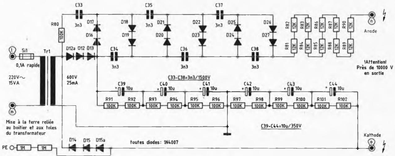
Figure 1 : Schéma de l'alimentation pour laser.
