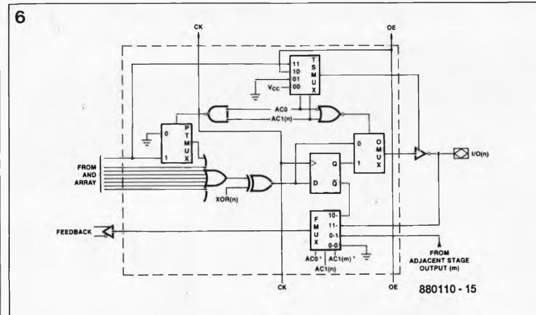
Figure 6. Détail d'une macrocellule logique de sortie.
