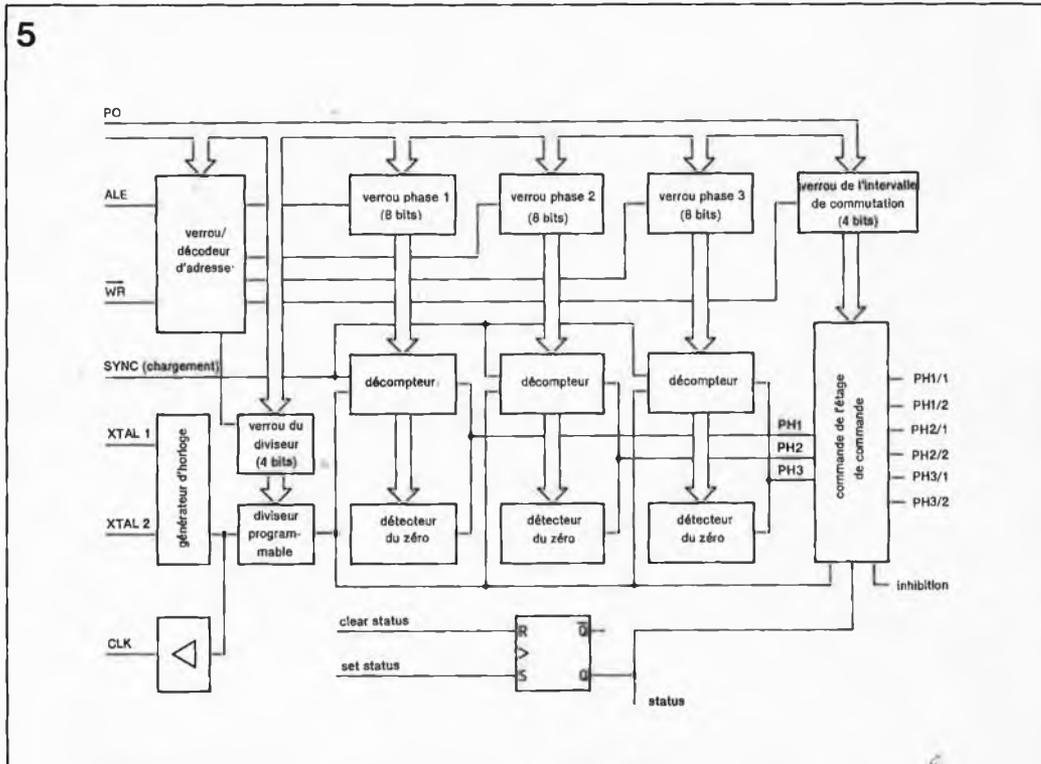
Figure 5. Synoptique de la structure interne du SLE4520.
