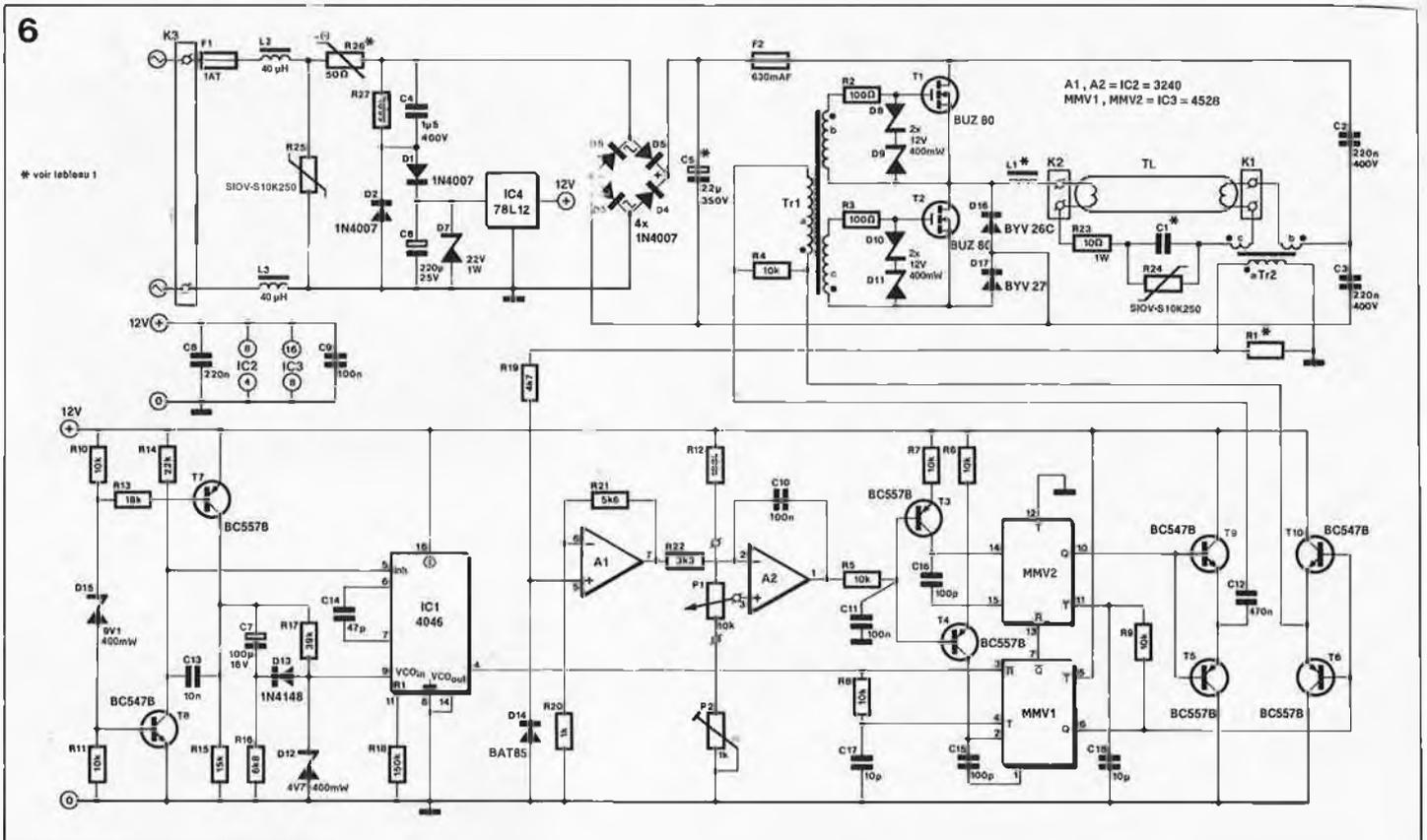
**Figure 6. L'électronique du gradateur HF pour TL.**
