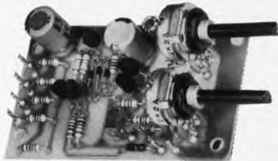
La copie de bandes vidéo entraîne une dégradation des signaux nettement perceptible. L'amplificateur-correcteur vidéo, avec ses quatre sorties parallèles, étend la plage de modulation et augmente ainsi le contraste des images copiées.
