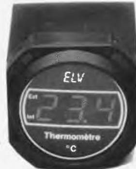
Kit complet du thermomètre en boîtier non encastrable
