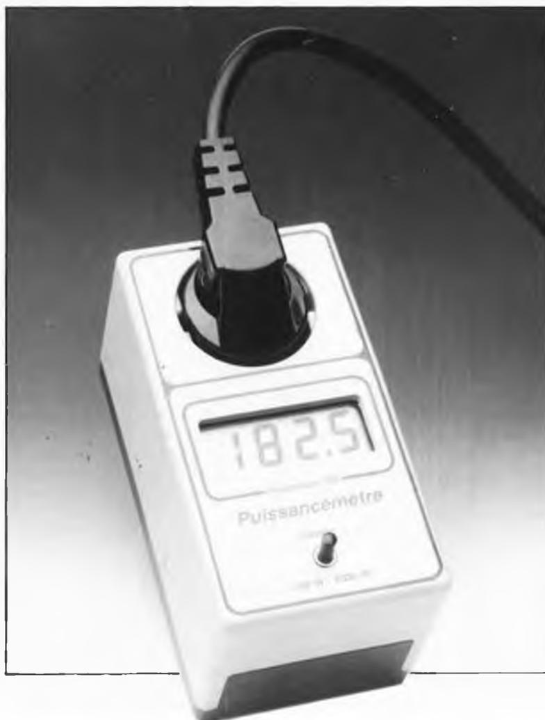
PNC 2000. Dès la mise sous tension de la charge, la puissance wattée consommée par l'appareil concerné s'affiche sur l'affichage à cristaux liquides. Le puissance-mètre tient automatiquement compte de l'angle de phase et de la distorsion de forme de courbe; dans ces conditions, la valeur affichée est exacte à 0,5 % près (valeur typique).
