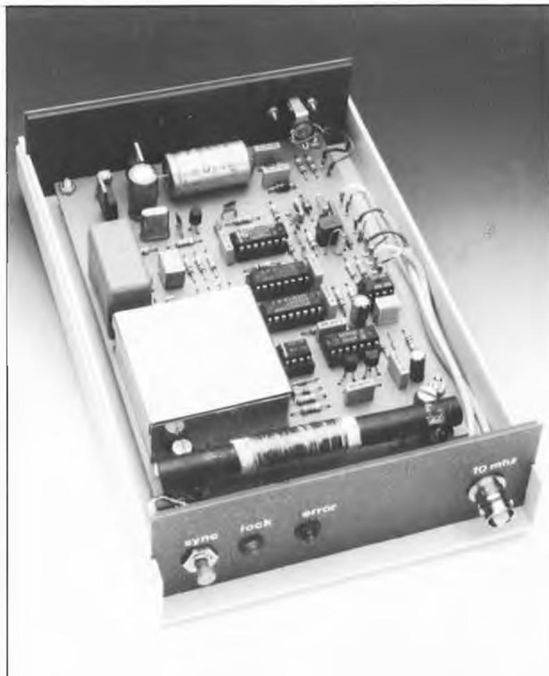
elles utilisent une horloge atomique propre (précision:  $5 \times 10^{-12}$ ), durant le jour celle des Postes de la RFA (précision:  $5 \times 10^{-13}$ ). On peut de ce fait faire appel à l'un ou l'autre émetteur comme générateur de fréquence-étalon d'une base de temps. Il faut cependant tenir compte du fait que le signal émis par ces stations d'émission est modulé.
