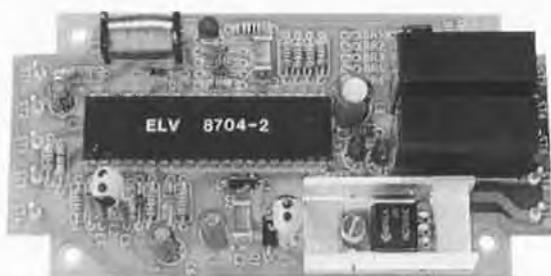
Un cadenceur pour essuie-glace a été réalisé grâce à un seul microprocesseur, qui réunit fiabilité, serviabilité et une commande cadencée semi-automatique.
