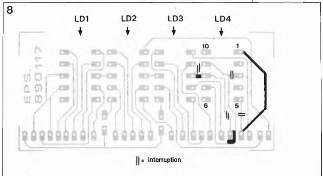
LD4 additionnel doit être recouverte légèrement afin que le signe moins (-) apparaisse nettement (qu'il soit bien distinct du "1" formé par les segments b et c).
