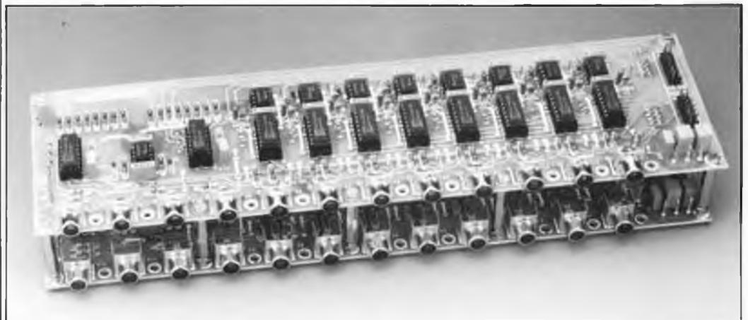
d'interrupteur à bascule. Des essais pratiques mesurés ont confirmé les excellentes valeurs théoriques que nous laissons espérer cette solution. La distorsion tombait à une valeur non mesurable (pour ceux qui ne jurent que par les chiffres, inférieure à 0,003%). La diaphonie entre les canaux était encore meilleure qu'avec notre fameux "THE PREAMP", à relais, lui, et où pourtant nous avions fait de notre mieux pour arriver aux résultats les meilleurs. La technologie... et les idées évoluent.
