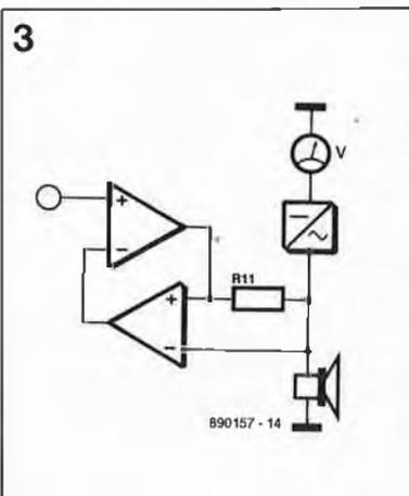
Figure 3. Schéma synoptique de l'impédancemètre.
