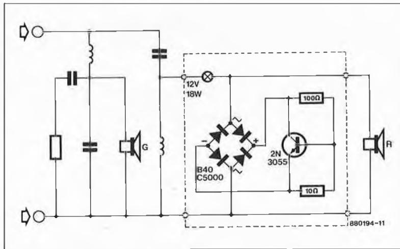
**Figure 1.** Schéma d'un dispositif de protection de haut-parleur d'aigus. Une augmentation de la puissance fait croître la résistance de l'ampoule. Le 2N3055 court-circuite alors le tweeter lors de crêtes de puissance importantes. Ce circuit convient à tout haut-parleur d'aigus ayant une fréquence de séparation égale ou supérieure à 5 kHz.
