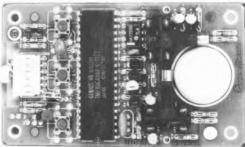
Figure 4. Une souris sériele, équipée d'un micro-contrôleur, utilise le port RS232 de l'ordinateur de façon quasi-"illégitime" pour en tirer sa tension d'alimentation. En raison de la très faible consommation du micro-contrôleur, cette façon de faire n'aura cependant pas de conséquence néfaste pour l'interface sériele.
