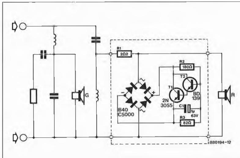
**Figure 2.** Version améliorée du circuit de la figure 1. Il est possible d'adapter à son goût la temporisation d'entrée en fonction et la constante de temps du circuit. La distorsion qu'entraîne ce circuit reste acceptable.
