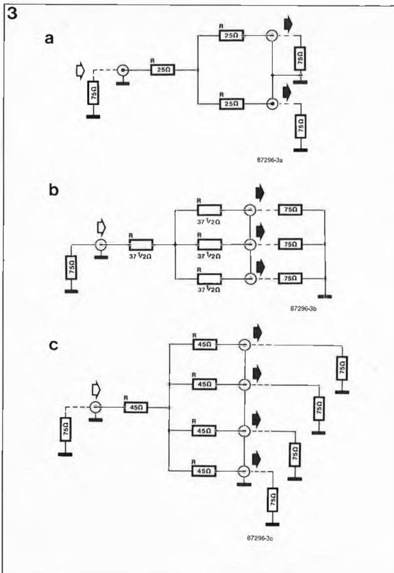
Tout en effectuant une adaptation correcte des sorties à l'entrée, ce diviseur d'antenne présente un autre avantage: il permet une combinaison de plusieurs diviseurs. On peut ainsi économiser du câble coaxial si l'on ne veut pas effectuer une distribution en étoile (à un unique point de distribution central). Il a cependant un inconvénient: son utilisateur risque de se trouver confronté à des niveaux de signal différents.
