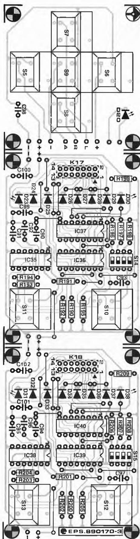
Figure 7. Le circuit imprimé du circuit de commande dont on voit ici la sérigraphie de l'implantation des composants se compose de trois sous-platines qu'il faudra séparer l'une de l'autre avant de procéder à l'implantation des composants.
