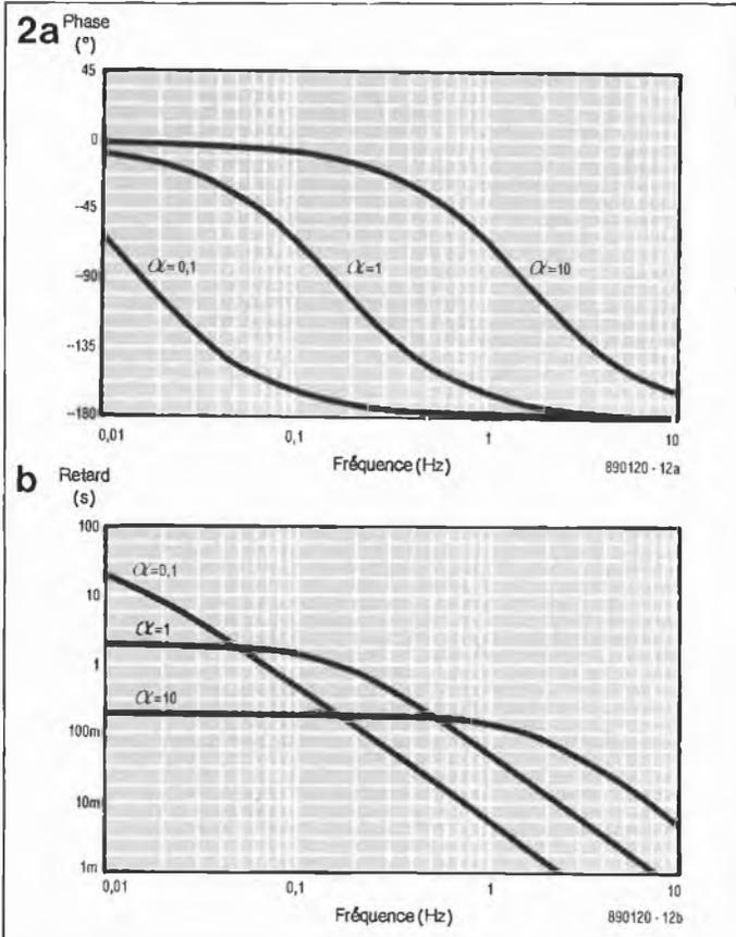
Figure 2. Le retard introduit par un réseau du premier ordre à un facteur  $\alpha$  de 0,1, 1 et 10. La figure a donne le déphasage, la figure b le retard.
