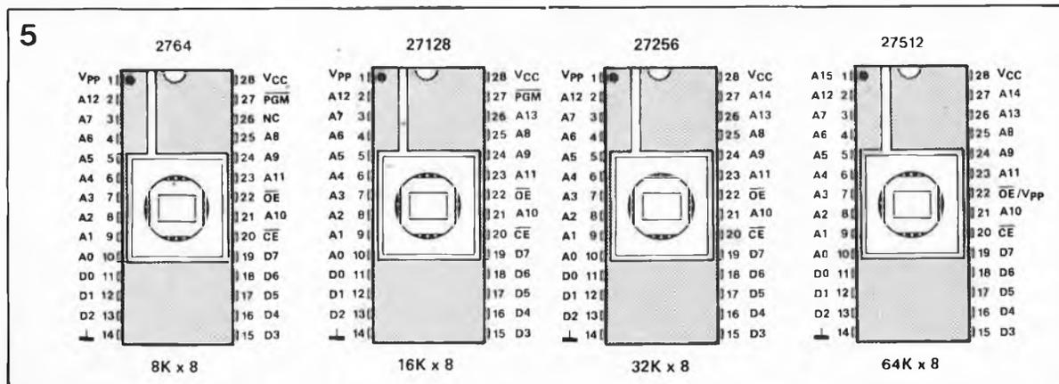
Figure 5. Brochage des différents types d'EPROM auxquelles notre simulateur d'EPROM peut se substituer, le temps de quelques essais avant que ceux-ci ne deviennent un "coup de maître".
