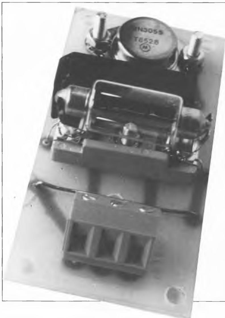
L'ampoule se met à briller lorsque la puissance atteint une valeur donnée; lorsque la tension à ses bornes chute de quelque 5,5 V, l'ampoule "grille" l'excédent de puissance appliqué au haut-parleur d'aigus et limite ainsi le niveau du signal. Simultanément le transistor devient conducteur et court-circuite de ce fait le haut-parleur d'aigus.
