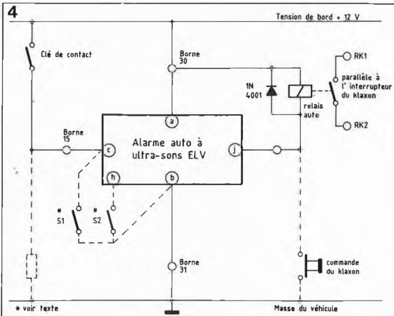
Figure 4. Plan de câblage de l'alarme auto à ultrasons.
