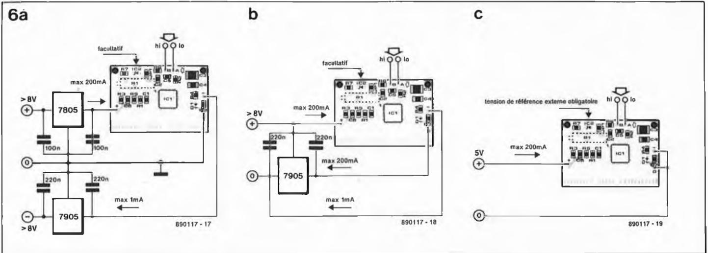
table multitour P1 en fixant à 100 mV le niveau de la tension présente entre REF-LO et REF-HI, sachant que la tension de référence est égale à la moitié de la gamme à pleine échelle. Des ajustements mineurs de la sensibilité peuvent être obtenus par modification de la position de P1.
