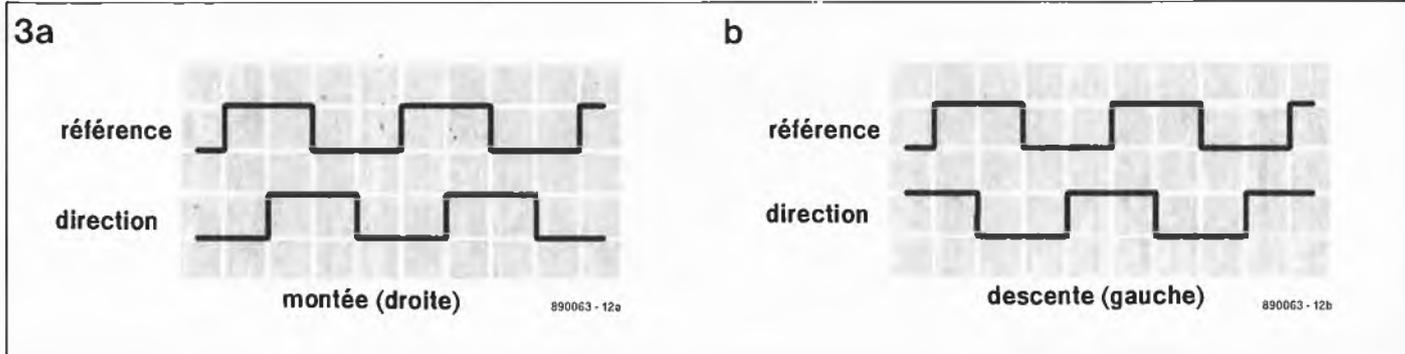
Figure 3. Le déphasage de  $+90^\circ$  (a) ou de  $-90^\circ$  (b) que, selon le cas, présentent les signaux de "référence" et de "direction", est fonction du sens de déplacement de la souris.
