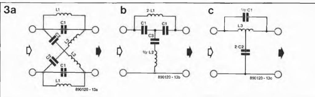
Figure 3. Schéma d'un réseau en échelle du second ordre (a), d'un réseau non balancé pour un facteur  $Q > 1$  (b) et pour un facteur  $Q < 1$  (c).
