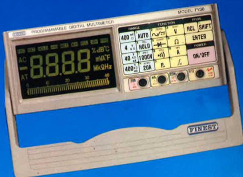
**Spécifications :** 4000 points - Précision 0,2 % DC. Affichage LCD géant 95x54 mm, caractères 23 mm. Bar-graph 41 segments avec échantil. 20 cycles/s. Calibre automatique ou manuel. Interface RS 232. Calibre 20 A. Fonctions mathématiques Min/Max, Rel. Diff. % Comp. Fréquence jusqu'à 40 KHz. Wattmètre (tension x courant). Data hold. Test diode et continuité. Dimensions : 214x83x269 mm. Alimentation : 220V.
