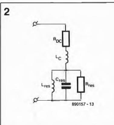
Figure 2. Ce schéma électronique équivaut d'un haut-parleur montre qu'un nombre plus important d'éléments qu'il n'y paraît au premier coup d'oeil entrent en ligne de compte: impédance, capacité et résistance s'allient pour compliquer les choses.
