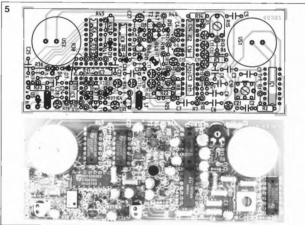
Figure 5. Représentation de la sérigraphie de l'implantation des composants de la platine dessinée pour l'alarme auto à ultrasons. A côté, exemplaire terminé de cette platine.
