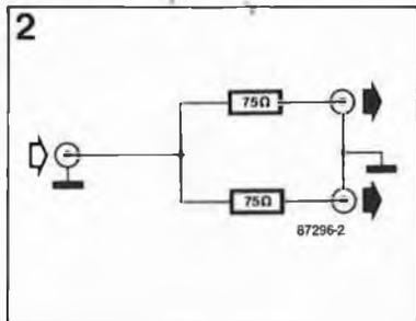
Il faut en outre que le signal d'antenne ait un niveau suffisant pour supporter sans conséquence néfaste une telle division. La tension d'entrée est effet divisée par deux à tout noeud de distribution ainsi réalisé. Ce second problème peut être résolu simplement par la mise en oeuvre d'un amplificateur d'antenne à large bande connecté directement à l'arrivée de la prise d'antenne ou au point d'entrée dans l'habitation de la liaison par câble.
