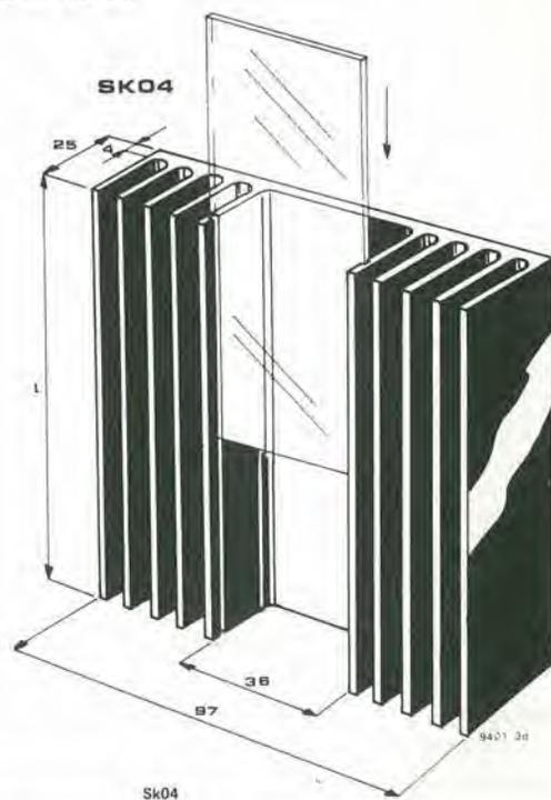
tore montato verticalmente, è 75 mm, quella da preferire 100 mm, se il contenitore può comprenderla. In alternativa, i transistori possono avere ciascuno il proprio radiatore, da 50 ... 75 mm.
