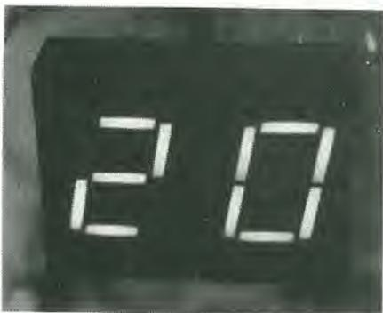
l'acqua calda a 82°F, la temperatura differisce di 50°F. Se l'indicazione nell'acqua ghiacciata, è per dire, "45°F", P1 deve essere regolato sino a che la lettura nell'acqua calda è di "75°F".
