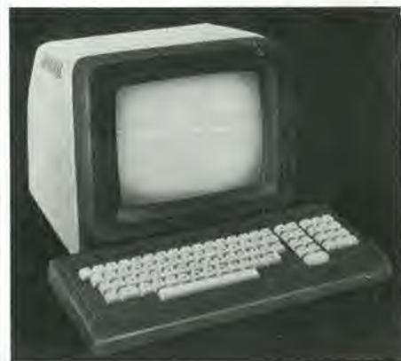
Il terminale video della serie MDL si basa su un microprocessore: ha molte pagine di memoria, le possibilità di editing su tutto lo schermo e di block mode, indirizzamento della posizione di lettura e di scrittura del cursore, più altri dispositivi destinati ad essere utilizzati con gli altri sistemi commerciali. Infine c'è il terminale APL-100, caratterizzato dalla superposizione dei caratteri APL, dai modi ASCII/APL perfezionati con editing dei dati sullo schermo e capacità di block mode.
