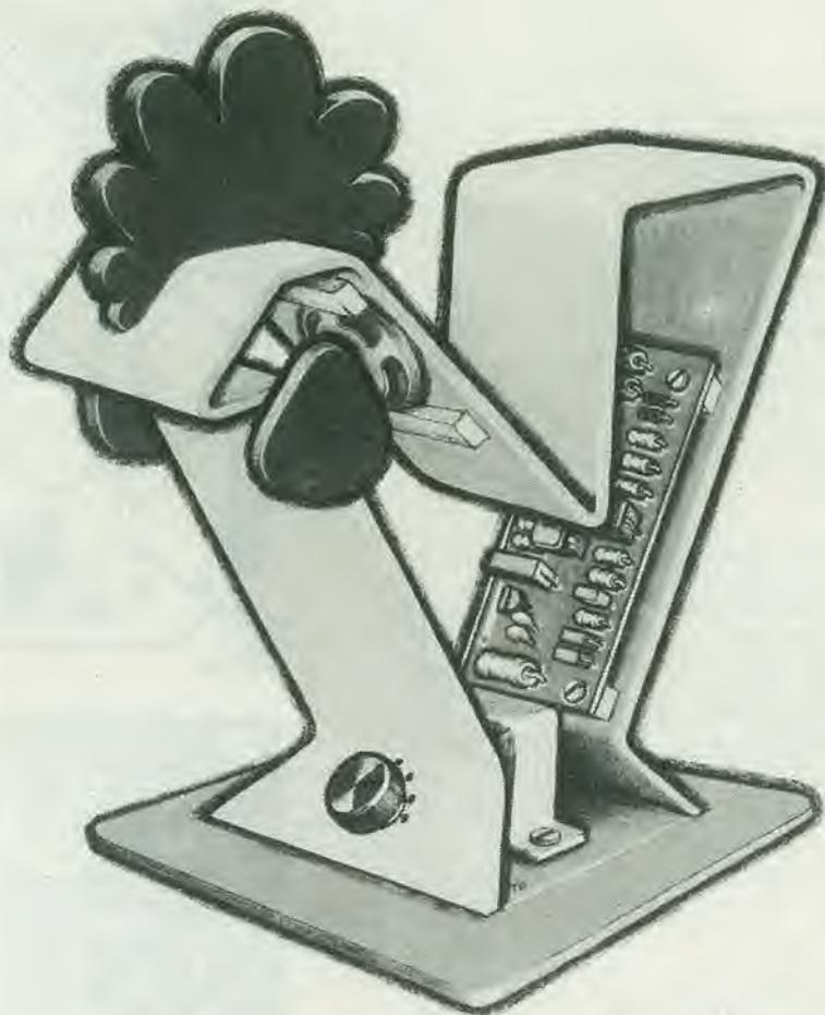
La procedura di allineamento riguarda la regolazione di soltanto due trimmer. P1 viene aggiustato fino ad ottenere la desiderata intensità della "voce" del contaminuti. P2 determina invece il periodo di oscillazione del generatore di clock del circuito temporizzatore.
