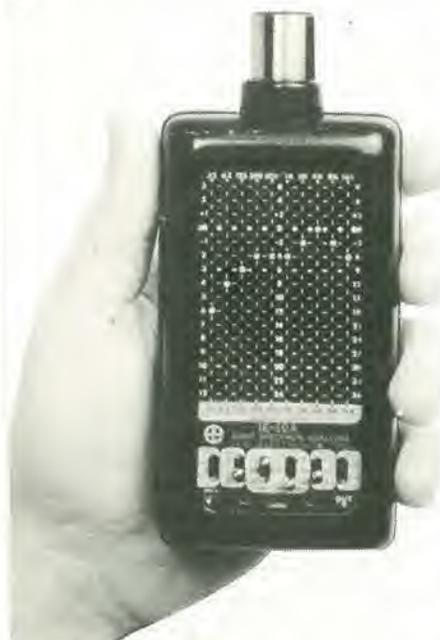
Figura 2. Fotografia di un analizzatore di spettro in tempo reale, di tipo commerciale e tascabile. Il display incorporato è a matrice di LED.
