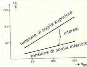
I trigger di Schmitt servono alla messa in forma degli impulsi cioè trasformano un segnale di entrata che si evolve lentamente, in un segnale di uscita dai fianchi ripidi che servono per pilotare dei circuiti CMOS normali.
