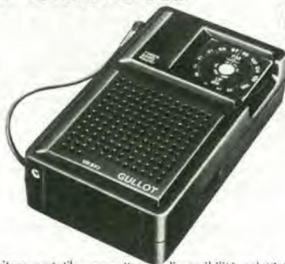
Radioricevitore portatile compatto per l'ascolto delle onde lunghe e medie e della modulazione di frequenza. Ottime le prestazioni
