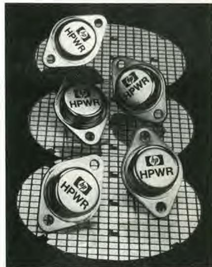
I dispositivi HPWR 6501 - 6502 - 6503 e 6504 sono caratterizzati da valori di  $V_{oss}$  (min) e  $R_{(on)(max)}$  di 450V - 0,85  $\Omega$ , 400V - 0,75  $\Omega$ , 450V - 1,00  $\Omega$  e 400V - 1,00  $\Omega$  rispettivamente.
