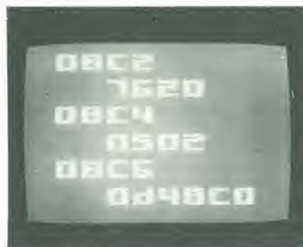
Si deve osservare che questo programma è locato nelle posizioni da 08C0 a 08F6 e da 1F80 ad 1FAD. C'è voluta un pò di abilità ad inserire queste due sezioni separate di programma come unico file nel nastro!
