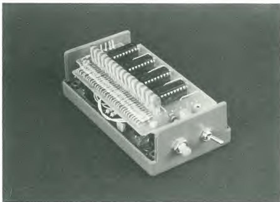
sulla basetta. In questo modo si facilita il rilievo del "salto" della luce....La basetta è predisposta per accogliere dei LED rettangolari, ma se ne possono usare anche di altre forme, basta che la loro larghezza non superi i 2,54 mm. La scheda di processo è fatta con un rettangolo di cartoncino bianco. Una volta sistemate le divisioni della scala, queste possono essere protette con un nastro "scotch".
