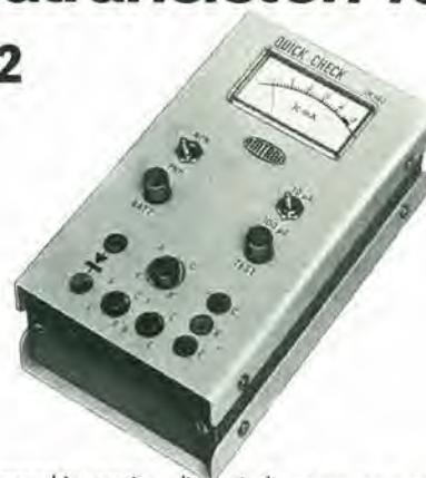
Un apparecchio pratico, di facile uso, leggero, portatile. Misura il beta dei transistori NPN e PNP, e fornisce una chiara indicazione della funzionalità di transistori e diodi pur senza necessitare di complicate procedure di misura o di calcoli. Indispensabile nella borsa e nel laboratorio del tecnico, dello studioso e del dilettante.
