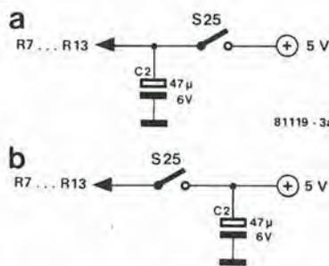
Figura 3. Quando il terminale positivo di C2 viene spostato in un altro punto della bassetta, l'accensione e lo spegnimento del display non provocheranno perdite nel contenuto della memoria.
