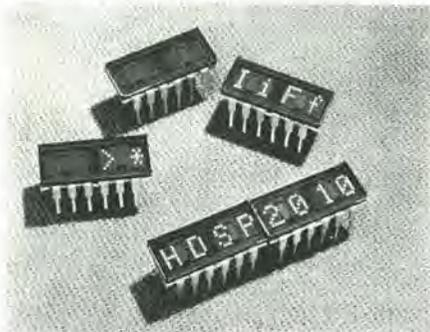
L'HDSP-2010 ed il TVX-2010 derivano direttamente dall'HDSP-2000 della Hewlett-Packard, un componente alfanumerico a matrice di punti 5 e 7, in produzione dal 1976, caratterizzato da estrema compattezza ed efficienza. I registri di scorrimento ed i driver a corrente costanti integrati sono inoltre caratteristici della famiglia HDSP-2000 e consentono una notevole semplificazione dello sforzo di progetto.
