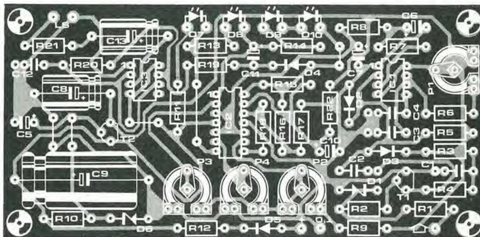
Figura 6. La disposizione dei componenti sulla basetta stampata.
