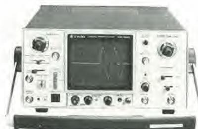
Inoltre l'oscilloscopio ha una memoria protetta con batterie al Ni-Cad e il selettore del ritardo (pre-trigger) separato per la memoria.
