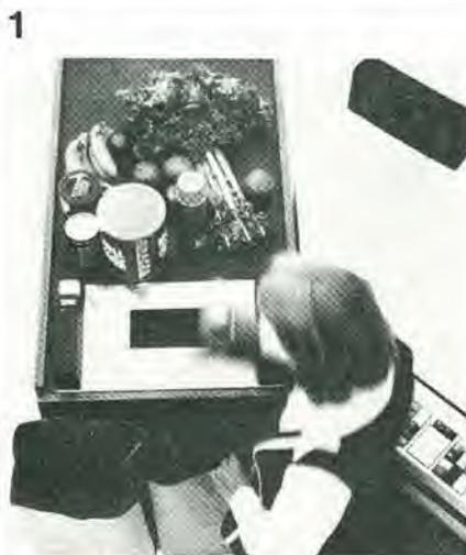
**Figura 1.** L'analizzatore di controllo IBM 3687 è un gruppo compatto che può essere facilmente inserito tra le attrezzature di cassa dei punti di vendita. La semplicità dell'apparecchio ne permette l'installazione da parte di personale non specializzato, ed elimina la necessità di messe a punto periodiche.
