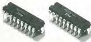
DIP plastico a 18 pin per il range di temperatura industriale, mentre gli HS7541E e HS7541B sono in package DIP ceramico per i ranges di temperatura da -25 a +85°C e da -55 a +125°C rispettivamente. L'HS7541B è soggetto al processing e allo screening secondo le specifiche MIL-STD-883 classe B.
