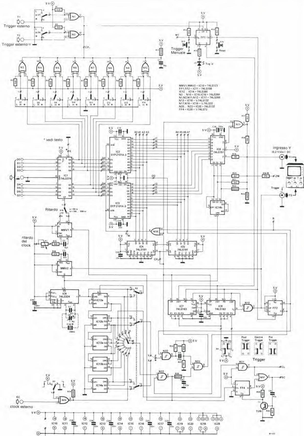
Figura 1. Lo schema elettrico dell'analizzatore logico potrà sembrare alquanto elaborato, ma offre tuttavia molte possibilità interessanti.
