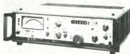
Grazie all'uscita con trasformatore bilanciato con un'impedenza di 600  $\Omega$  disponibile nel generatore tracking incorporato, l'apparecchio può essere impiegato senza problemi di adattamento di impedenza. Il PMG-13 permette di impostare livelli di trasmissione compresi tra -30 e +10 dB a passi di 10 dB. Inoltre con un potenziometro i livelli stessi possono poi essere regolati con continuità. Come misuratore di livello il PMG-13 funziona sia in modo selettivo che a larga banda.
