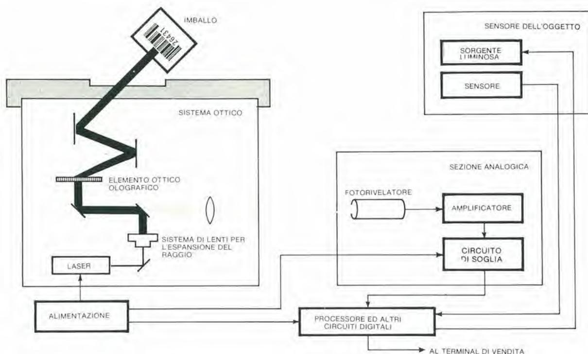
Figura 3. Dentro l'analizzatore di controllo ci sono cinque sottosistemi: il sistema ottico, la sezione analogica, il circuito digitale basato su di un microprocessore, il sensore dell'oggetto e l'analizzatore. Tutto si trova dentro un piccolo mobiletto.
