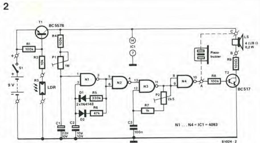
Figura 2. Lo schema elettrico dell'allarme da frigo. Il tempo di "ritardo" può essere cambiato mediante P2. Se si usa un ronzatore piezoelettrico, si dovrà regolare P2 fino ad ottenere la frequenza di risonanza (circa 4,6 kHz). In questo modo il ronzatore (buzzer) avrà la massima resa di volume.
