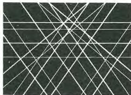
**Figura 2.** Guardando attraverso la finestra dell'analizzatore appaiono queste figure, prodotte dai raggi laser proiettati attraverso ad essa durante una rivoluzione del disco olografico. I raggi escono in così tante direzioni che certamente uno di essi incontrerà il codice a barre del prodotto.
