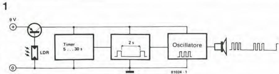
Figura 1. Lo schema a blocchi dell'allarme da frigo.
