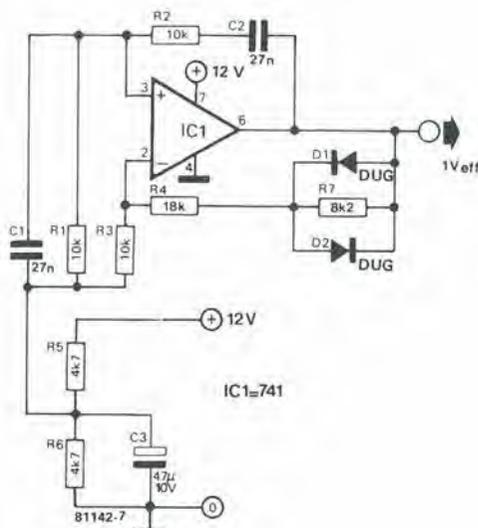
Figura 7. Quei lettori che non possiedono o non dispongono di un generatore sinusoidale, potranno servirsi ottimamente di questo semplicissimo oscillatore di prova.
