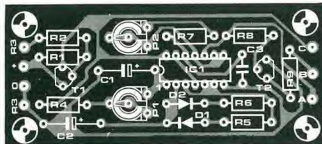
Figura 3. Piste di rame e disposizione dei componenti sulla basetta stampata dell'allarme da frigo.
