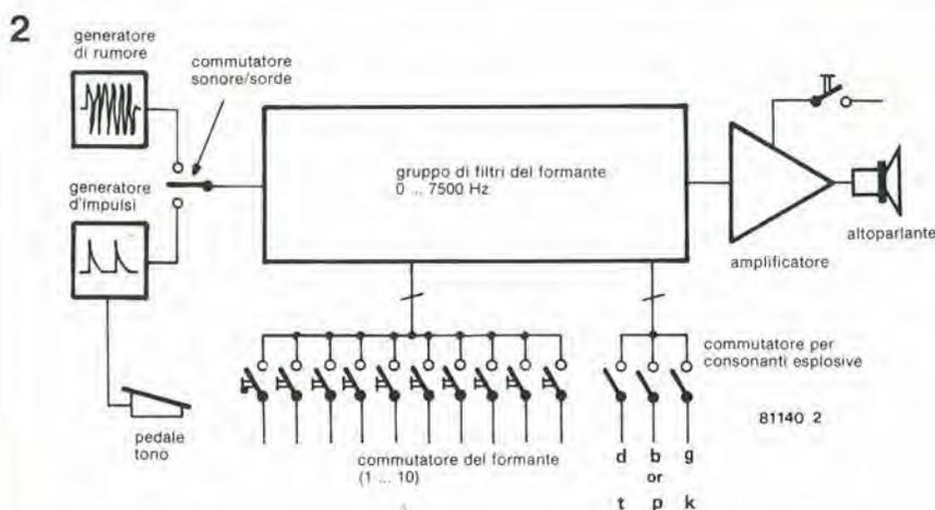
Figura 2. Lo schema a blocchi del veder costruito dai laboratori Bell nel 1939, a cura di Homer Dudley. Questo dispositivo poteva produrre la serie completa dei fonemi, ma doveva essere azionato manualmente, con un risultato che dipendeva molto dall'abilità dell'operatore.
